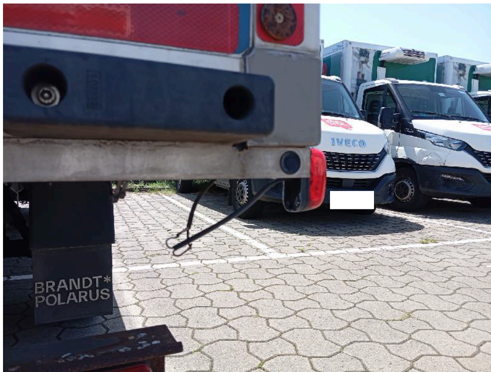
Bild: 31 Elektrik Seitenmarkierungsleuchte lose
