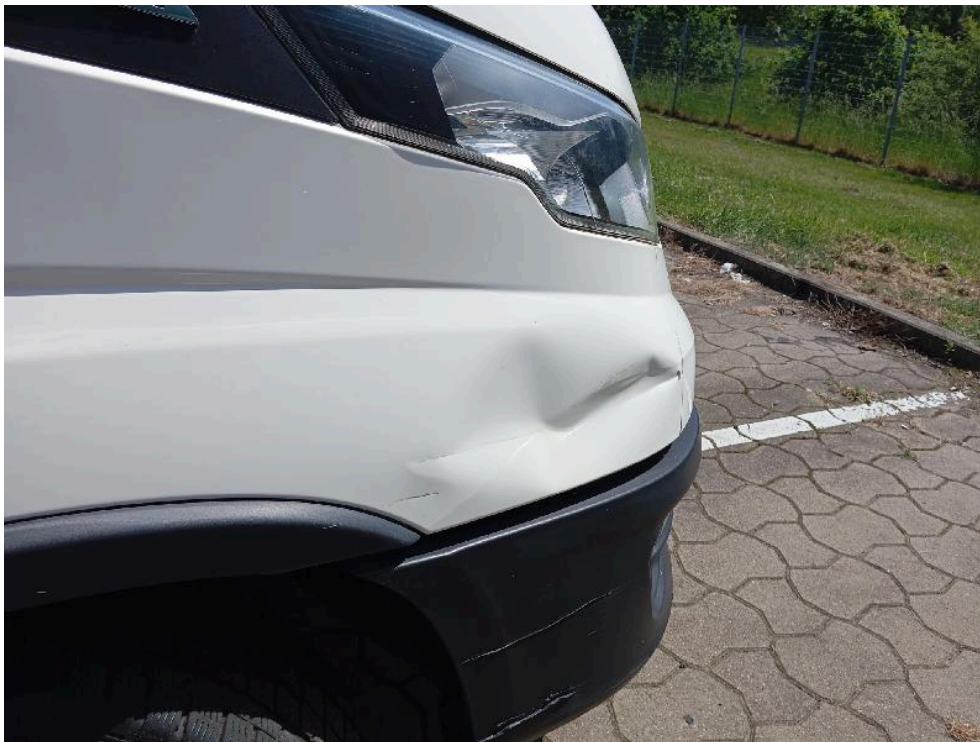
Bild: 47 Kotflügel rechts deformiert
