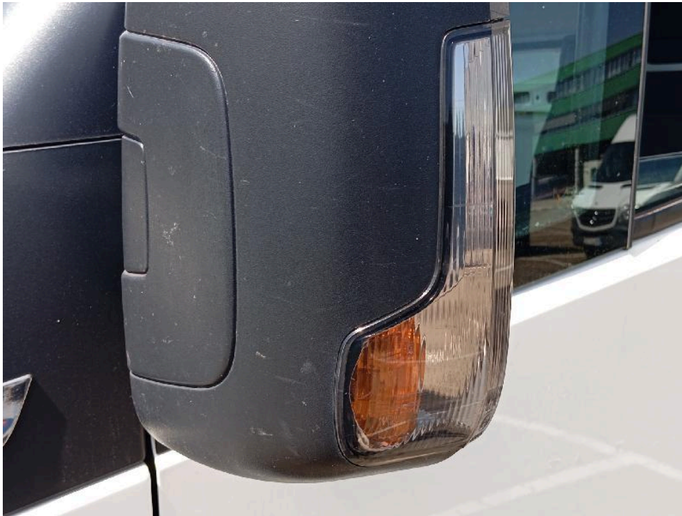
Bild: 25 Außenspiegelkappe links verkratzt/ Blinkerglas gebrochen
