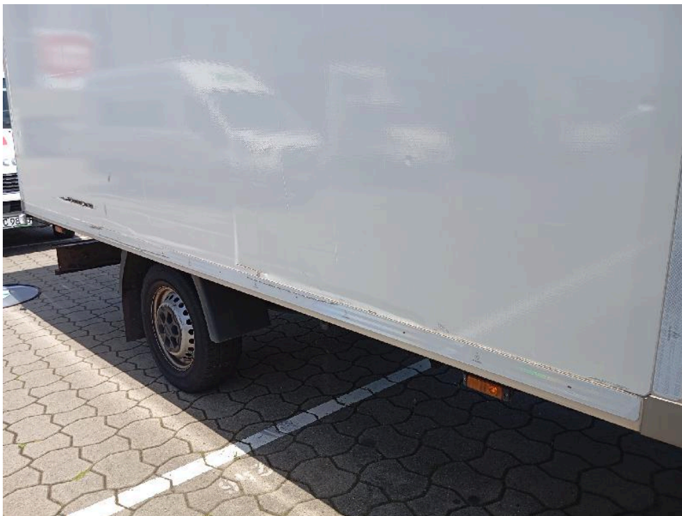
Bild: 38 Kofferseitenwand rechts verschrammt
