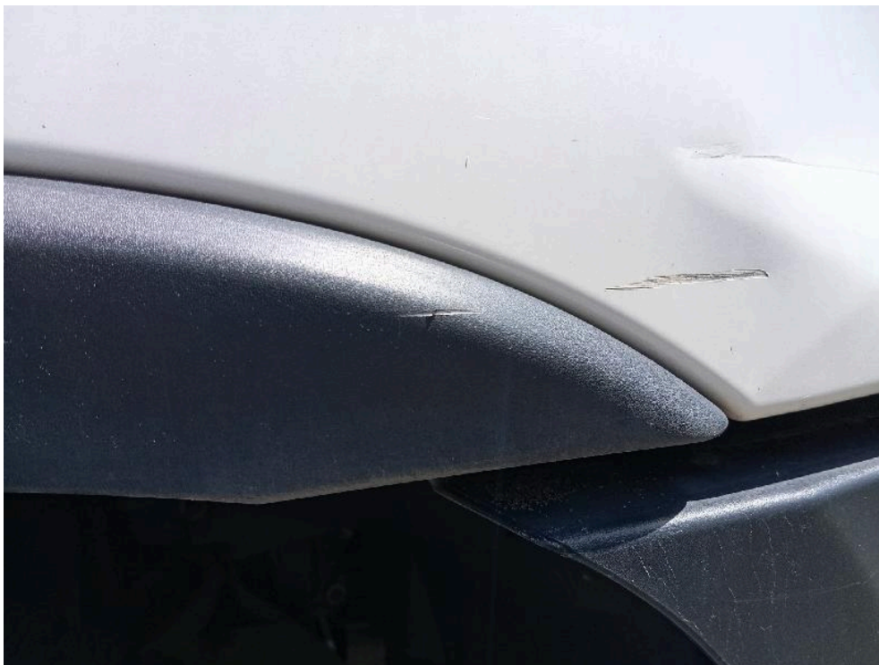
Bild: 42 Radlaufblenden vorn rechts verkratzt/ Kotflügel eingedrückt
