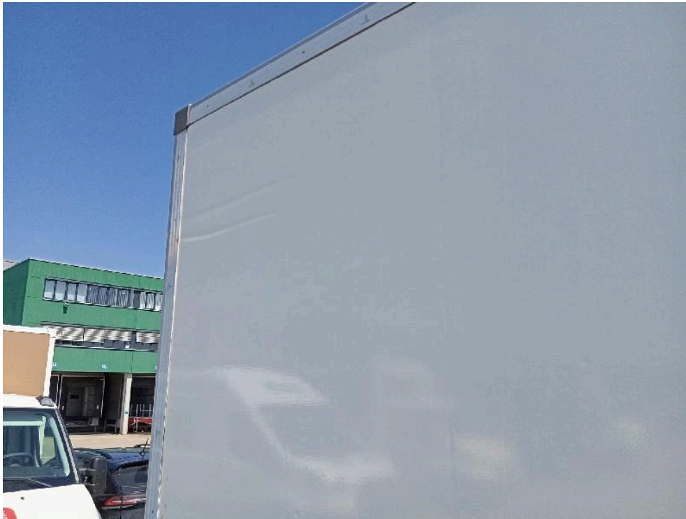
Bild: 39 Kofferseitenwand rechts verschrammt
