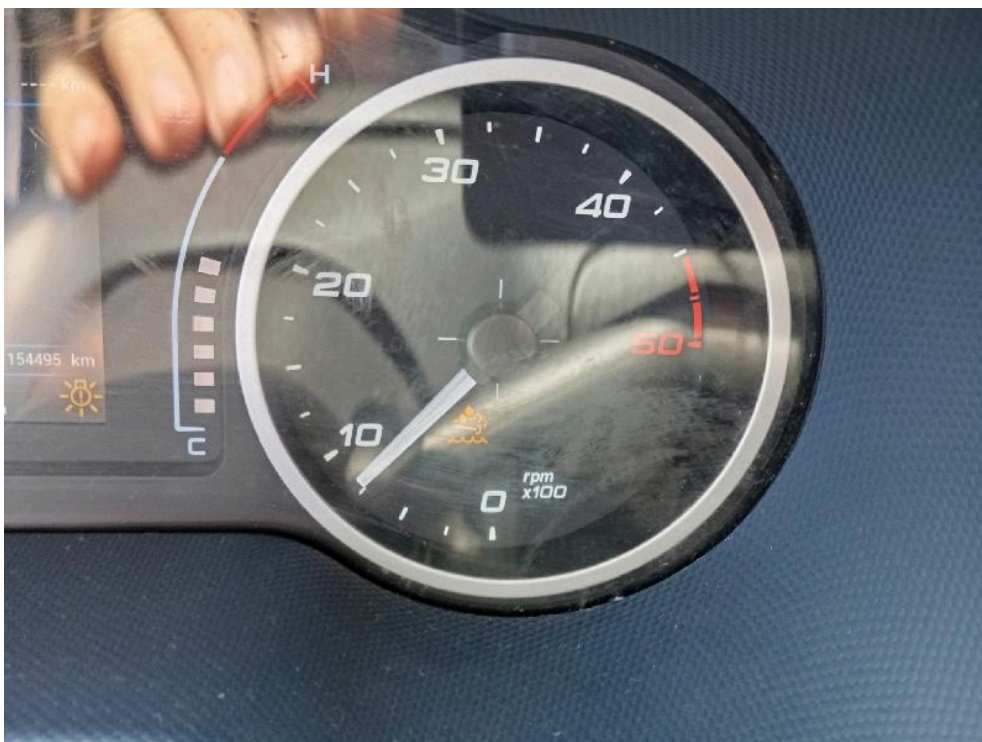
Bild: 16 Rußpartikelfilter voll
