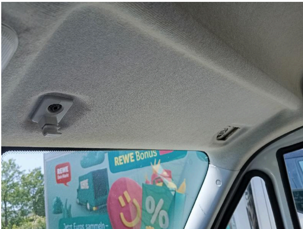
Bild: 18 Sonnenblende rechts abgerissen
