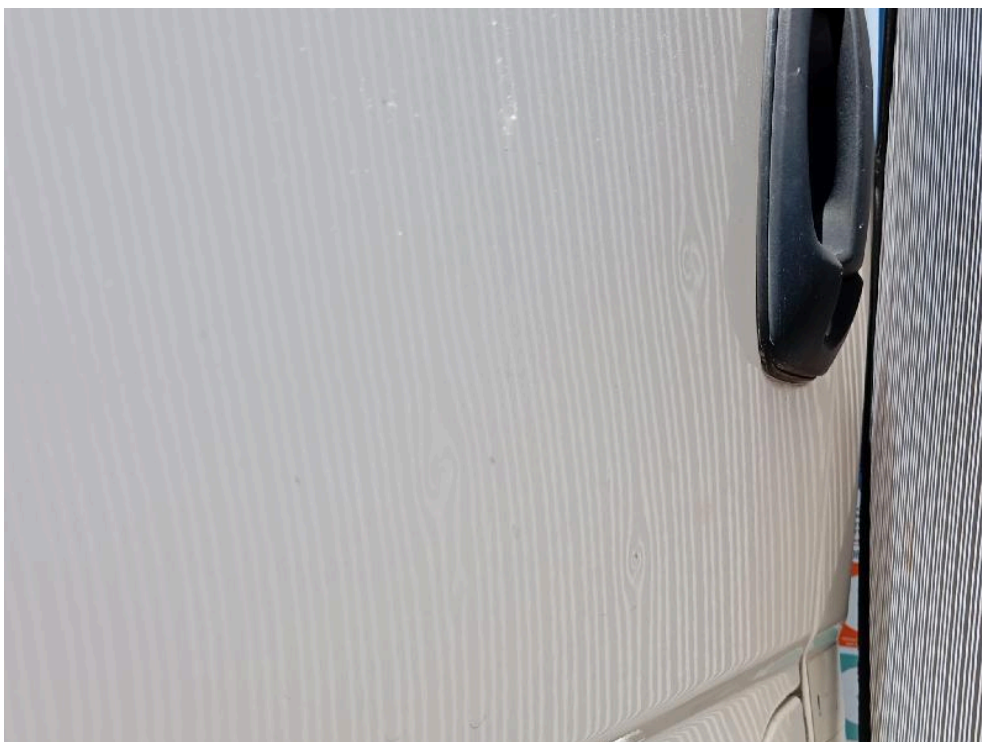
Bild: 24 Tür vorn links verkratzt und eingedellt
