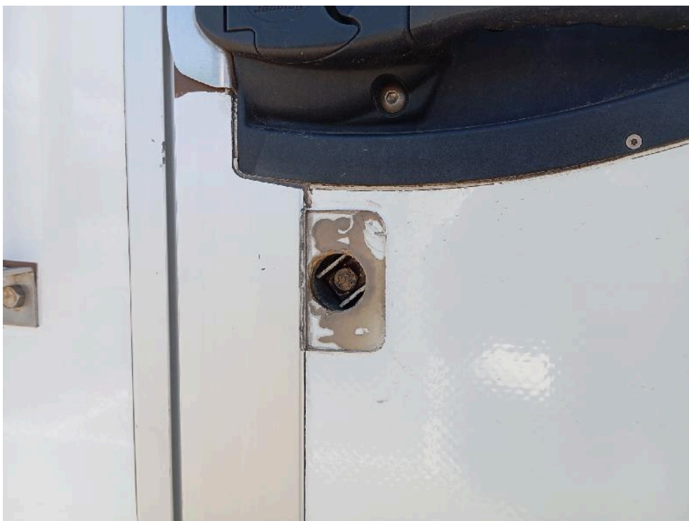
Bild: 48 Verschluss Hecktür defekt
