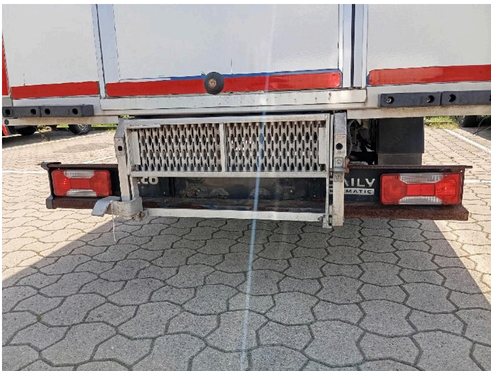
Bild: 30 Heckauftritt verformt/Heckunterfahrschutz Korrosionsbehaftet
