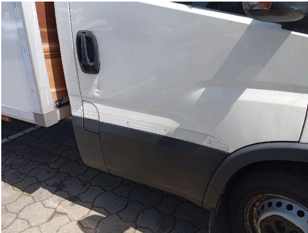
Bild: 43 Tür vorn rechts eingedellt
