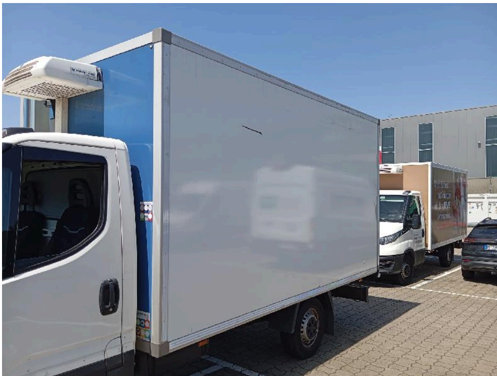
Bild: 26 Seitenwand Kofferaufbau links verkratzt und leicht streifend eingedrückt
