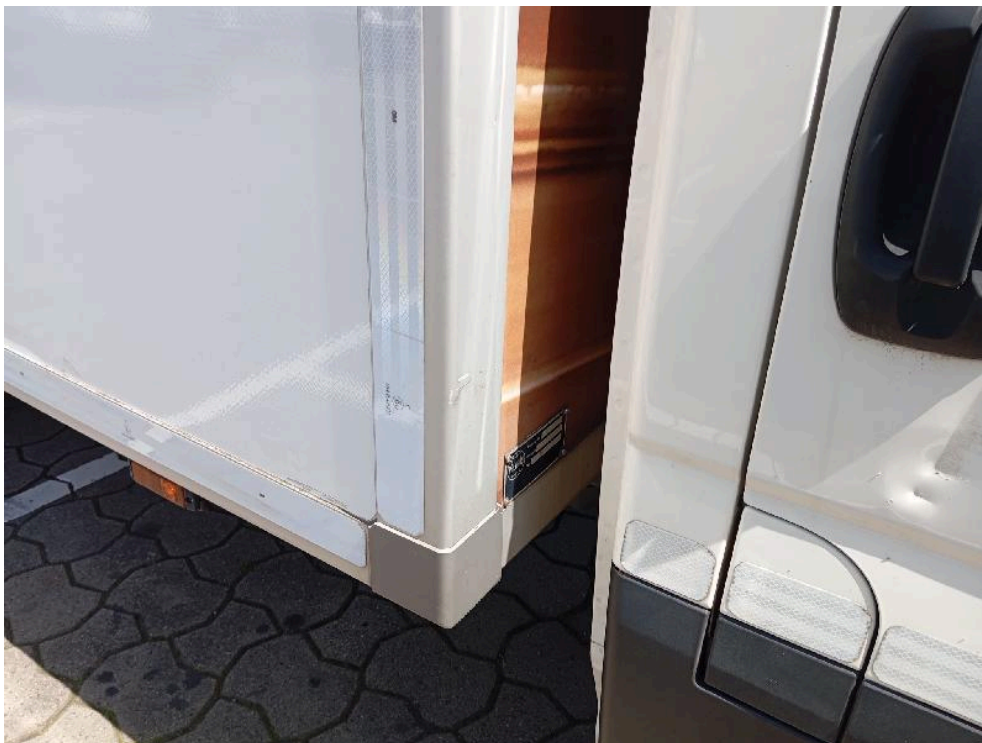
Bild: 40 Kofferseitenwand rechts verschrammt
