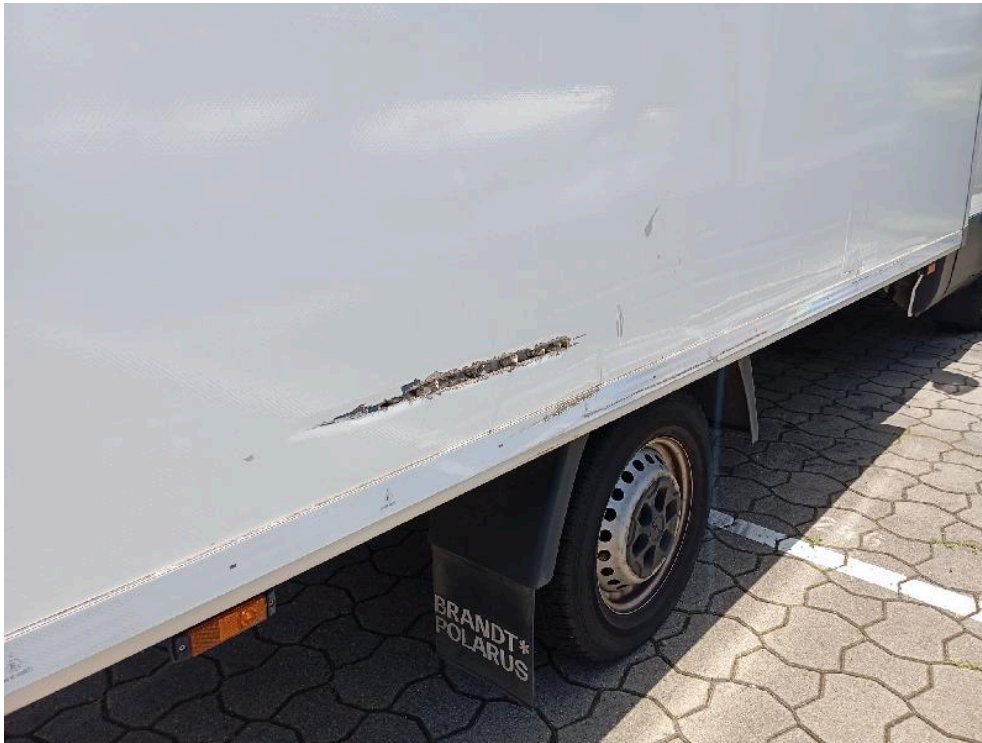
Bild: 37 Kofferseitenwand rechts aufgerissen
