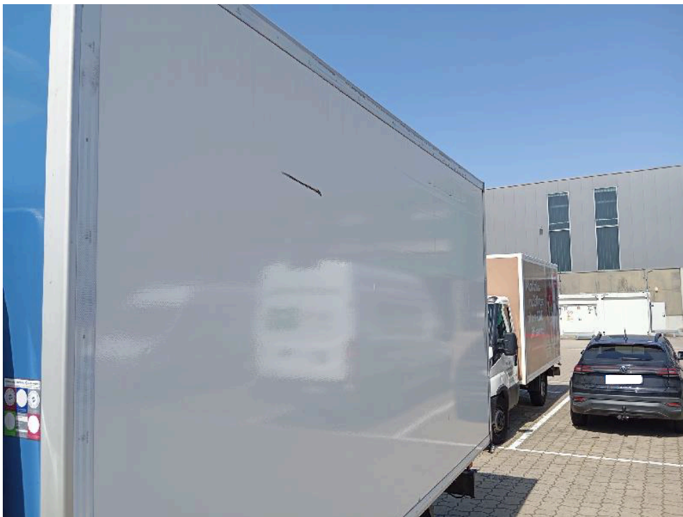
Bild: 28 Seitenwand Kofferaufbau links verkratzt und leicht streifend eingedrückt
