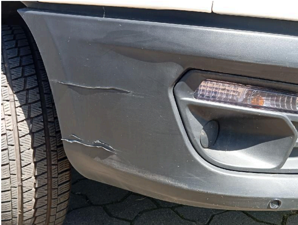
Bild: 19 Frontstoßfänger rechts verkratzt
