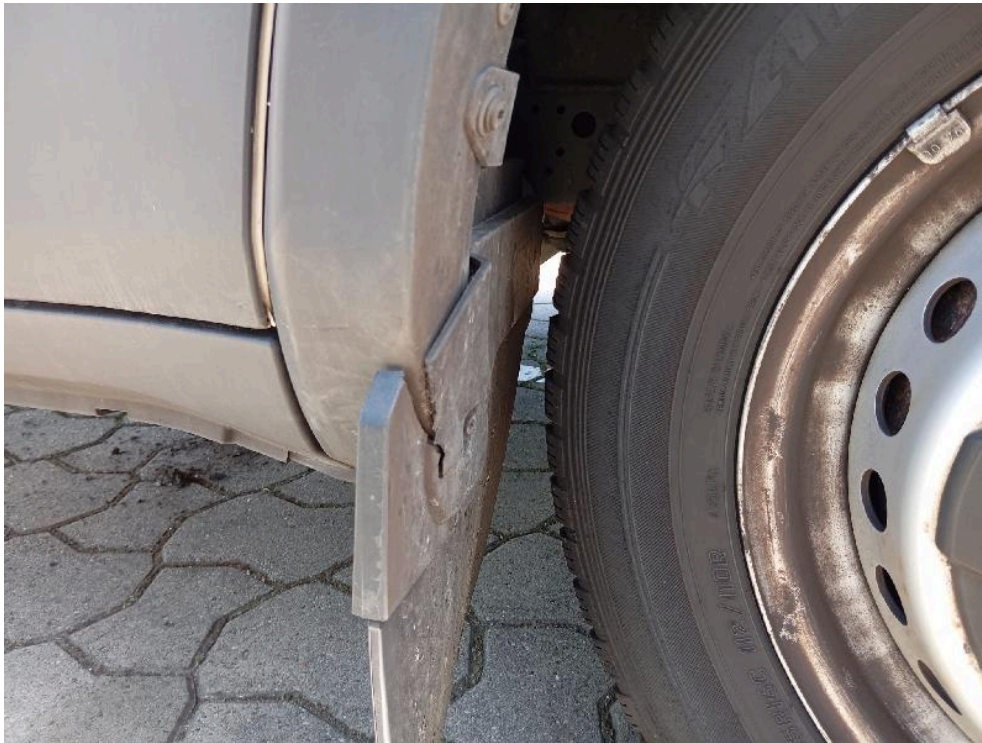
Bild: 41 Schmutzlappen Rad vorn rechts abgerissen
