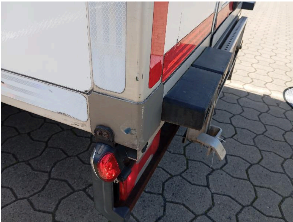
Bild: 35 Ecke Kofferaufbau hinten links verformt und verkratzt
