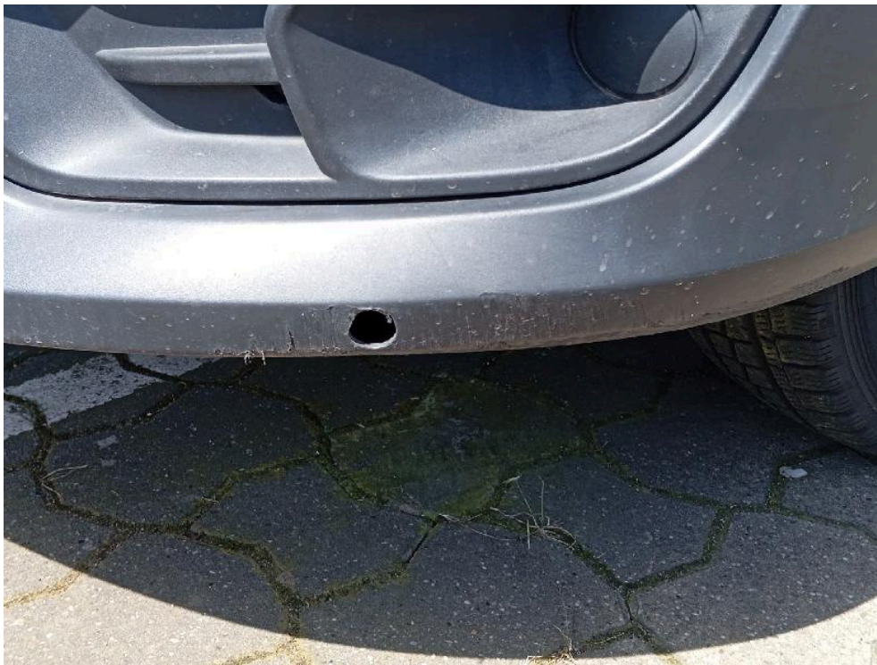
Bild: 21 Frontstoßfänger gebrochen
