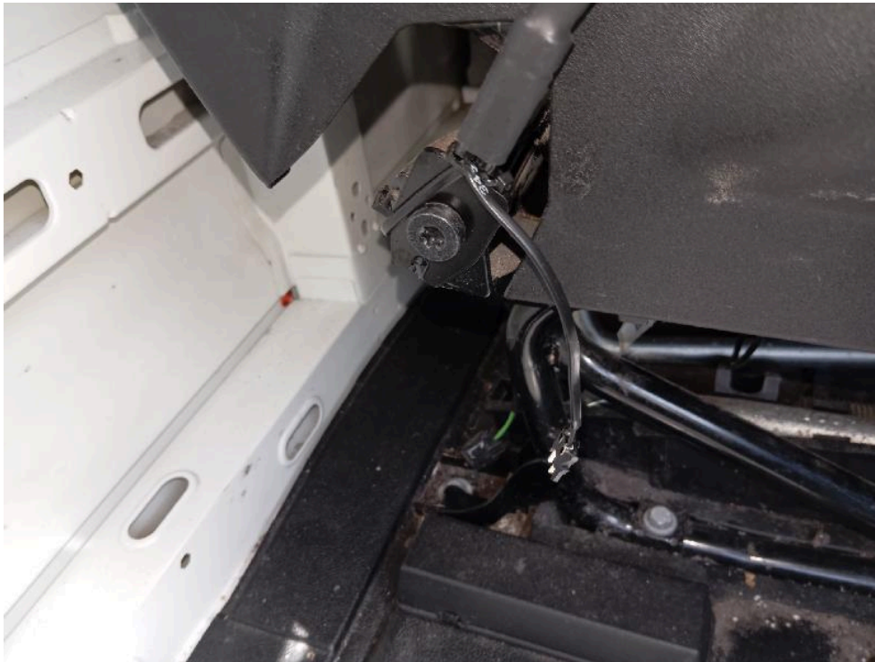
Bild: 15 Elektrische Stromversorgung Fahrersitz unterbrochen
