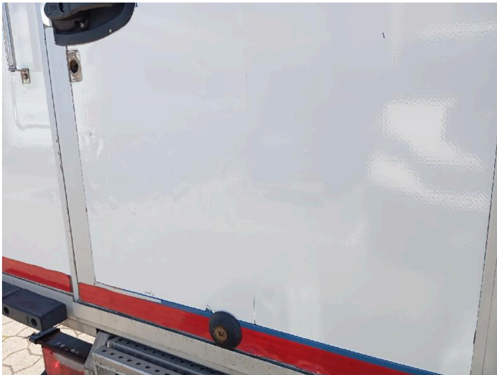
Bild: 33 Heckwand leicht eingedellt
