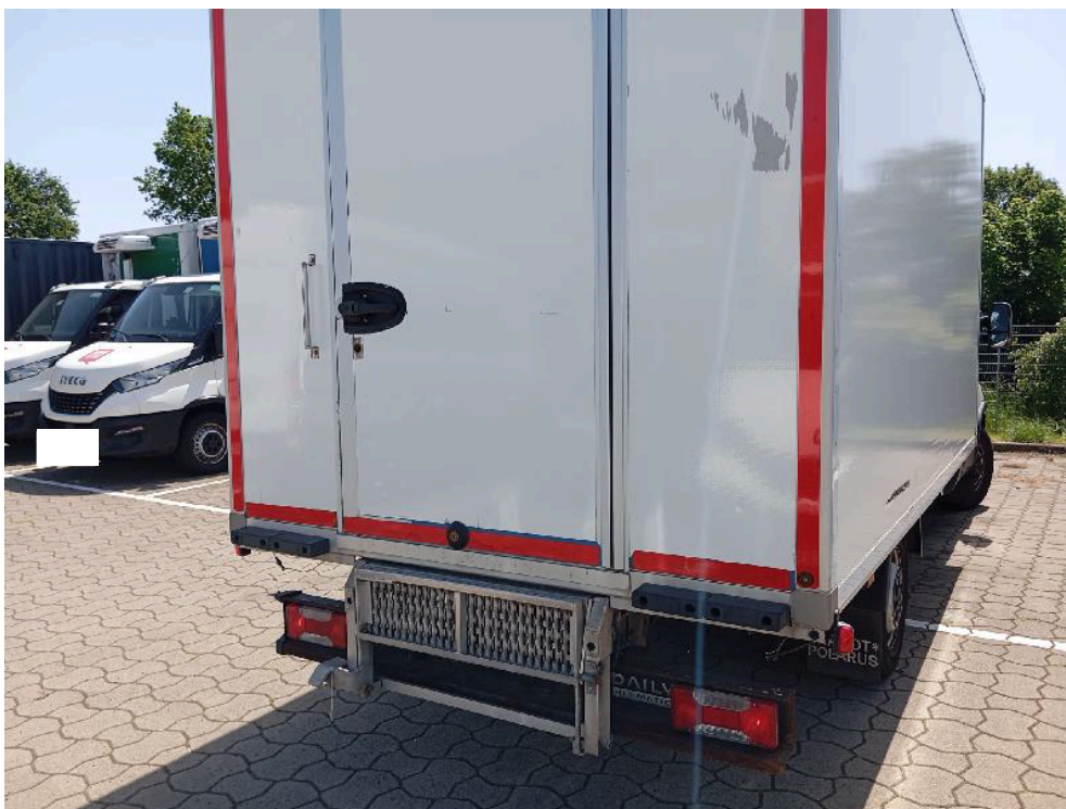
Bild: 32 Heckwand leicht eingedellt
