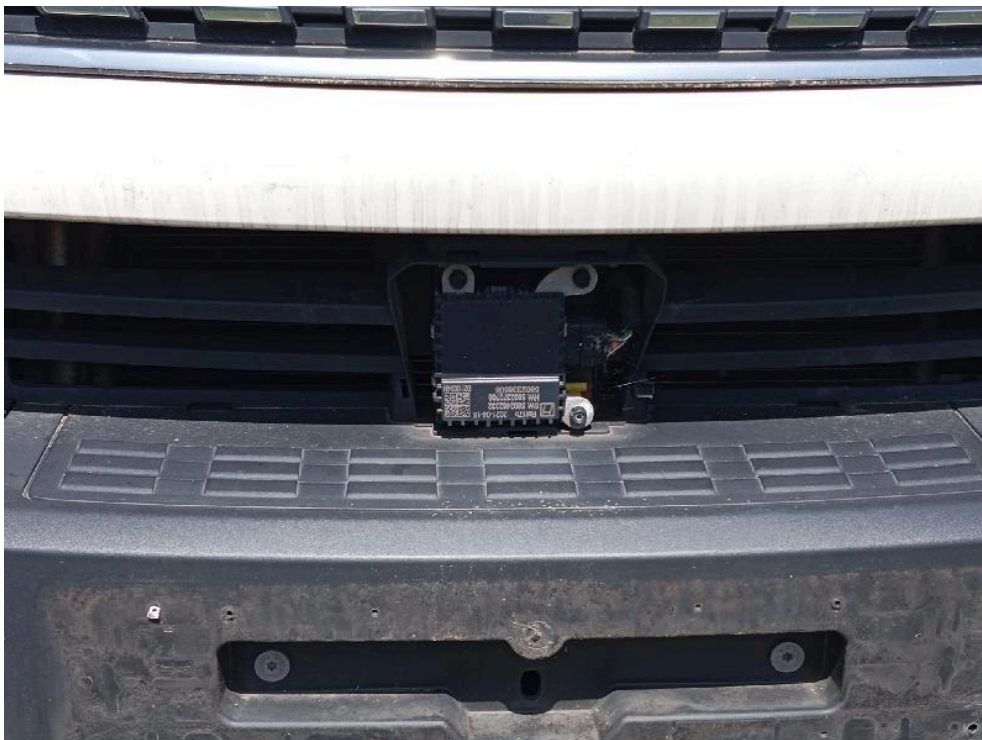
Bild: 20 Radarsensor Abdeckung fehlt
