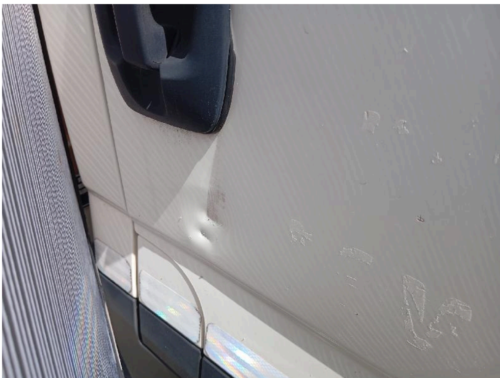
Bild: 44 Tür vorn rechts eingedellt
