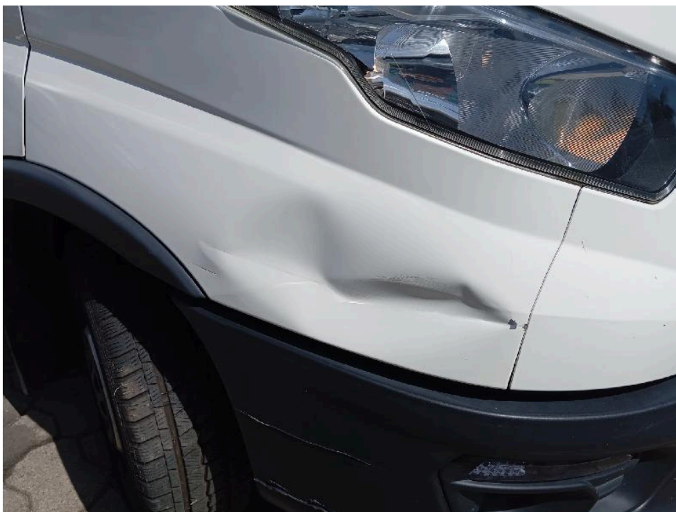
Bild: 46 Kotflügel rechts deformiert
