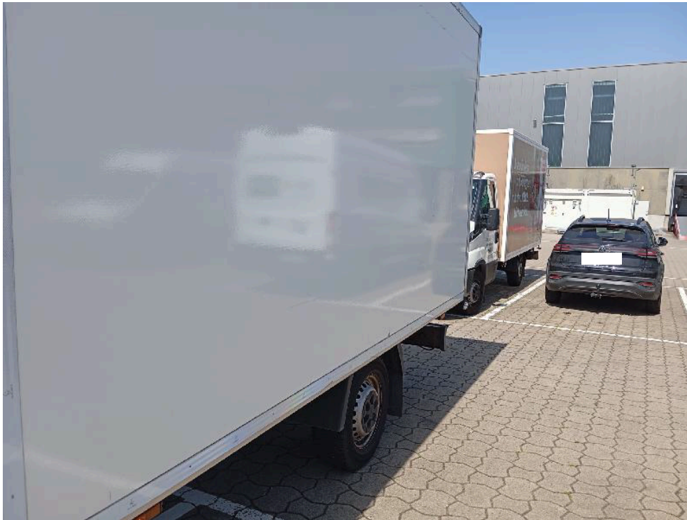
Bild: 29 Seitenwand Kofferaufbau links verkratzt und leicht streifend eingedrückt
