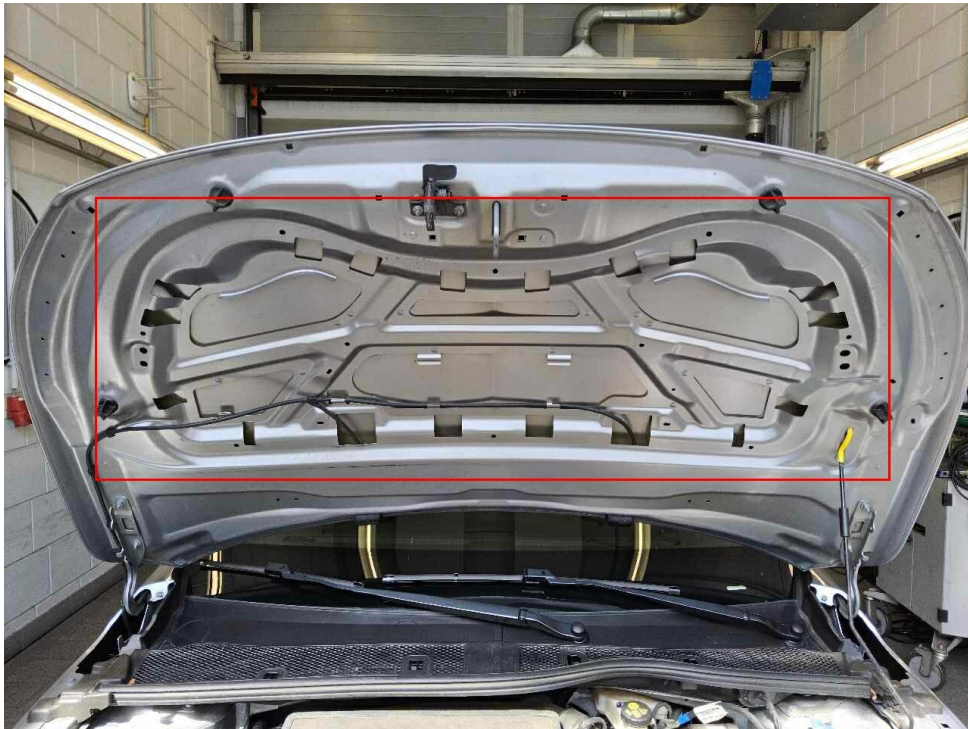
Bild 13 : Dämmmatte Motorhaube fehlt
