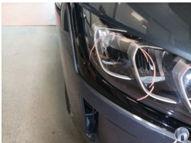
3. Scheinwerfer Halogen - Rechts Kratzer - Erneuern
