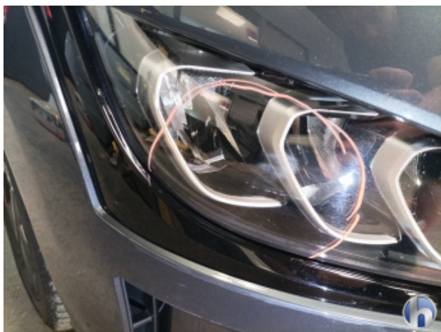
3. Scheinwerfer Halogen - Rechts Kratzer - Erneuern
