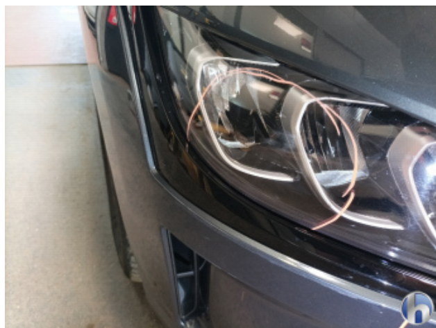
3. Scheinwerfer Halogen - Rechts Kratzer - Erneuern
