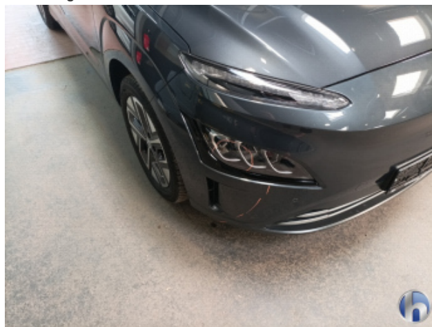
3. Scheinwerfer Halogen - Rechts Kratzer - Erneuern
