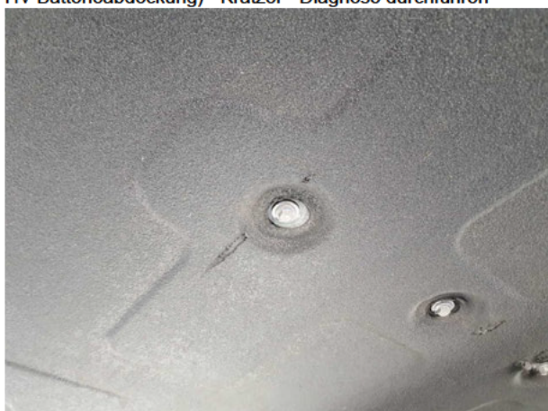
Beschädigung #1: elektrisches System: Batterieabdeckung (Kratzer ... HV-Batterieabdeckung) - Kratzer - Diagnose durchführen
