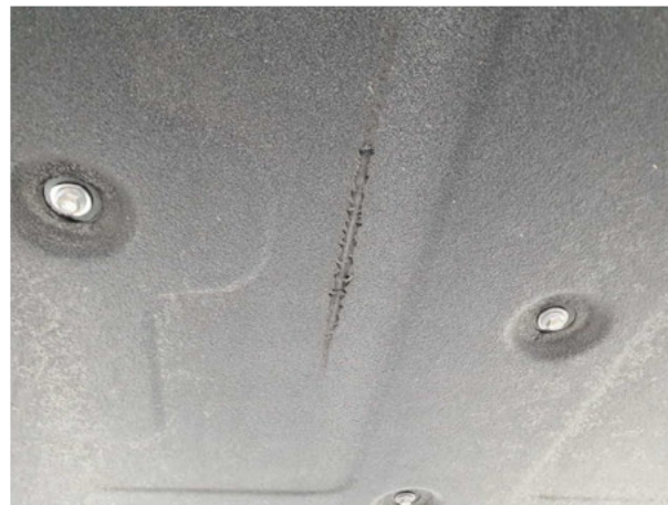
Beschädigung #1: elektrisches System: Batterieabdeckung (Kratzer an HV-Batterieabdeckung) - Kratzer - Diagnose
