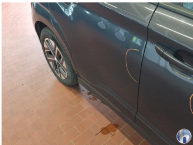
2. Tür Hinten - Rechts 1 Delle - Sanft Instandsetzen
