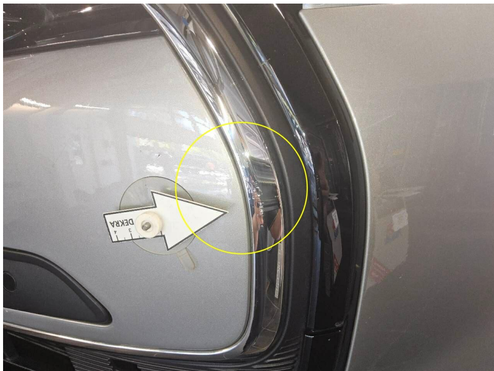
Bild 18 : Grill vorne Chromleiste, verschrammt
