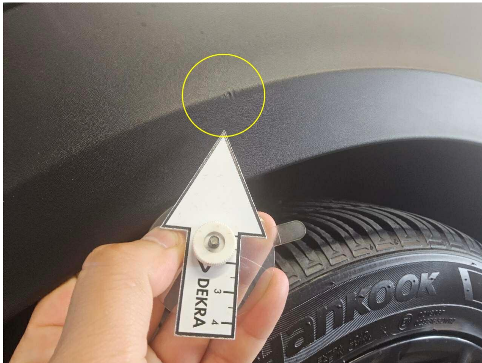
Bild 17 : Radlaufvorbereitung vorne links, verschrammt
