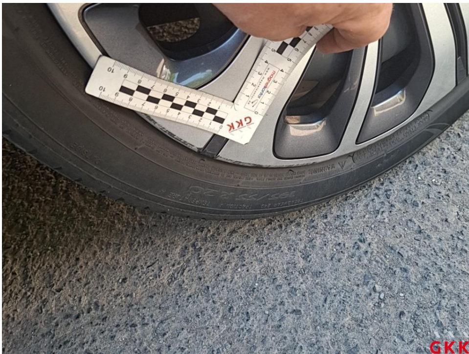
Bild 26. Radkappe(n), hinten links, beschädigt, ersetzen
