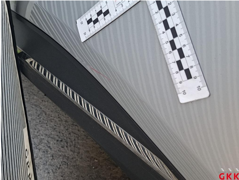
Bild 35. Tür hinten links, beschädigt, instand setzen - lackieren
