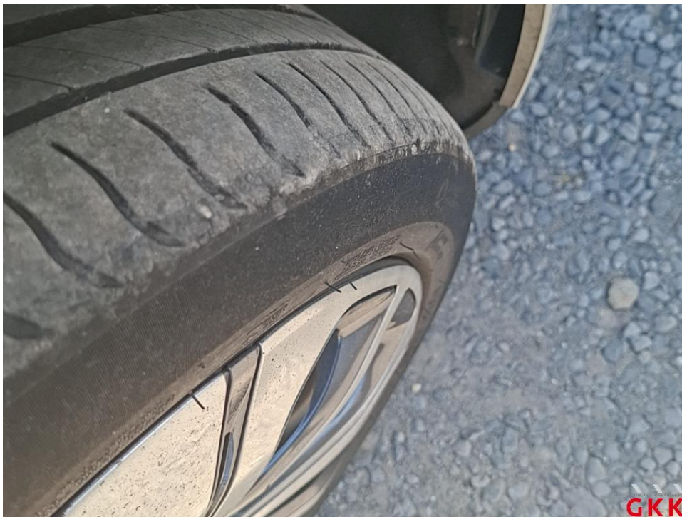
Bild 38. Reifen, vorne rechts, Untermaß, ersetzen
