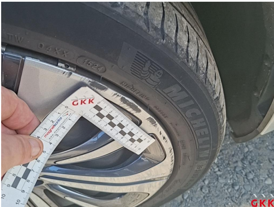
Bild 22. Radkappe(n), vorne rechts, beschädigt, ersetzen
