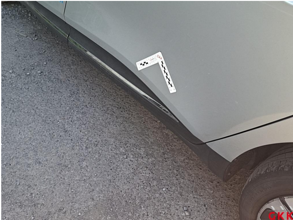
Bild 34. Tür hinten links, beschädigt, instand setzen - lackieren
