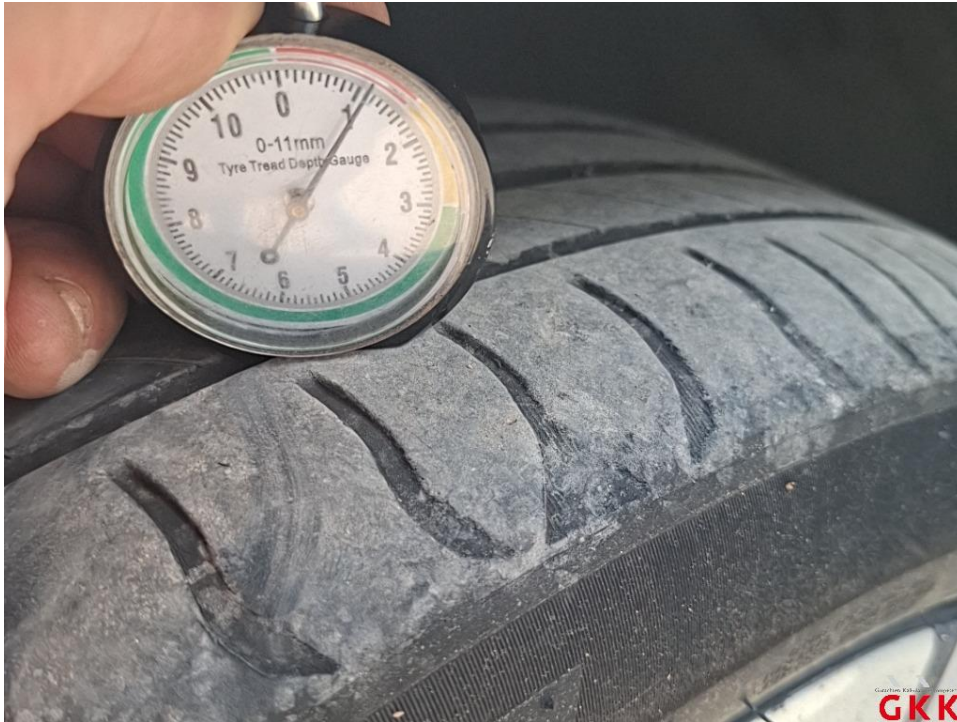
Bild 37. Reifen, vorne rechts, Untermaß, ersetzen
