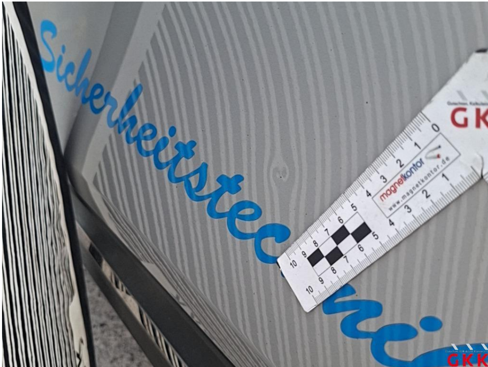
Bild 32. Tür vorne links, beschädigt, instand setzen - lackieren
