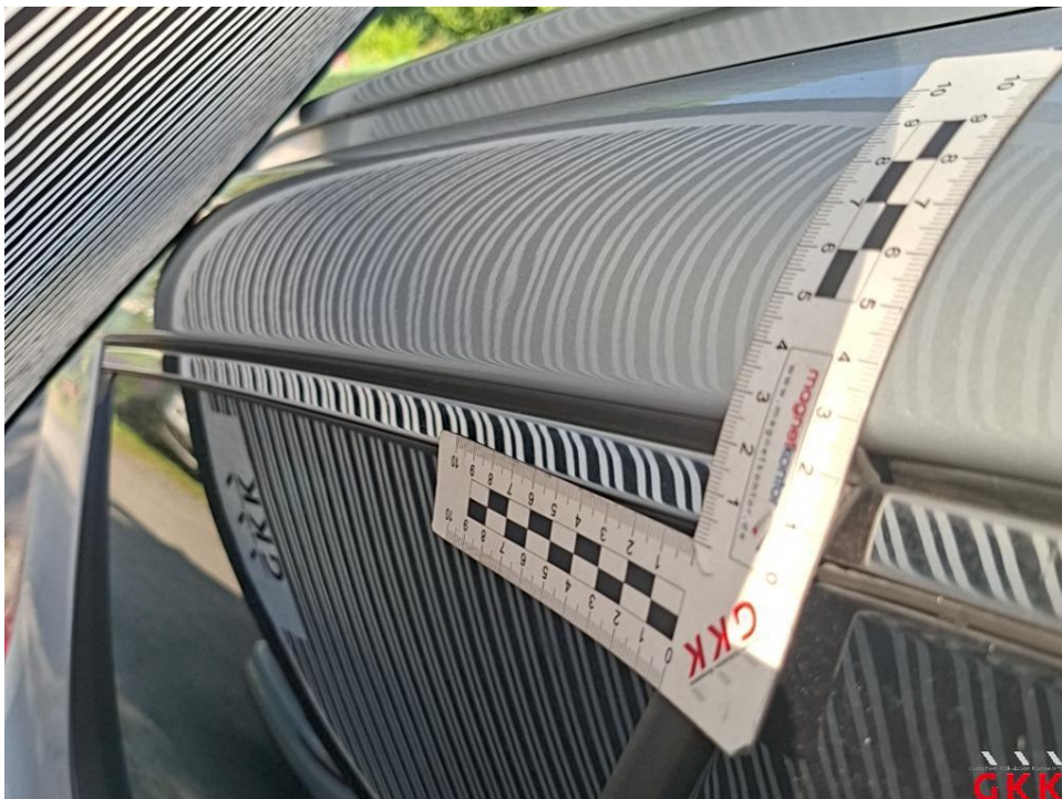
Bild 42. Dach, Holm rechts, beschädigt, kalt drücken
