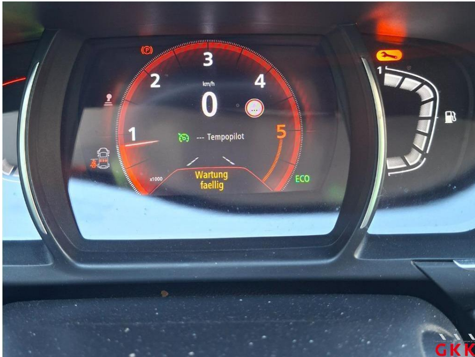
Bild 13. Inspektion klein, Mittelklasse, fällig, durchführen
