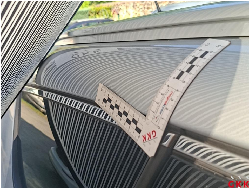
Bild 41. Dach, Holm rechts, beschädigt, kalt drücken
