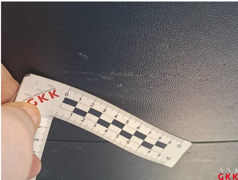
Bild 20. Heckklappe, Innenverkleidung, beschädigt, ersetzen
