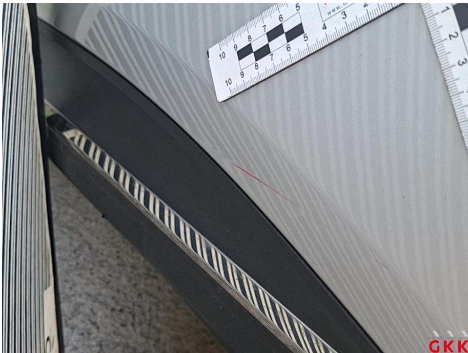
Bild 36. Tür hinten links, beschädigt, instand setzen - lackieren
