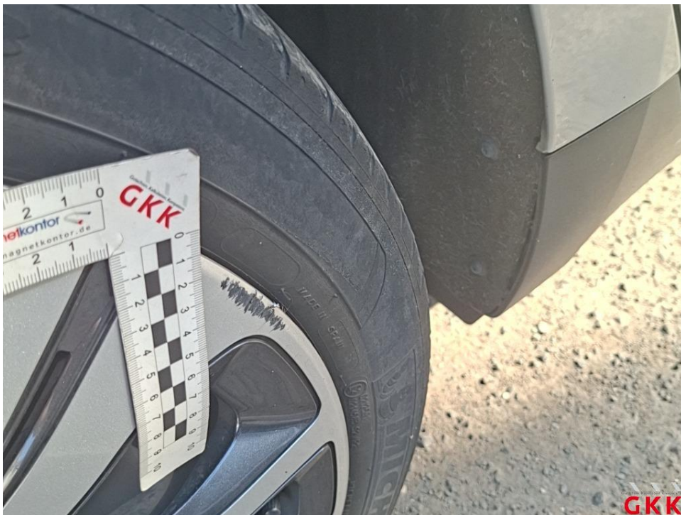
Bild 30. Radkappe(n), hinten rechts, beschädigt, ersetzen
