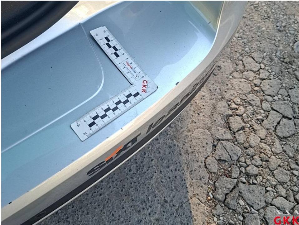
Bild 29. Stoßfänger hinten, Verkleidung oberhalb -lackiert-, verkratzt, lackieren
