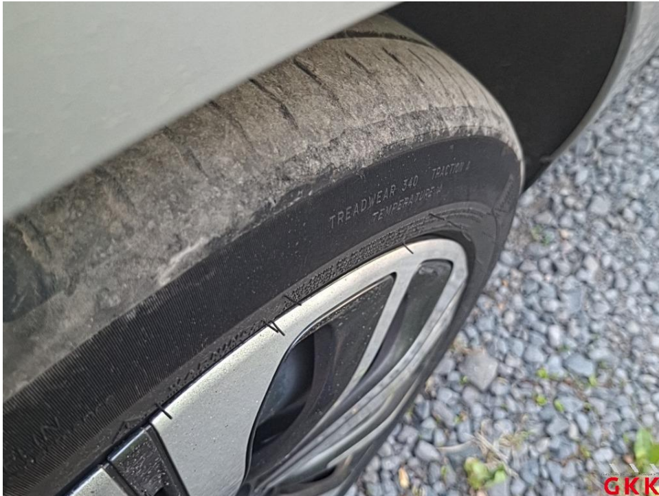
Bild 39. Reifen, vorne links, Untermaß, ersetzen
