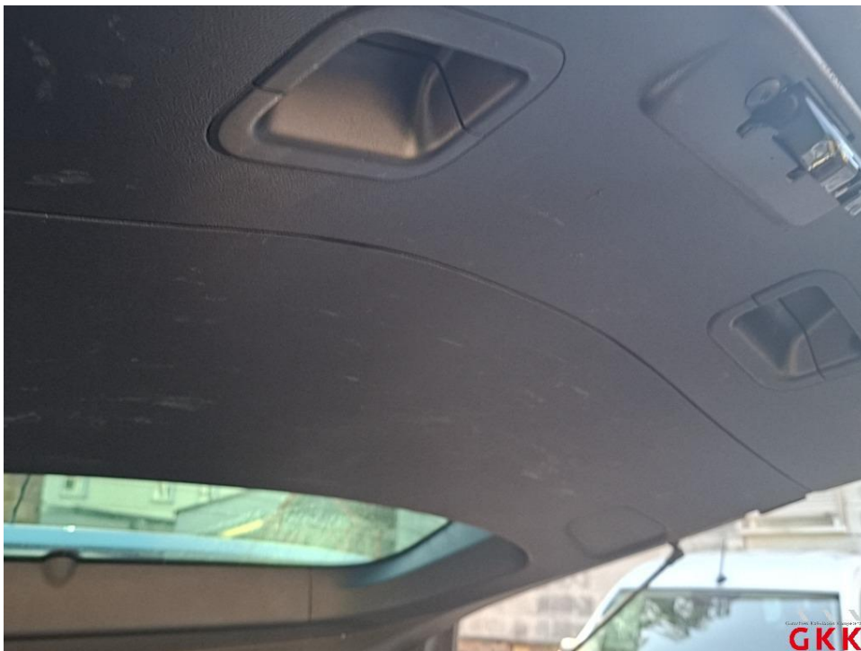
Bild 18. Heckklappe, Innenverkleidung, beschädigt, ersetzen
