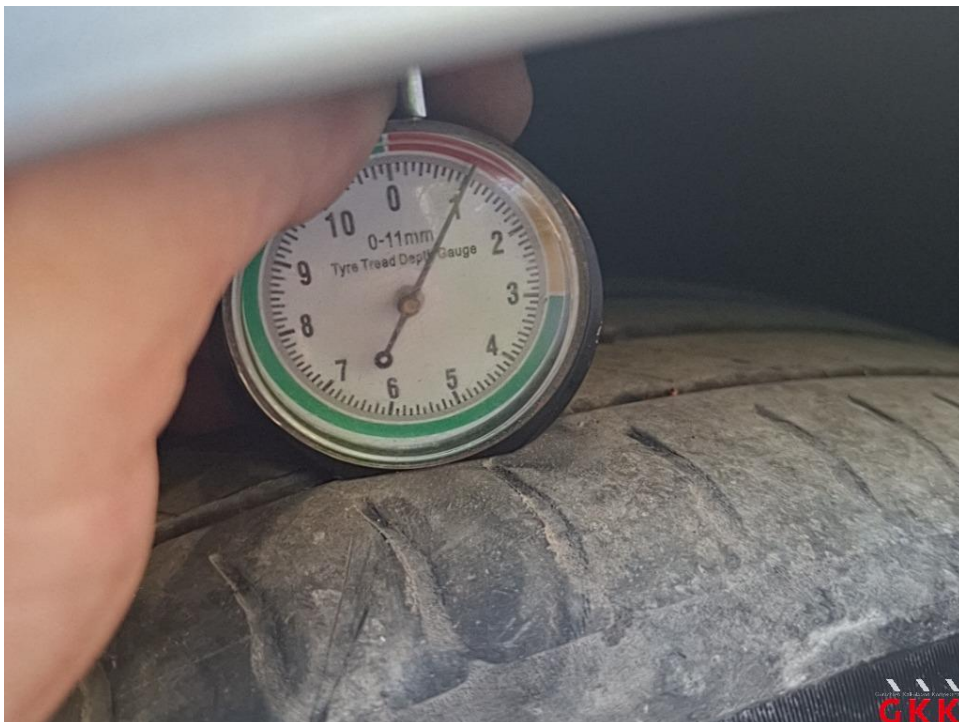
Bild 40. Reifen, vorne links, Untermaß, ersetzen
