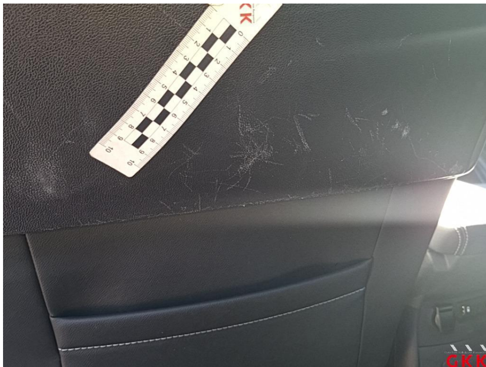
Bild 23. Fahrzeug, innen, verkratzt, Smartrepair
