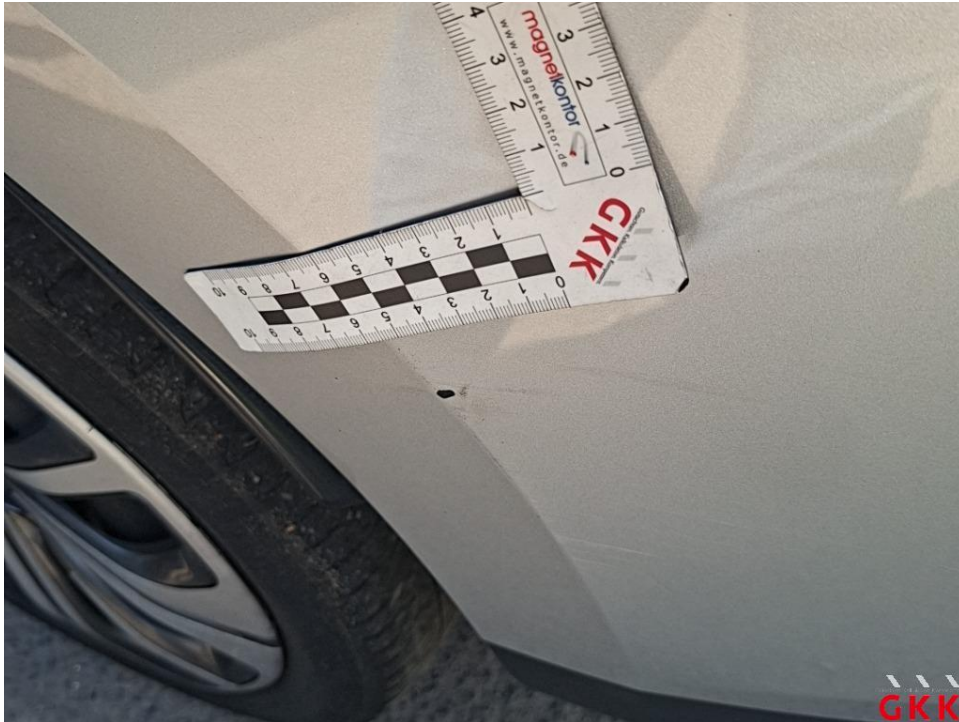
Bild 27. Stoßfänger hinten, Verkleidung oberhalb -lackiert-, verkratzt, lackieren
