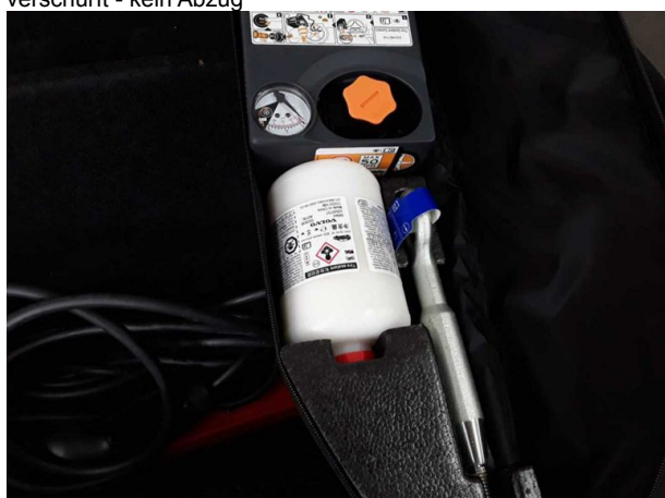
Beschädigung #2: Ausrüstung: Tirefit Füllmittel - abgelaufen - erneuern
