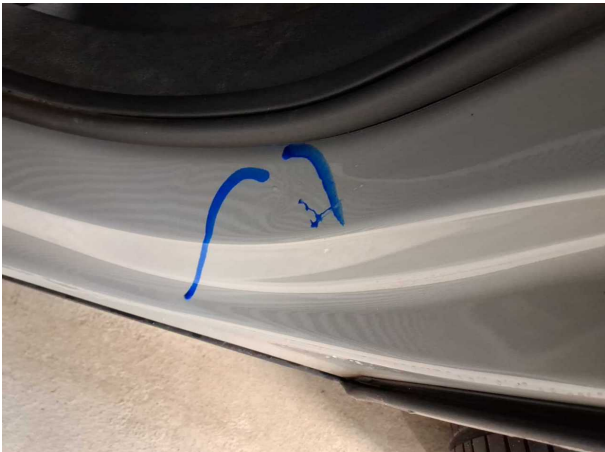
Beschädigung #5: Seitenwand links: Einstieg - Delle(n) - sanft instandsetzen
