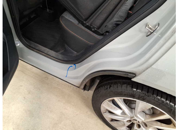
Beschädigung #5: Seitenwand links: Einstieg - Delle(n) - sanft instandsetzen
