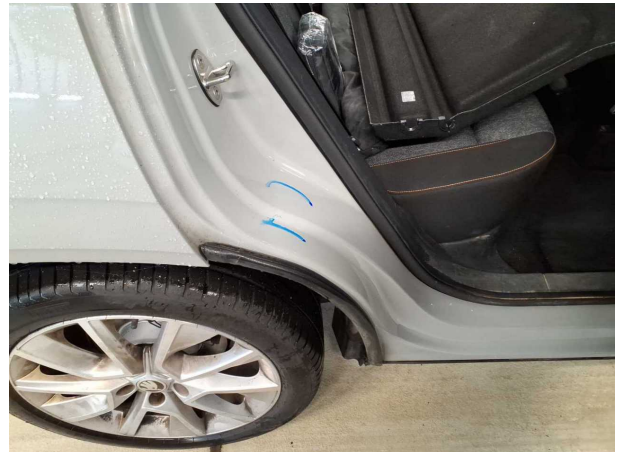
Beschädigung #6: Seitenwand rechts: Einstieg - Kratzer - Smart Repair
