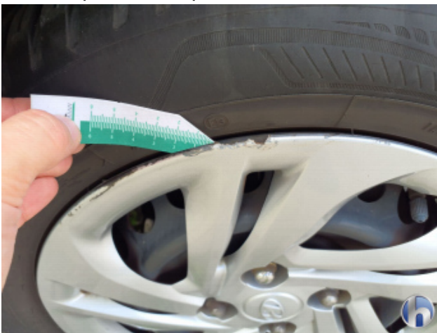
6. Radkappe - Vorne - Rechts Beschädigt - Erneuern
