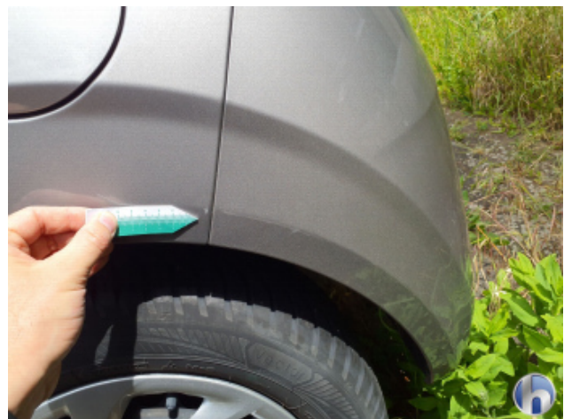
4. Seitenwand - Hinten - Links Kratzer - Smart Repair
