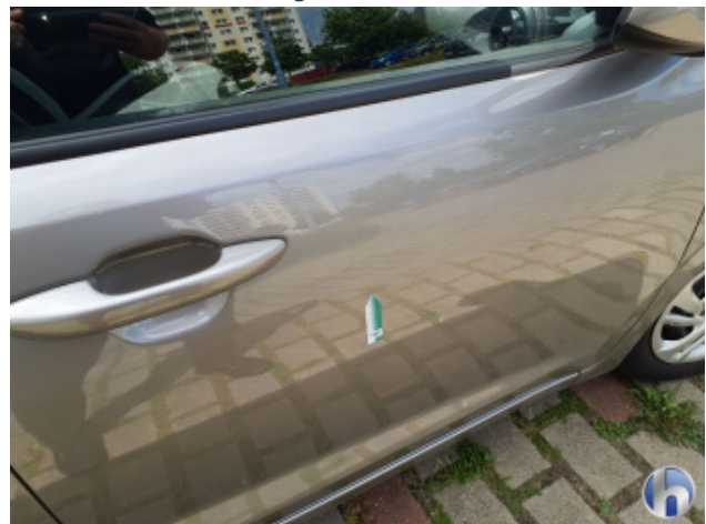
3. Tür Vorne - Rechts Verdellt - Sanft Instandsetzen
