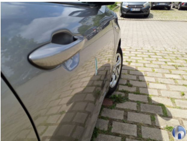
3. Tür Vorne - Rechts Verdellt - Sanft Instandsetzen
