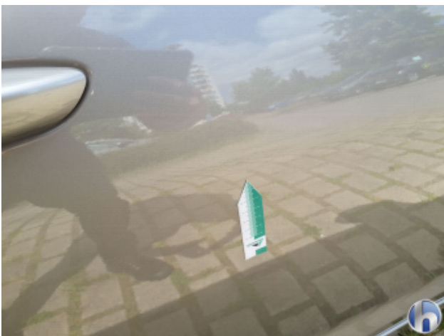
3. Tür Vorne - Rechts Verdellt - Sanft Instandsetzen
