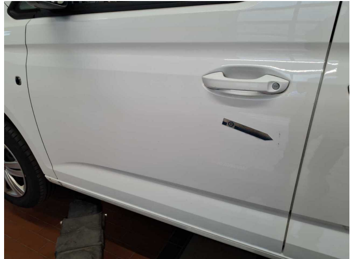
Damage 11: Door - front left side: Door - Scratch(es) - Paint
