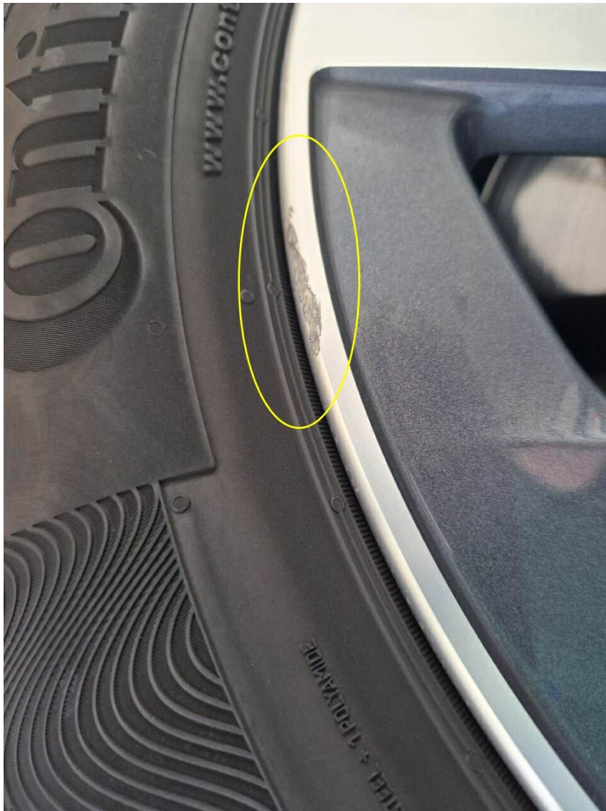
Bild 18 : Leichtmetallfelge vorne links verschrammt ( Glanzgedreht )
