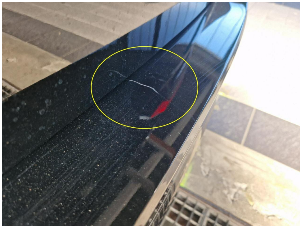
Bild 16 : Stoßfänger hinten Lackierung, verschrammt, lackieren mit Lackaufbau
