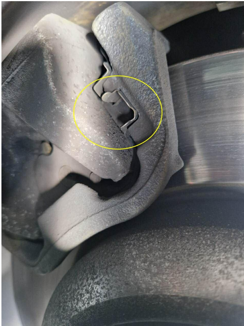
Bild 21 : Bremsbeläge an der Hinterachse an Verschleissgrenze
