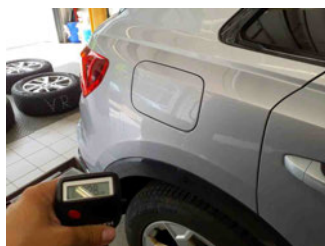
Lackstärke Seitenwand hinten rechts
