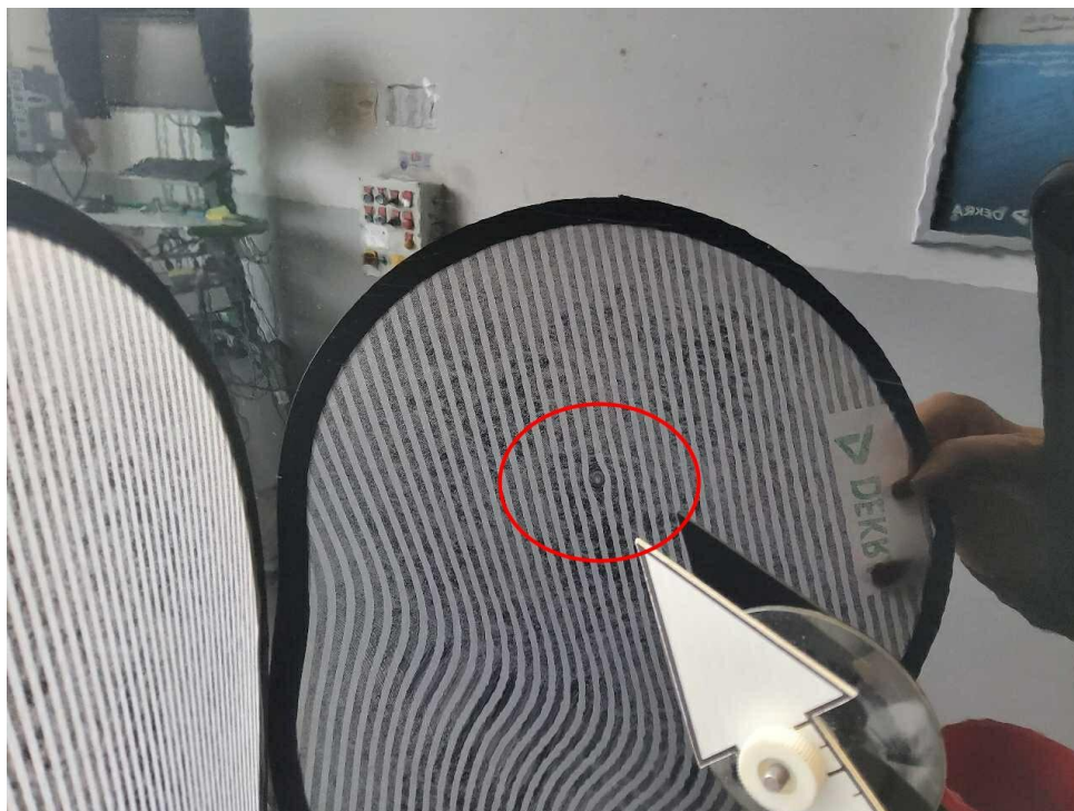
Bild 15 : Tür hinten rechts Delle
