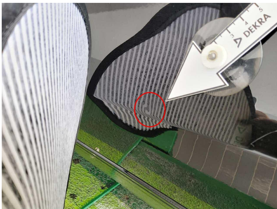
Bild 16 : Tür hinten links Delle
