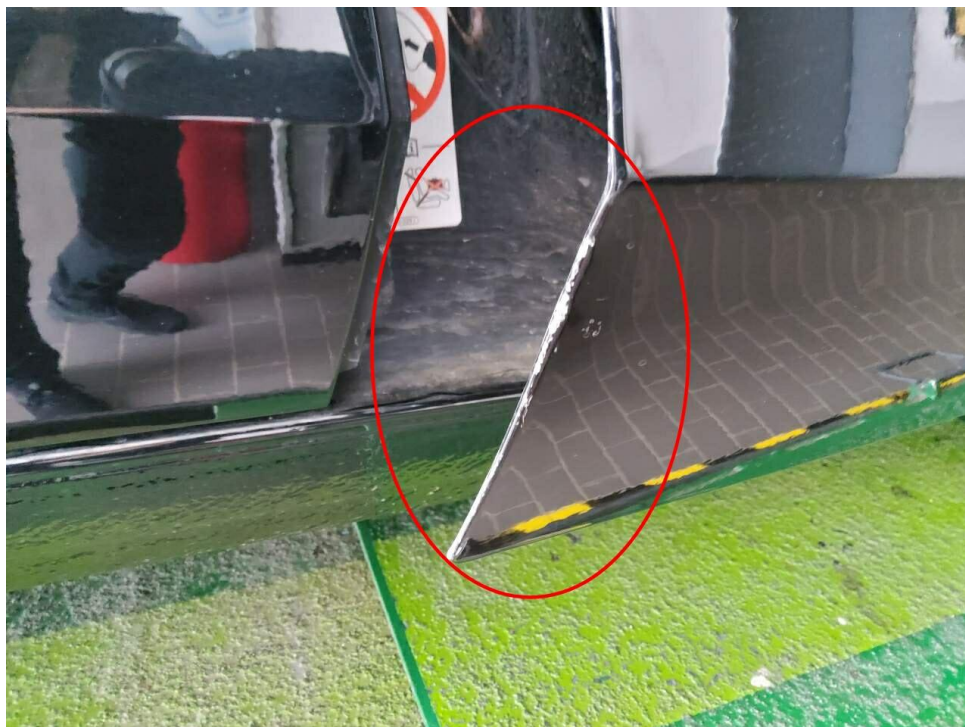
Bild 18 : Türkante vorn rechts unten Lackabplatzer, Gebrauchsspur
