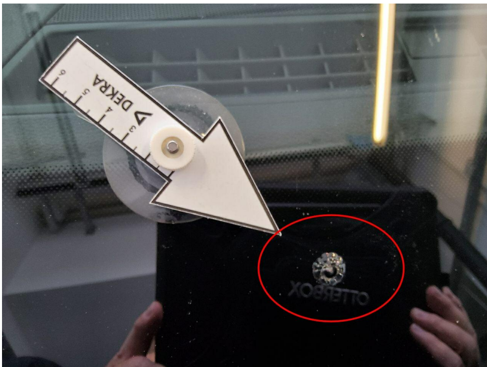
Bild 14 : Frontscheibe mittig unten am Rand Steinschlag
