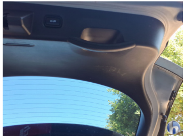
4. Verkleidung Verschmutzt - Reinigen
