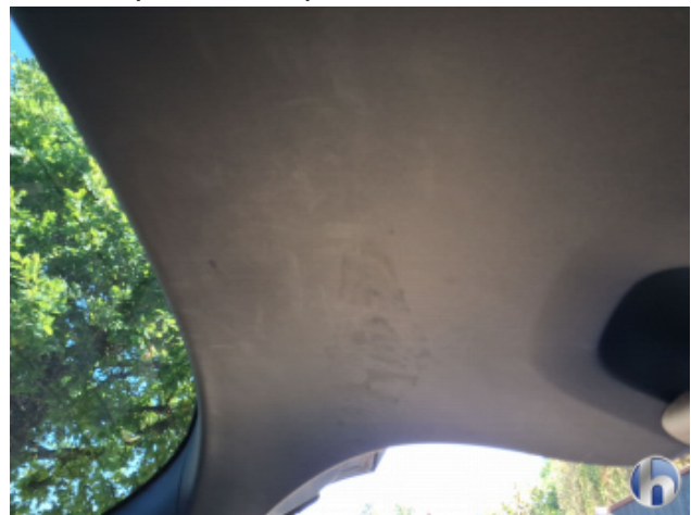
4. Verkleidung Verschmutzt - Reinigen
