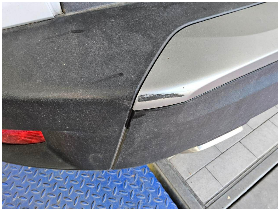
Bild 12 : Stoßfänger hinten, Blende verschrammt
