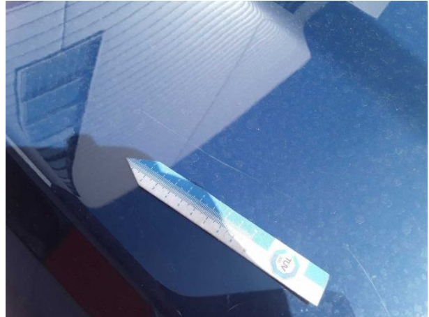
Beschädigung 1: Motorhaube: Motorhaube - verkratzt / verschürft - aufbereiten
