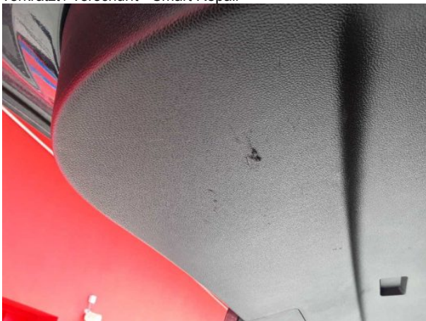
Beschädigung 8: Verkleidungen/Abdeckungen: Heckdeckel, Innenverkleidung - Lackmangel - Wertminderung
