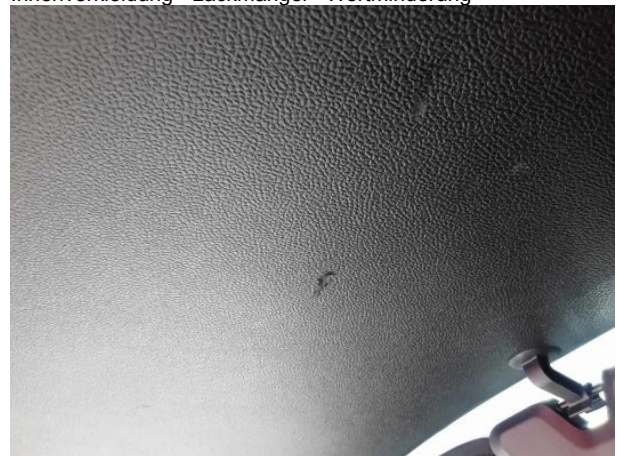
Beschädigung 8: Verkleidungen/Abdeckungen: Heckdeckel, Innenverkleidung - Lackmangel - Wertminderung
