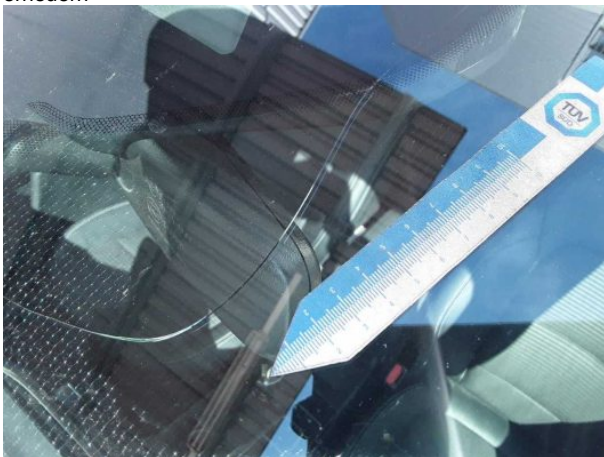
Beschädigung 12: Verglasung: Frontscheibe (Gerissen) - Steinschlag - erneuern
