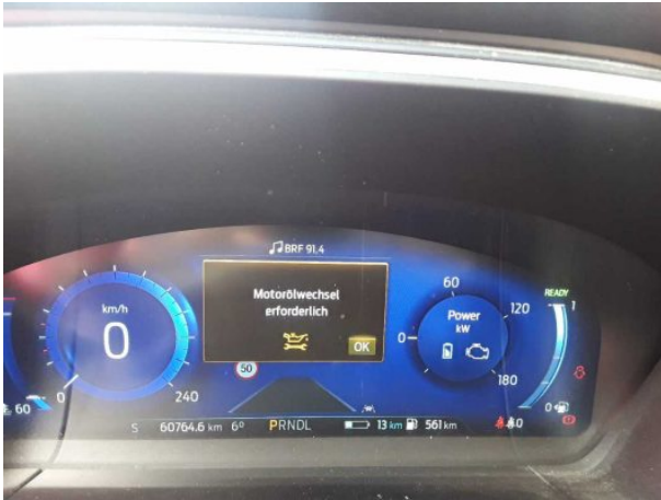
Beschädigung 11: Sonstiges: Inspektion/Wartung - fällig - erneuern
