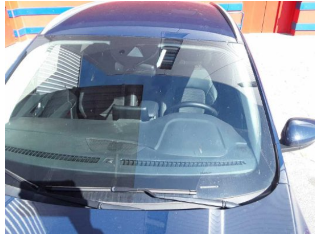
Beschädigung 12: Verglasung: Frontscheibe (Gerissen) - Steinschlag - erneuern
