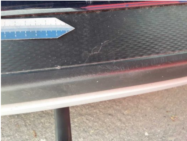
Beschädigung 6: Stossfänger hinten: Stossfänger hinten (unlackiert) - verkratzt / verschürft - Wertminderung
