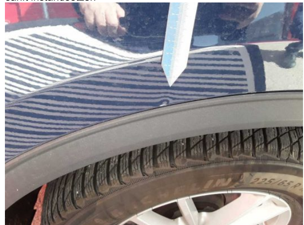
Beschädigung 5: Seitenwand rechts: Seitenwand - Delle(n) - sanft instandsetzen
