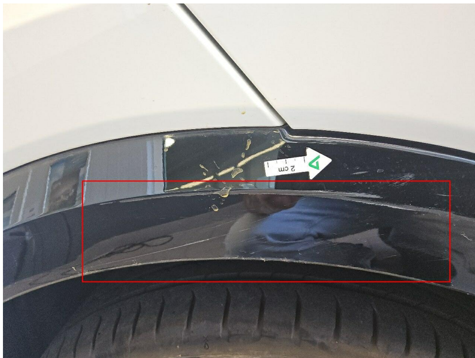
Bild 11 : Radlaufblende hinten rechts, verschrammt
