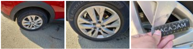
Alloy rim FR, Scratch(es), Repair/replace (lump sum)
