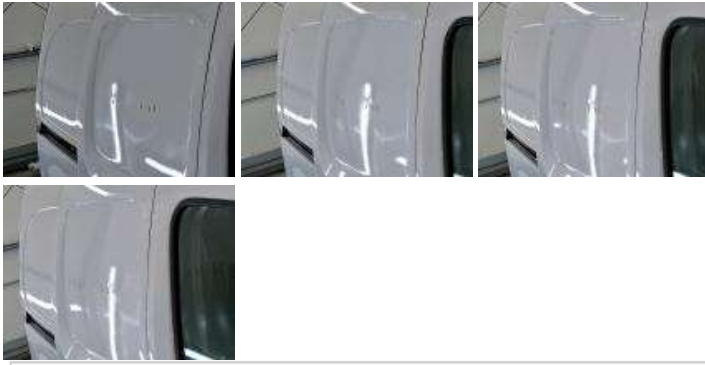
Porte AVD, Bosse(s), LI - Réparer et peindre (complet)
