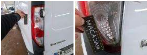
Feu antibrouillard ARG, Cassé, E - Remplacer
