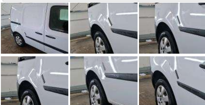
Porte coulissante D, Bosse(s), LI - Réparer et peindre (complet)
