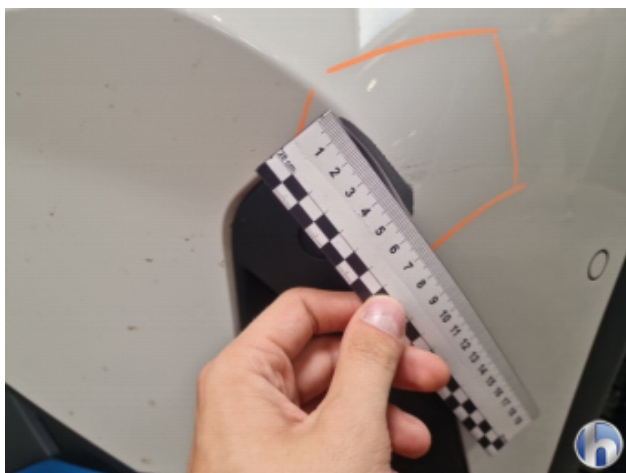
7. Stoßfänger Vorne Kratzer - Smart Repair
