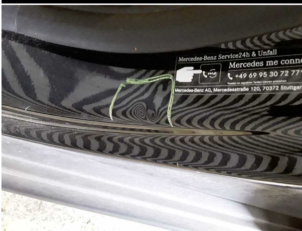
Beschädigung #4: Schweller links: Einstieg - Delle(n) - sanft instandsetzen
