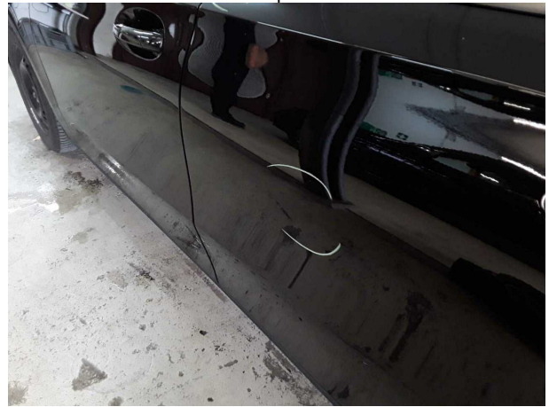
Beschädigung #6: Tür hinten links: Tür - verkratzt / verschürft... instandsetzen und lackieren
