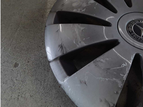
Beschädigung #1: Rad/Reifen: Radblende vorn links - verkratzt / verschürft - erneuern
