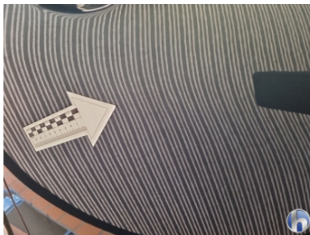
6. Tür Vorne - Rechts Gebrauchsspuren - Ohne Reparatur
