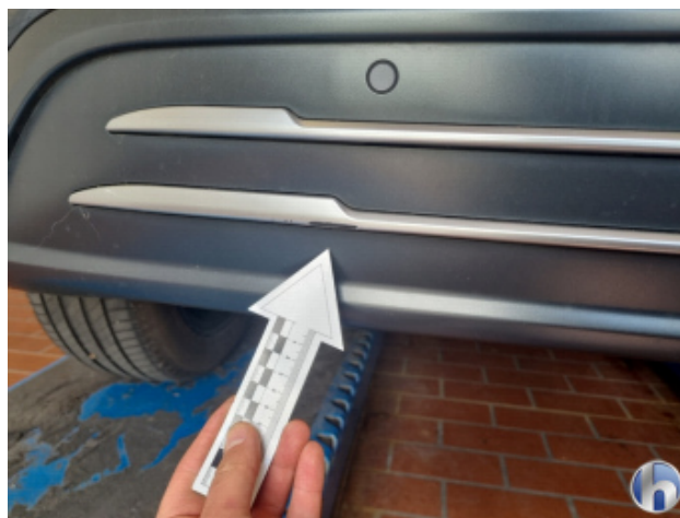
3. Stoßfänger Hinten Kratzer - Erneuern
