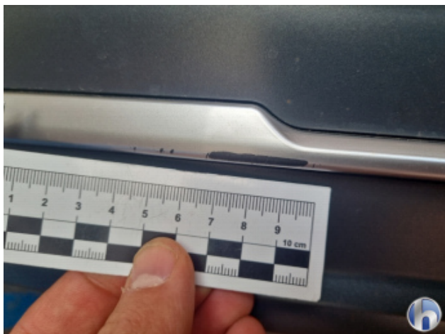
3. Stoßfänger Hinten Kratzer - Erneuern
