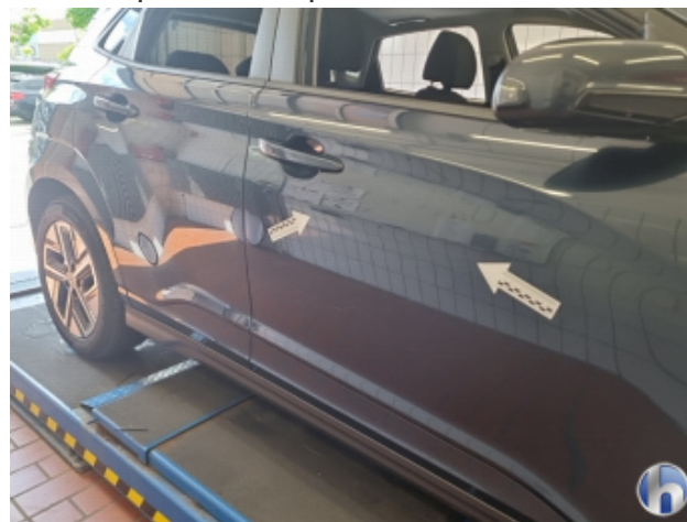
6. Tür Vorne - Rechts Gebrauchsspuren - Ohne Reparatur
