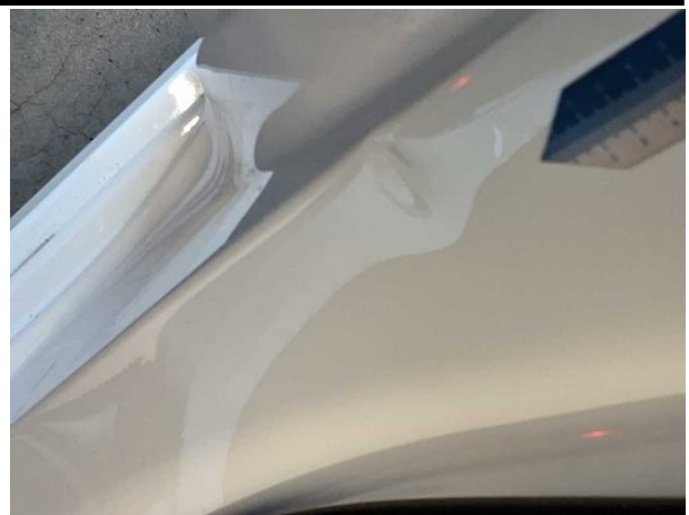
Beschädigung #4: Seitenwand rechts: Einstieg - Delle(n) - instandsetzen und lackieren
