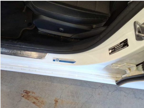
Beschädigung #2: Schweller links: Einstieg - Delle(n) - sanft instandsetzen
