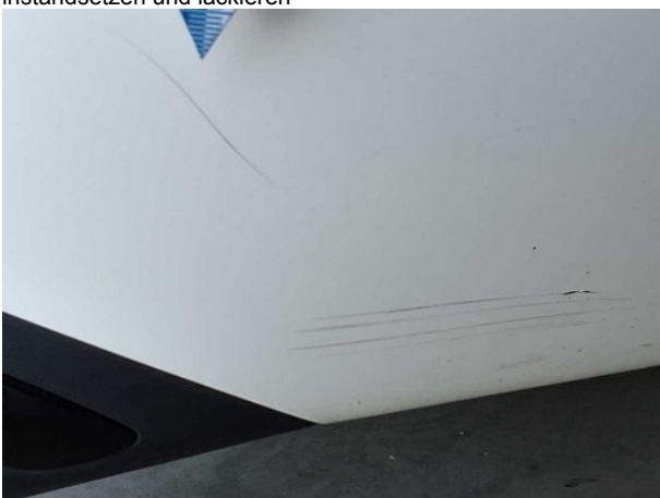
Beschädigung #5: Stossfänger hinten: Stossfänger hinten - Kratzer - instandsetzen und lackieren
