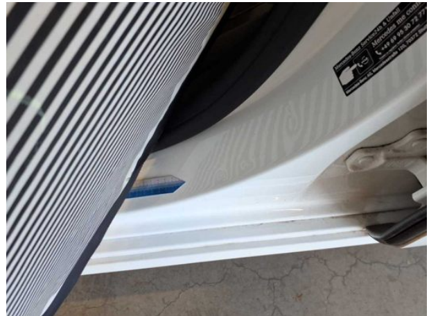
Beschädigung #2: Schweller links: Einstieg - Delle(n) - sanft instandsetzen
