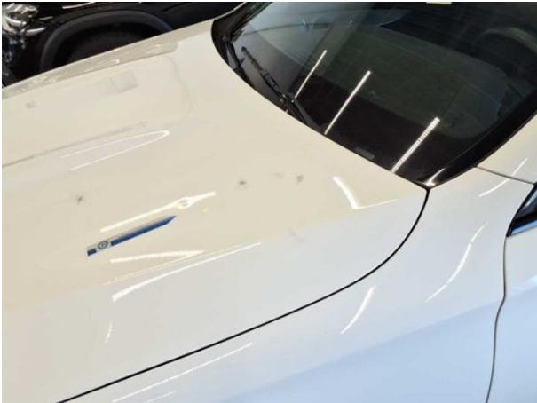
Beschädigung #1: Motorhaube: Motorhaube - Delle(n) - sanft instandsetzen
