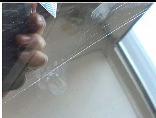
Beschädigung #6: Verglasung: Türscheibe vorn links - Kratzer - erneuern
