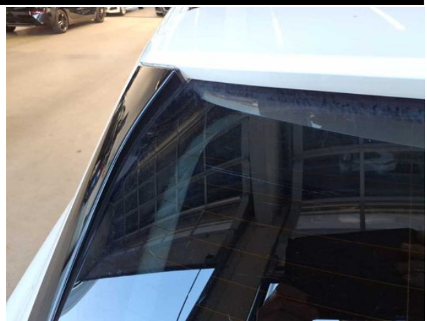
Beschädigung #8: Verglasung: Heckscheibe - Kratzer - erneuern
