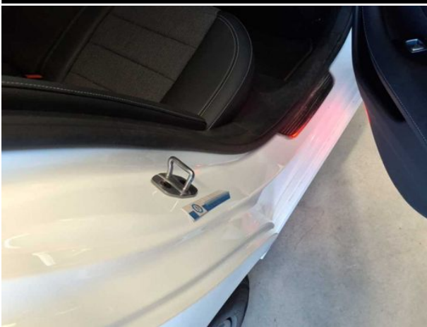
Beschädigung #4: Seitenwand rechts: Einstieg - Delle(n) - instandsetzen und lackieren
