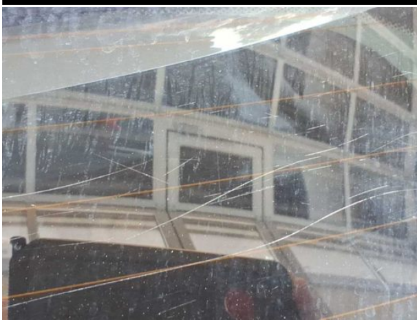
Beschädigung #8: Verglasung: Heckscheibe - Kratzer - erneuern
