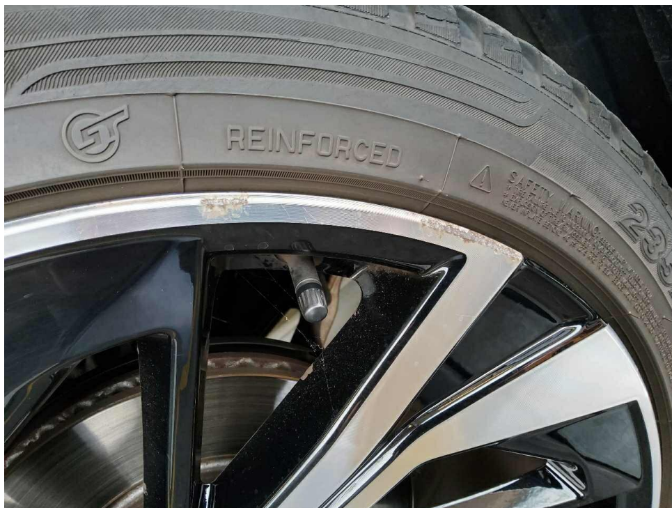
Bild 15 : Alufelge vorne links verschrammt
