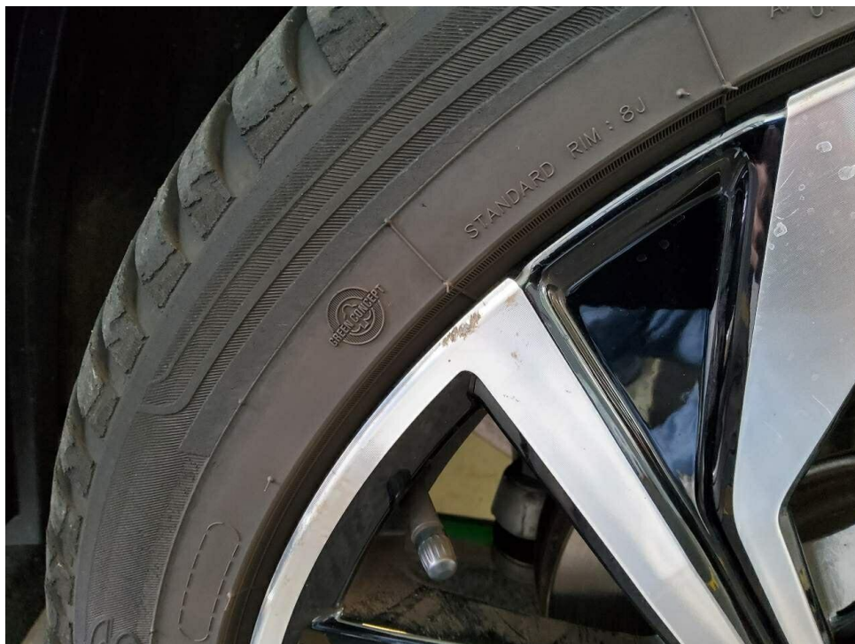
Bild 20 : Alufelge vorne rechts verschrammt
