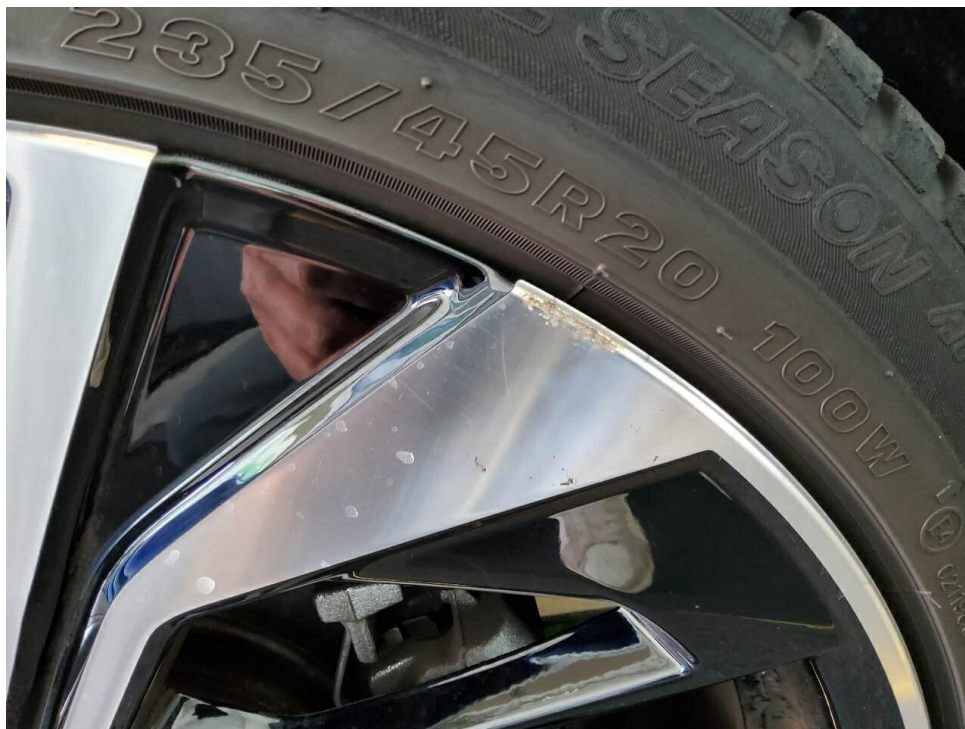
Bild 19 : Alufelge vorne rechts verschrammt
