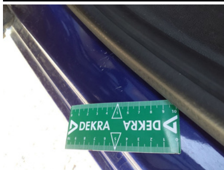
Entrée de porte / Arrière Gauche / Rayure
