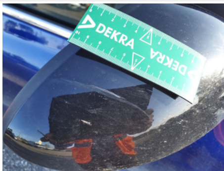
Coquille de rétroviseur / Droit / Rayure
