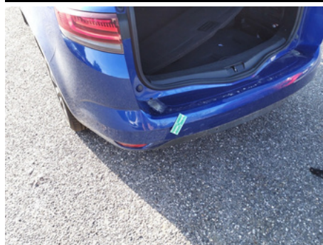
Pare-chocs / Arrière / Enfoncement
