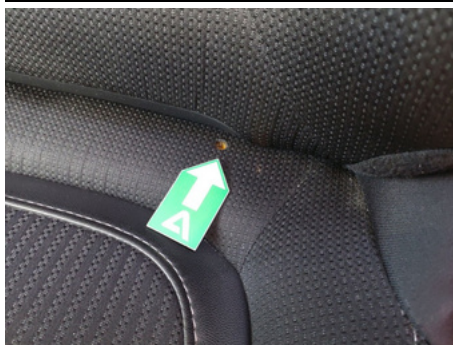
Assise de siège / Avant Gauche / Brûlé
