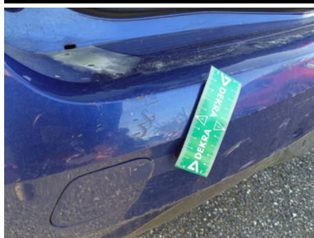
Pare-chocs / Arrière / Enfoncement
