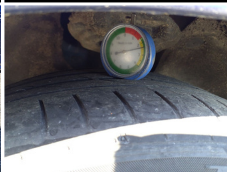
Pneu / Avant Gauche / Usé
