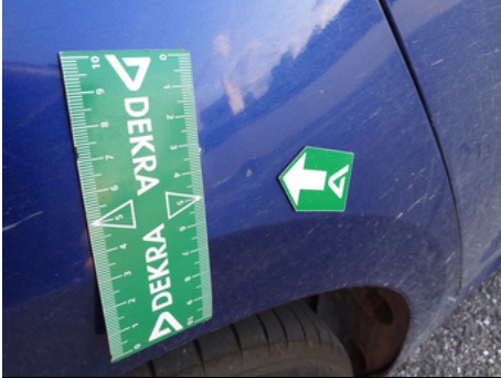
Aile / Arrière Droit / Enfoncement
