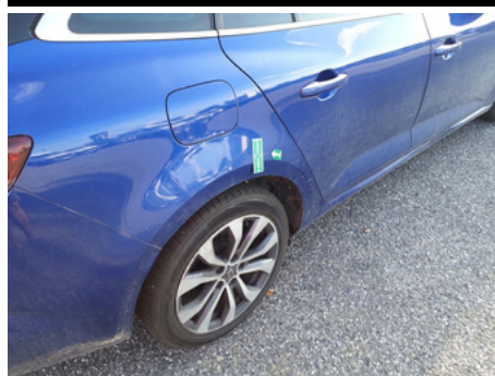
Aile / Arrière Droit / Enfoncement
