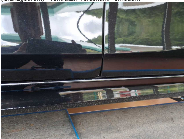
Beschädigung #9: Tür vorn links: Tür (unterhalb) - verformt - instandsetzen und lackieren
