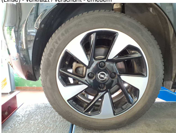
Beschädigung #7: Rad/Reifen: Leichtmetallfelge hinten rechts (Glanzgedreht) - verkratzt / verschürft - erneuern
