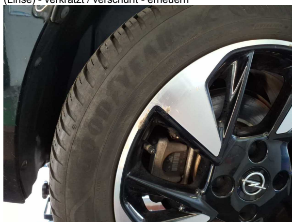
Beschädigung #7: Rad/Reifen: Leichtmetallfelge hinten rechts (Glanzgedreht) - verkratzt / verschürft - erneuern
