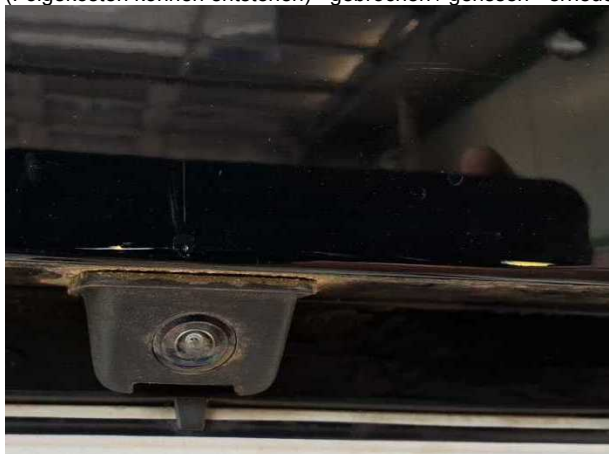
Beschädigung #5: elektronische Systeme: Rückfahrkamera (Linse) - verkratzt / verschürft - erneuern
