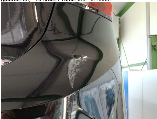
Beschädigung #10: Stossfänger hinten: Stossfänger hinten (gebrochen) - verkratzt / verschürft - erneuern
