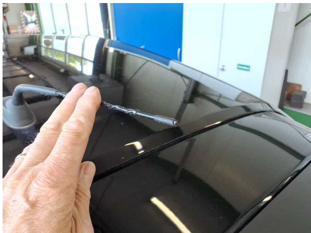
Beschädigung #1: Fahrzeugdach: Antennenstab - Marderschaden - erneuern
