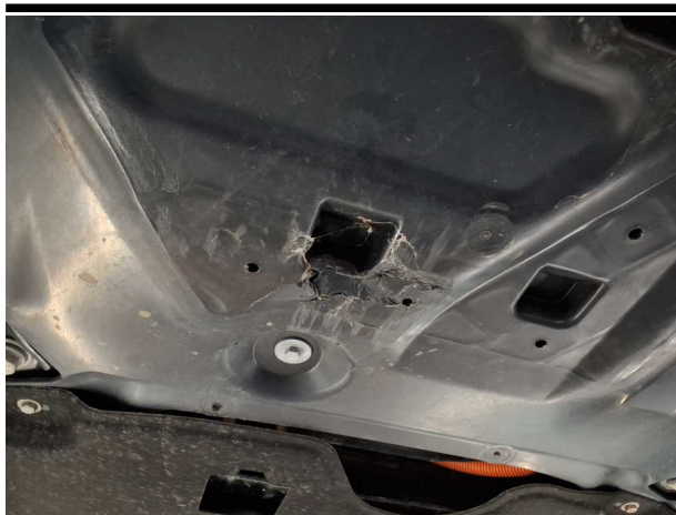
Beschädigung #4: Karosserie: Unterbodenverkleidung (Folgekosten können entstehen) - gebrochen / gerissen - erneuern
