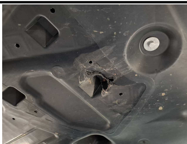
Beschädigung #4: Karosserie: Unterbodenverkleidung (Folgekosten können entstehen) - gebrochen / gerissen -
