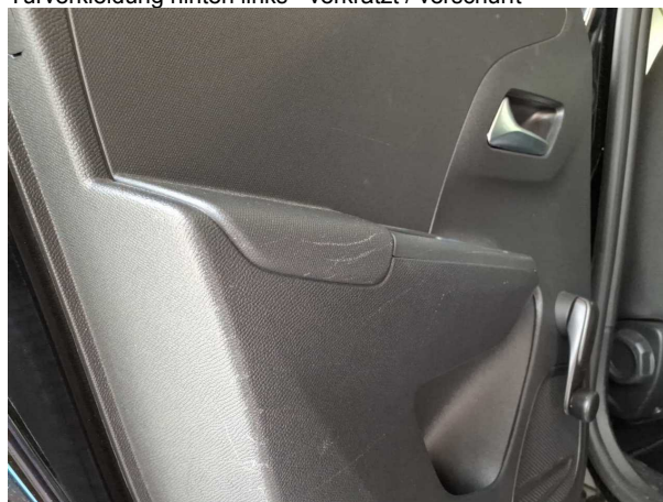
Beschädigung #2: Verkleidungen/Abdeckungen: Türverkleidung hinten links - verkratzt / verschürft -
