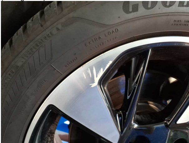
Beschädigung #8: Rad/Reifen: Leichtmetallfelge vorn rechts (Glanzgedreht) - verkratzt / verschürft - erneuern
