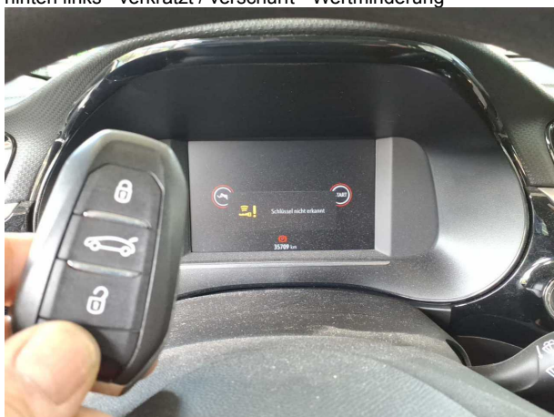
Beschädigung #3: Ausrüstung: Fahrzeugschlüssel m. Fernb. - ohne Funktion - befunden ggf. instandsetzen
