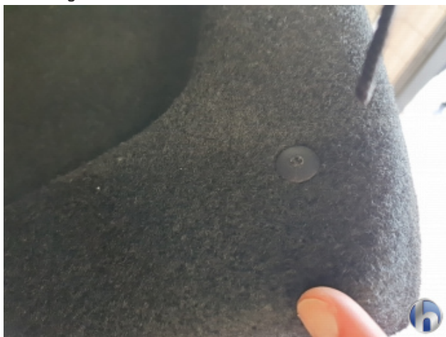
14. Befestigung Hutablage Beschädigt - Erneuern
