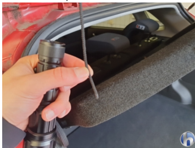
14. Befestigung Hutablage Beschädigt - Erneuern
