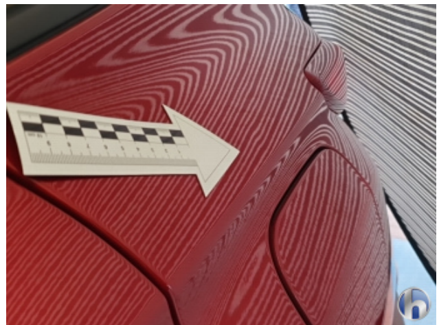
9. Seitenwand - Hinten - Links 1 Delle - Sanft Instandsetzen
