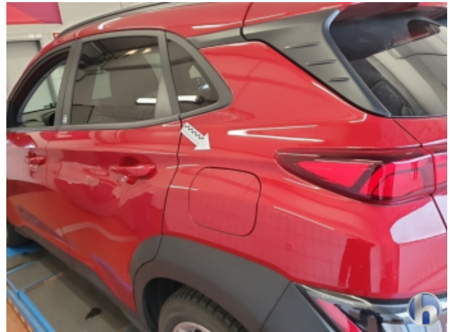
9. Seitenwand - Hinten - Links 1 Delle - Sanft Instandsetzen
