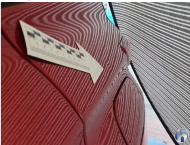
9. Seitenwand - Hinten - Links 1 Delle - Sanft Instandsetzen
