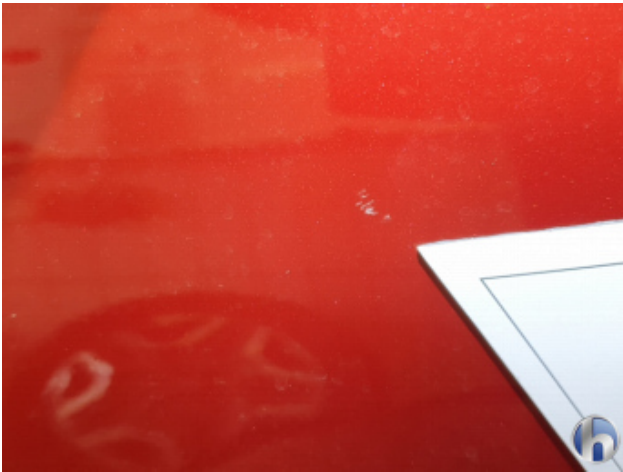
8. Tür Hinten - Rechts Beschädigt - Lackieren
