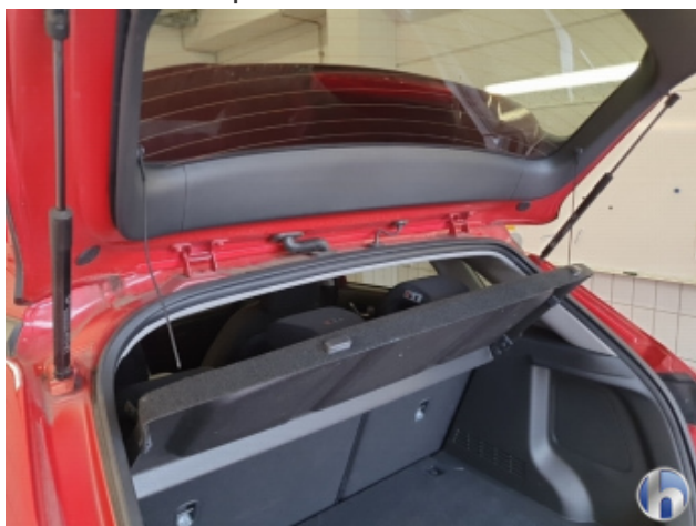
14. Befestigung Hutablage Beschädigt - Erneuern
