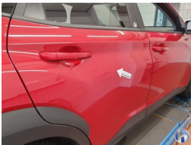
8. Tür Hinten - Rechts Beschädigt - Lackieren
