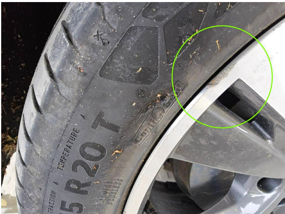
Bild 10 : Reifen hinten rechts, beschädigt
