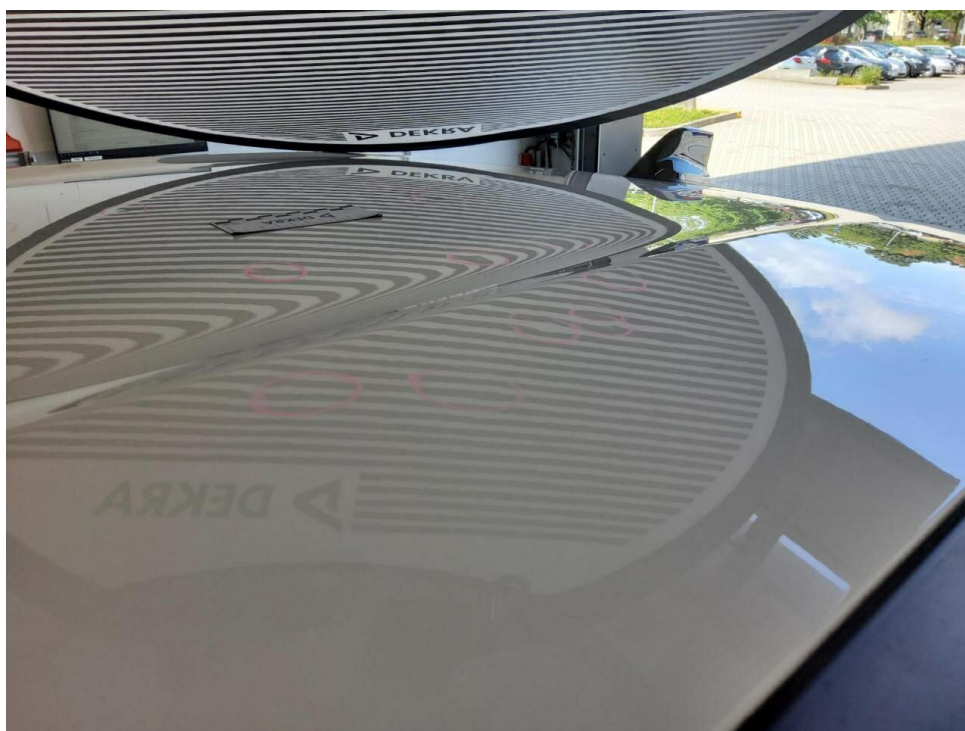
Bild 18 : Dach, mehrfach eingedellt, drücken 50 Dellen
