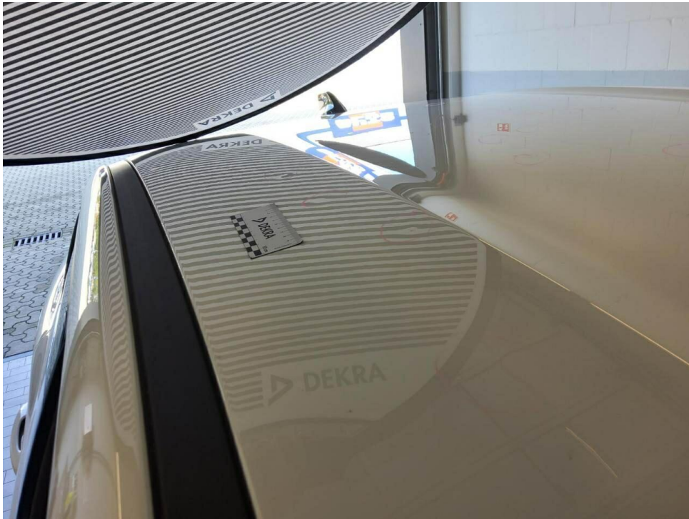
Bild 23 : Dach, mehrfach eingedellt, drücken 50 Dellen
