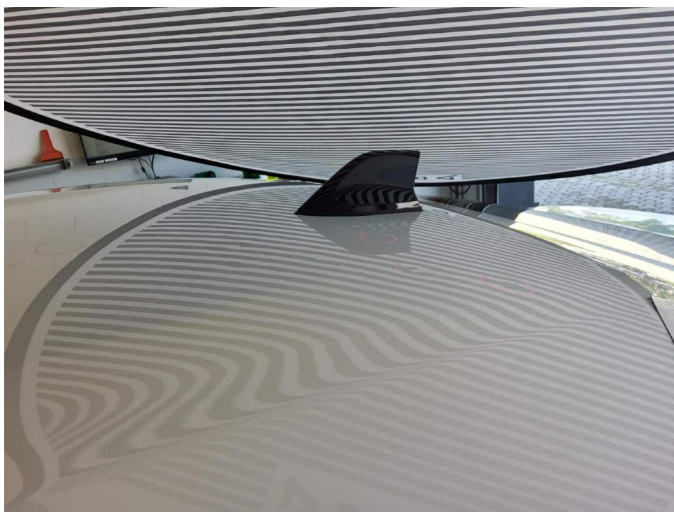
Bild 20 : Dach, mehrfach eingedellt, drücken 50 Dellen
