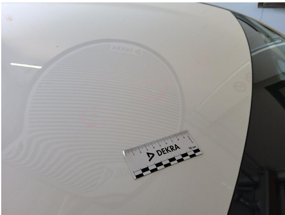
Bild 24 : Dach, mehrfach eingedellt, drücken 50 Dellen
