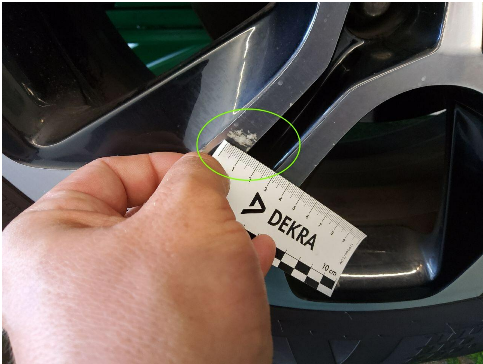
Bild 29 : Felge vorn rechts, leichte Korrosion
