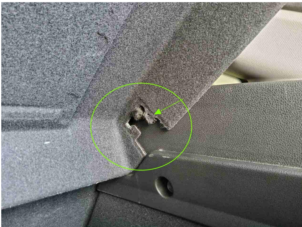
Bild 16 : Hutablage, Aufnahme rechts gebrochen und nicht vollständig
