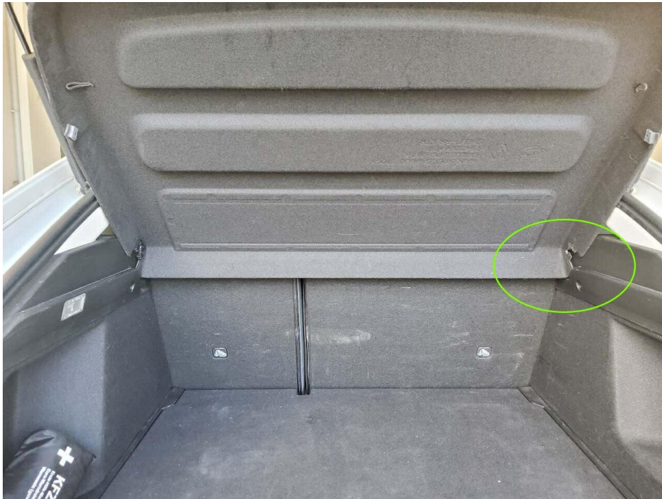
Bild 15 : Hutablage, Aufnahme rechts gebrochen und nicht vollständig
