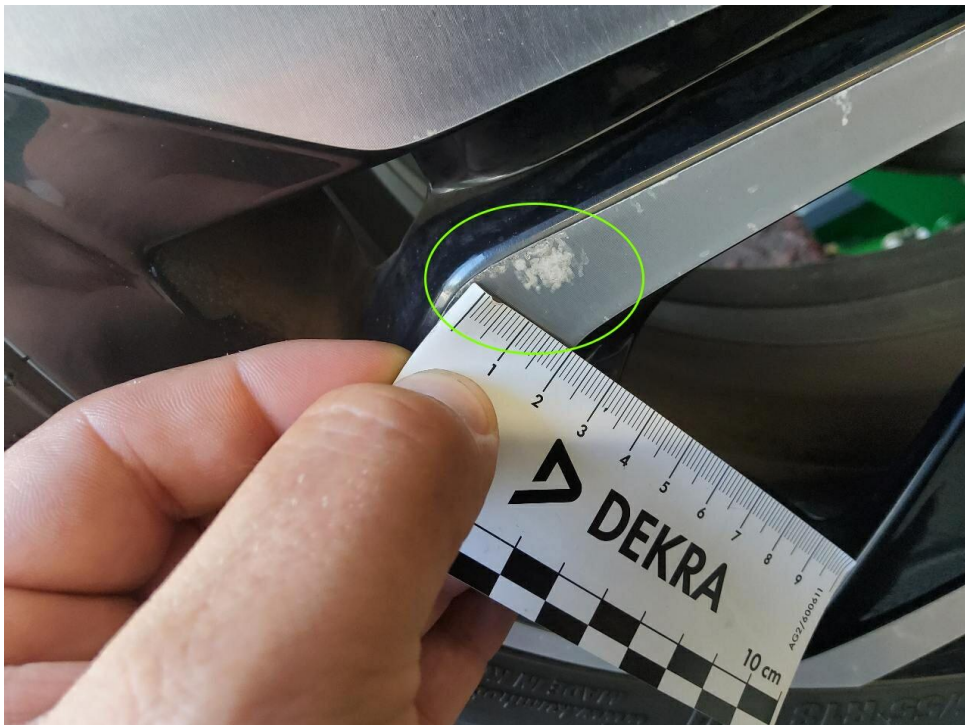
Bild 30 : Felge hinten rechts, leichte Korrosion
