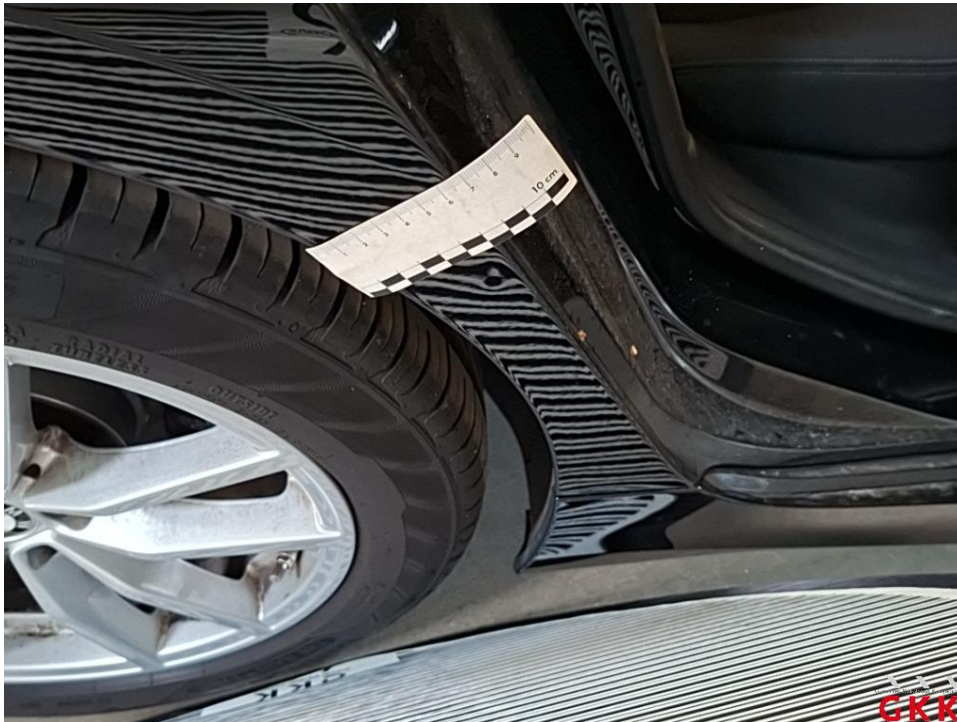
Bild 33 Seitenwand rechts, unterhalb, beschädigt, instand setzen - lackieren
