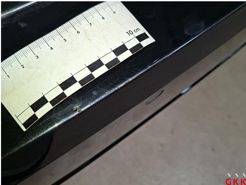
Bild 28 Stoßfänger hinten, Verkleidung -lackiert-, verkratzt, lackieren
