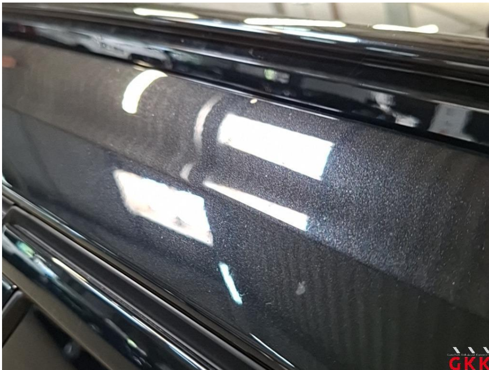
Bild 36 Fahrzeug, außen, Anhaftungsspuren, aufbereiten
