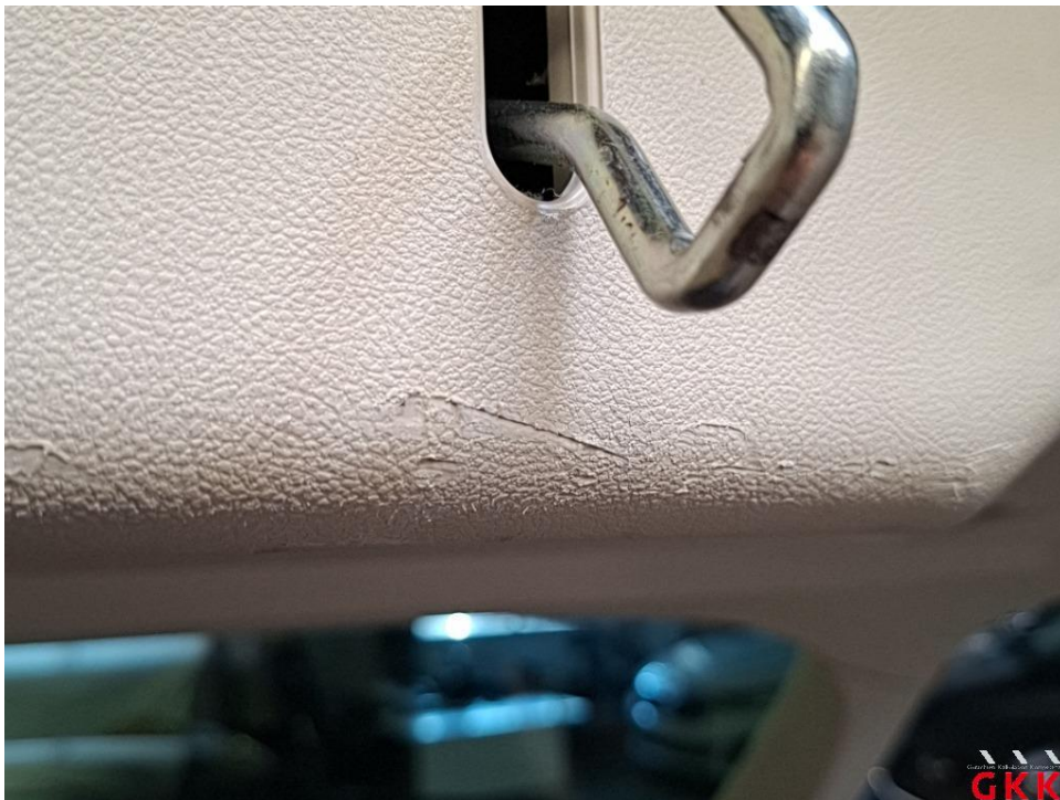
Bild 32 Heckklappe, Innenverkleidung, beschädigt, ersetzen
