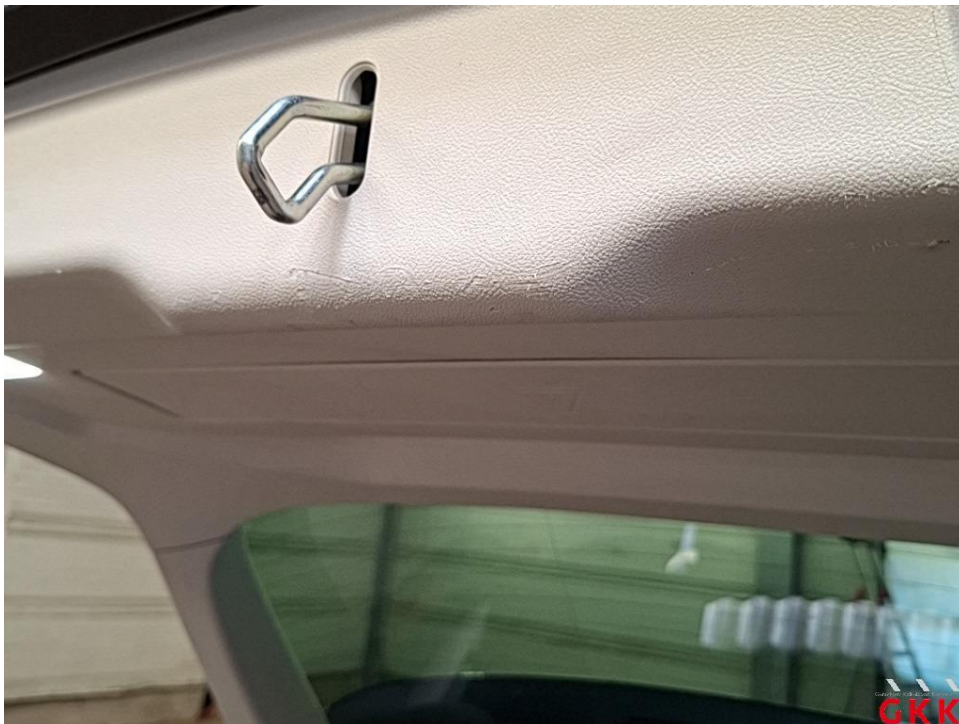
Bild 30 Heckklappe, Innenverkleidung, beschädigt, ersetzen
