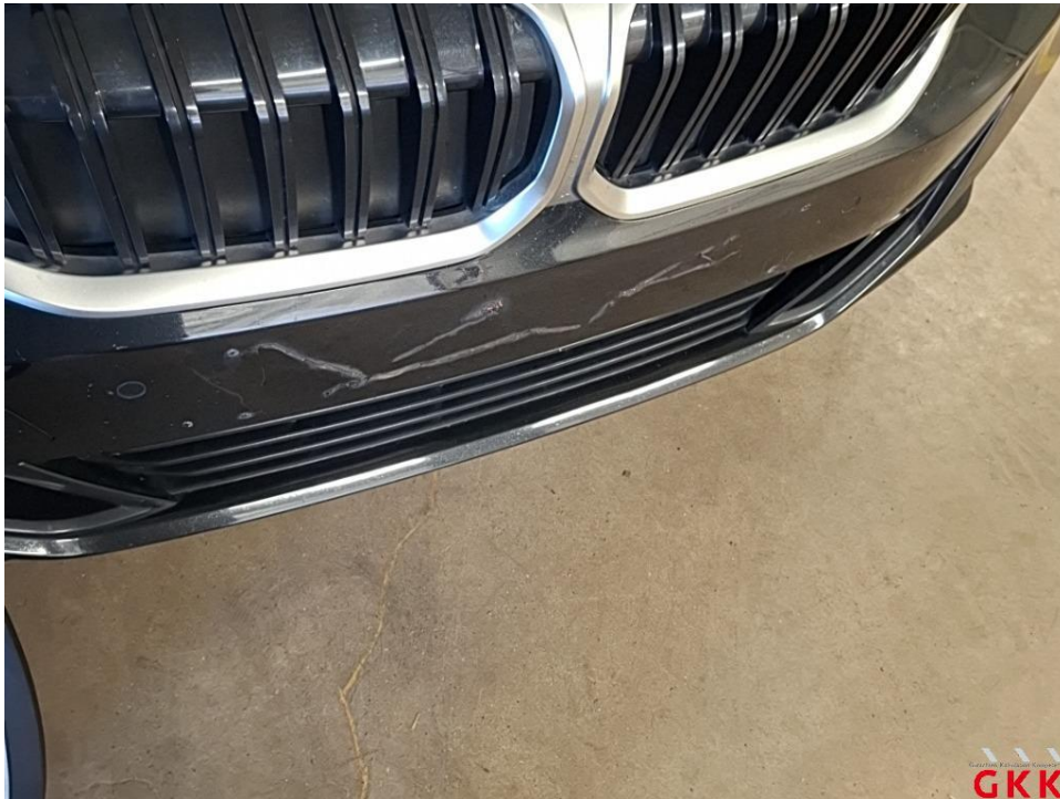
Bild 17 Stoßfänger vorne, Verkleidung -lackiert-, gerissen, ersetzen
