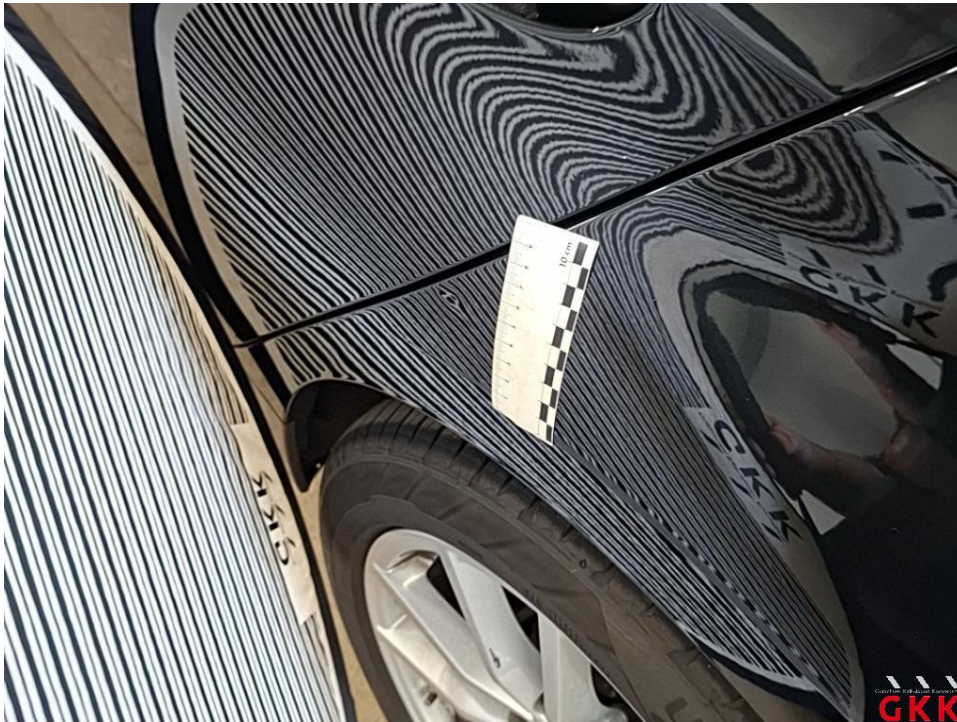
Bild 25 Seitenwand links, hinten -unterhalb-, beschädigt, kalt drücken
