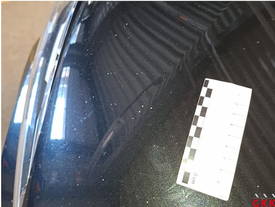
Bild 21 Motorhaube, Steinschlag, lackieren
