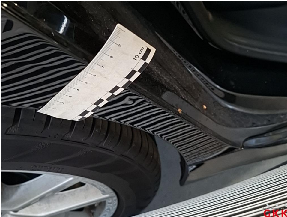
Bild 34 Seitenwand rechts, unterhalb, beschädigt, instand setzen - lackieren
