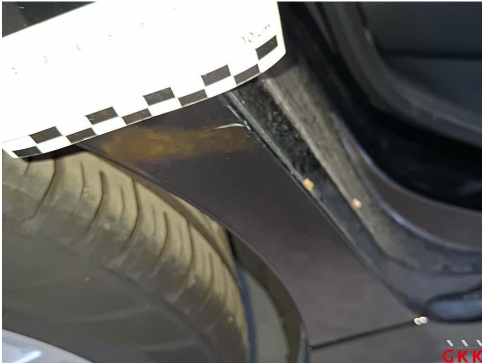
Bild 35 Seitenwand rechts, unterhalb, beschädigt, instand setzen - lackieren
