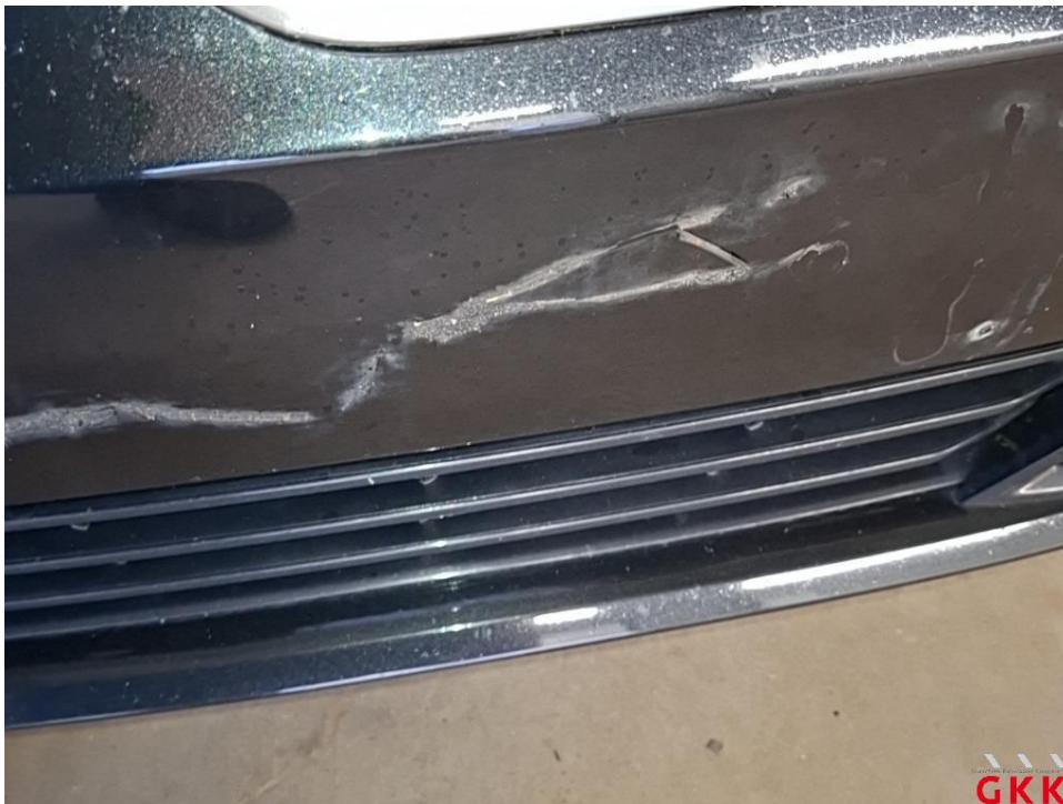
Bild 18 Stoßfänger vorne, Verkleidung -lackiert-, gerissen, ersetzen
