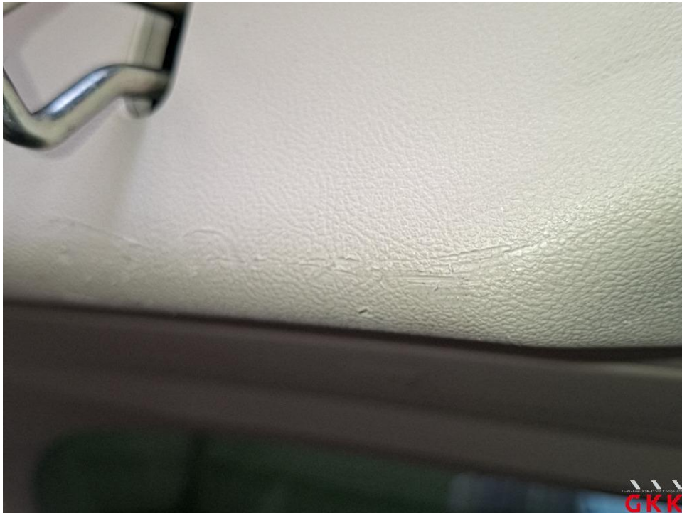
Bild 31 Heckklappe, Innenverkleidung, beschädigt, ersetzen
