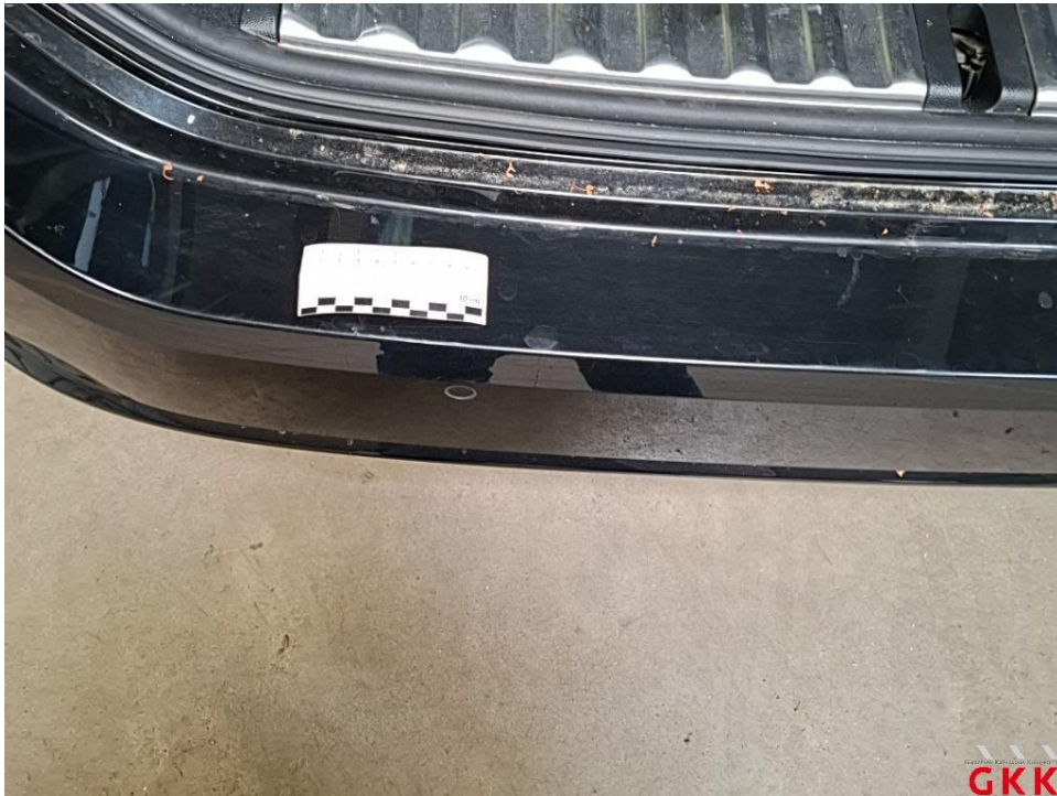
Bild 27 Stoßfänger hinten, Verkleidung -lackiert-, verkratzt, lackieren
