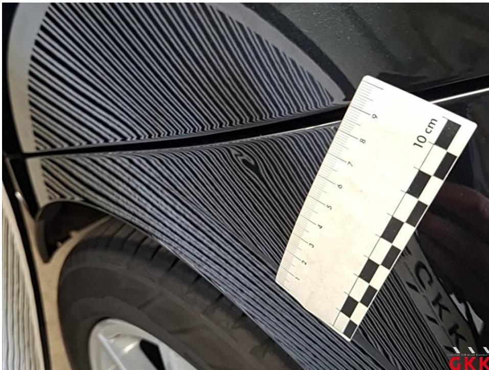
Bild 26 Seitenwand links, hinten -unterhalb-, beschädigt, kalt drücken
