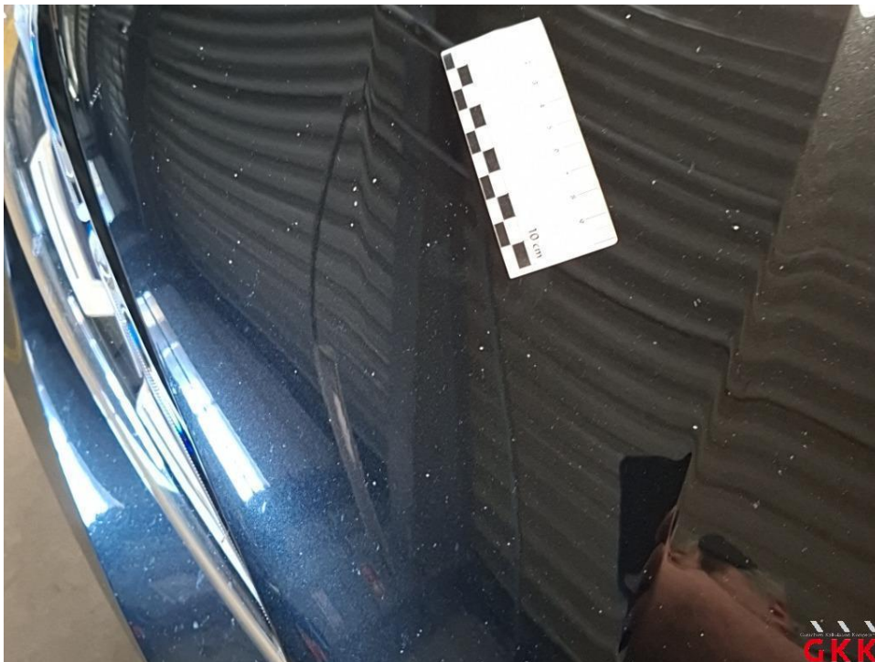
Bild 20 Motorhaube, Steinschlag, lackieren
