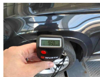
Lackstärke Kotflügel vorne links
