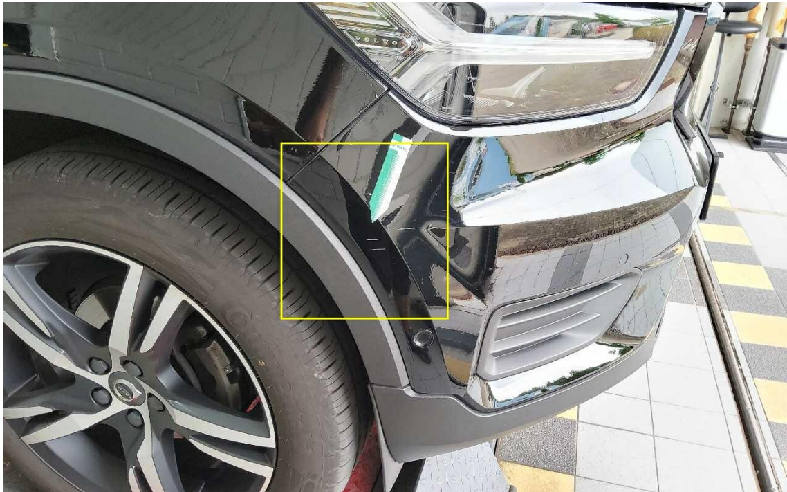
Bild 19 : Stoßfängerverkleidung vorne rechts Kratzer
