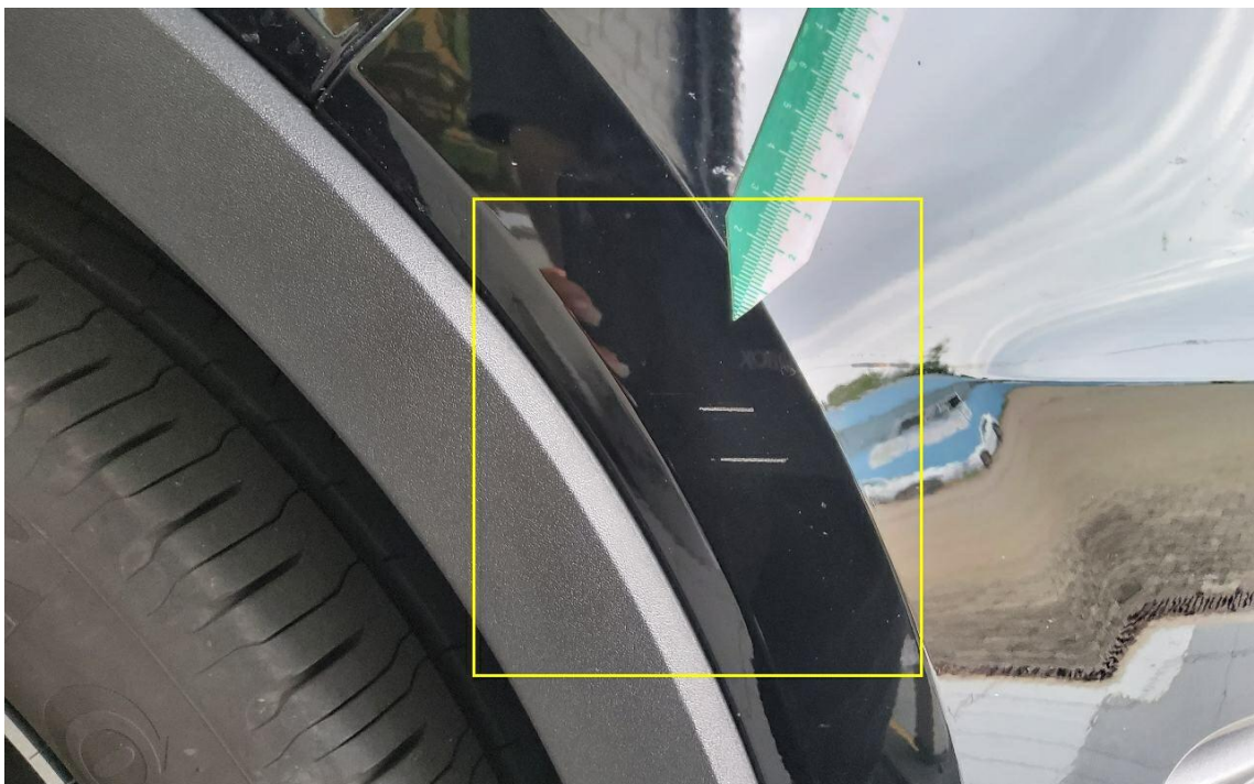
Bild 20 : Stoßfängerverkleidung vorne rechts Kratzer
