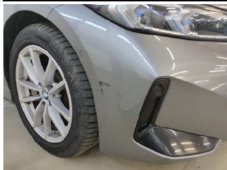
Stoßfänger / Vorne Rechts / Kratzer
