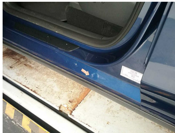
Beschädigung #1: Schweller links: Einstieg - Delle(n) - sanft instandsetzen
