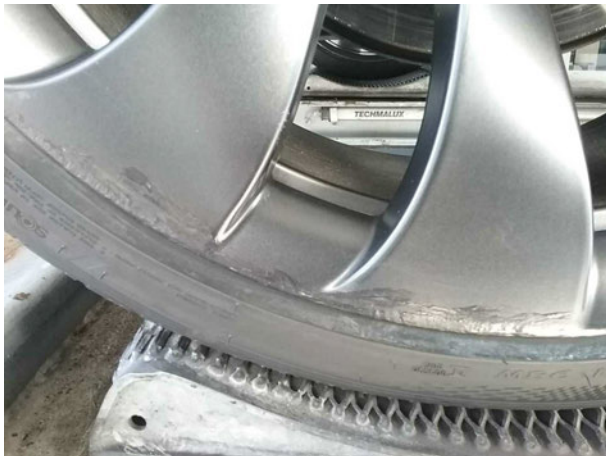
Beschädigung #6: Rad/Reifen: Leichtmetallfelge vorn links - verkratzt... verschürft - erneuern
