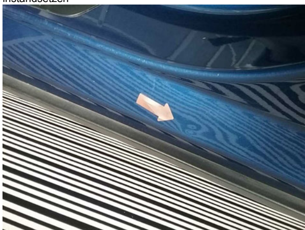
Beschädigung #1: Schweller links: Einstieg - Delle(n) - sanft instandsetzen
