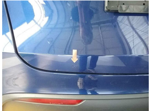
Beschädigung #3: Heckklappe/-tür: Heckklappe - verkratzt / verschürft - instandsetzen und lackieren
