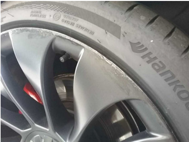
Beschädigung #5: Rad/Reifen: Leichtmetallfelge hinten rechts - verkratzt / verschürft - erneuern
