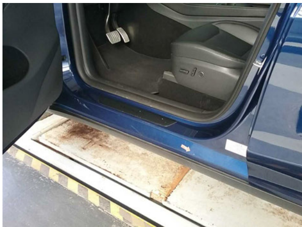
Beschädigung #1: Schweller links: Einstieg - Delle(n) - sanft instandsetzen
