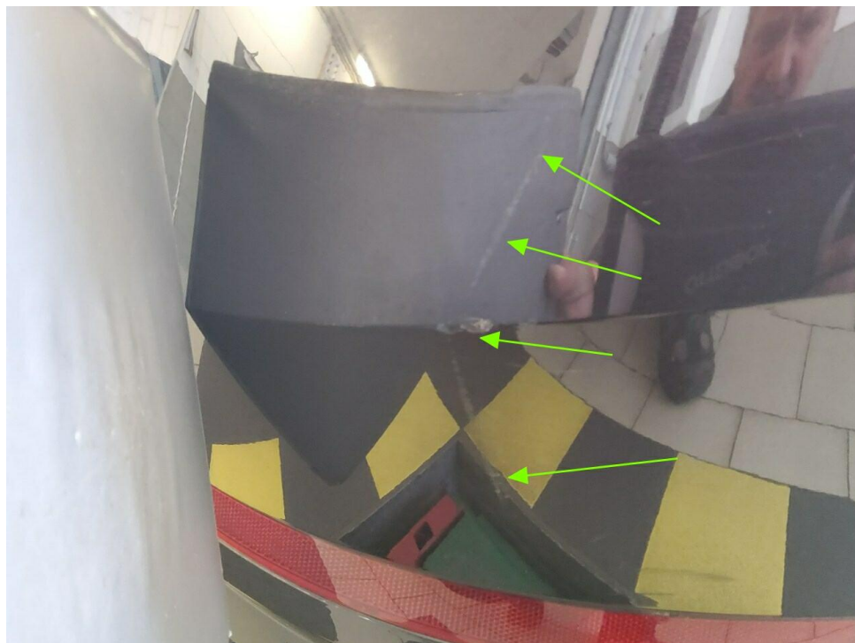
Bild 18 : Stoßfänger hinten, verschrammt, lackieren mit Lackaufbau
