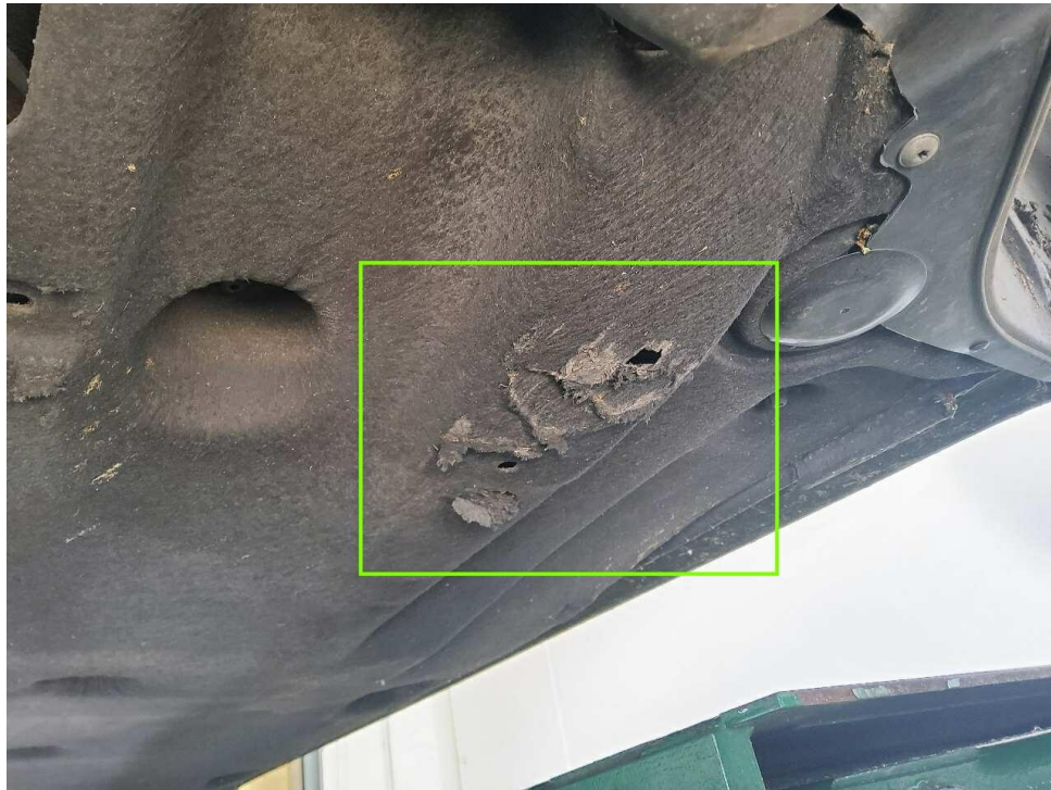
Bild 15 : Verkleidung Unterboden zerbrochen/zerrissen
