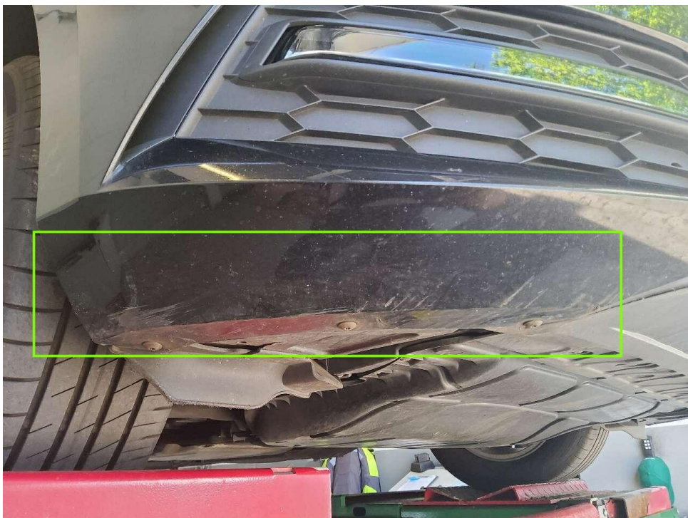
Bild 20 : Stoßfänger vorne, eingedellt, instandsetzen und lackieren mit Lackaufbau
