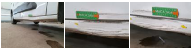
Moulure porte AVD, Déformé / Forcé, E - Remplacer
