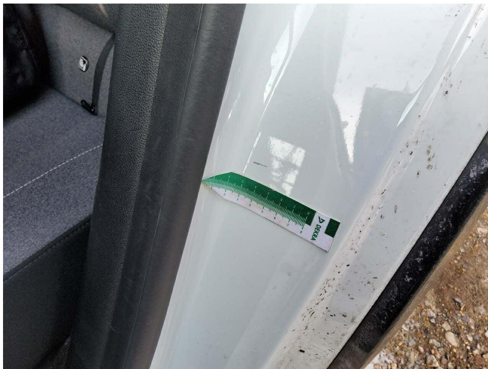
Bild 11 : Tür hinten links Einstieg Lackierung, zerkratzt, smart repair
