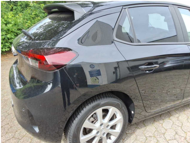
Beschädigung #2: Seitenwand rechts: Seitenwand - Delle(n) - sanft instandsetzen
