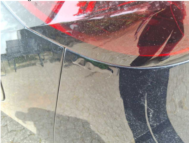
Beschädigung #5: Stossfänger hinten: Stossfänger hinten - Lackmangel - lackieren
