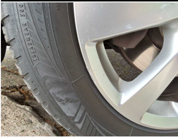
Beschädigung #3: Rad/Reifen: Leichtmetallfelge vorn links (Materialabrieb) - Kratzer - erneuern
