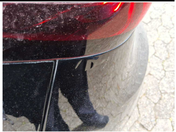
Beschädigung #5: Stossfänger hinten: Stossfänger hinten - Lackmangel - lackieren
