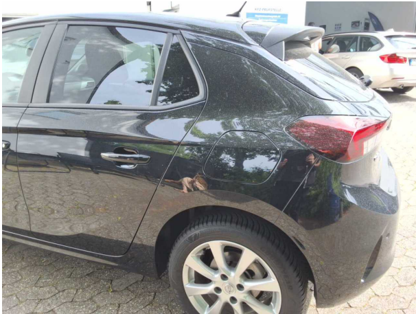
Beschädigung #1: Seitenwand links: Seitenwand - Kratzer - Smart Repair
