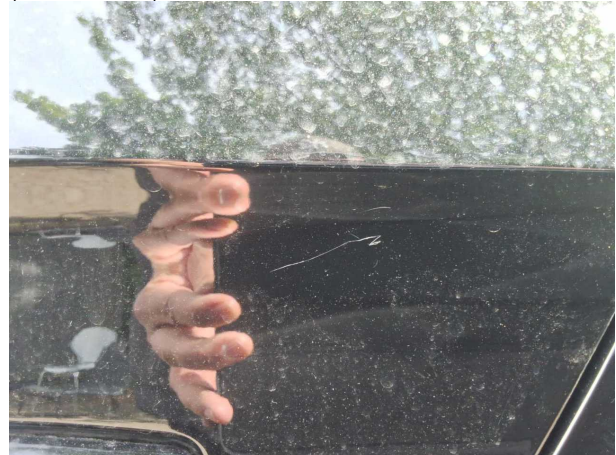
Beschädigung #4: Tür hinten links: Tür - Kratzer - lackieren
