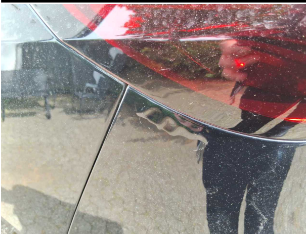
Beschädigung #5: Stossfänger hinten: Stossfänger hinten - Lackmangel - lackieren
