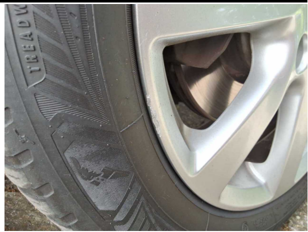
Beschädigung #3: Rad/Reifen: Leichtmetallfelge vorn links (Materialabrieb) - Kratzer - erneuern
