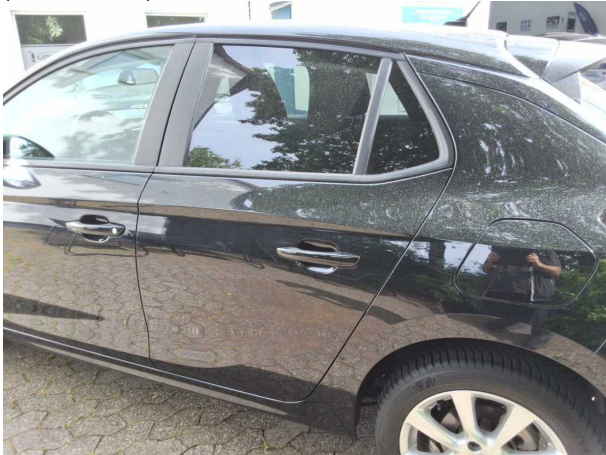
Beschädigung #4: Tür hinten links: Tür - Kratzer - lackieren
