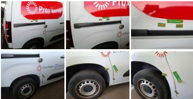
Sliding door R, Scratch(es), Paint
