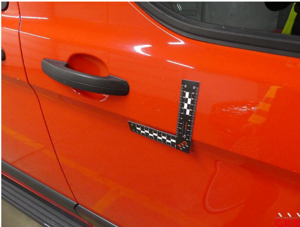
Bild 18 Tür vorne rechts, beschädigt, instand setzen - lackieren
