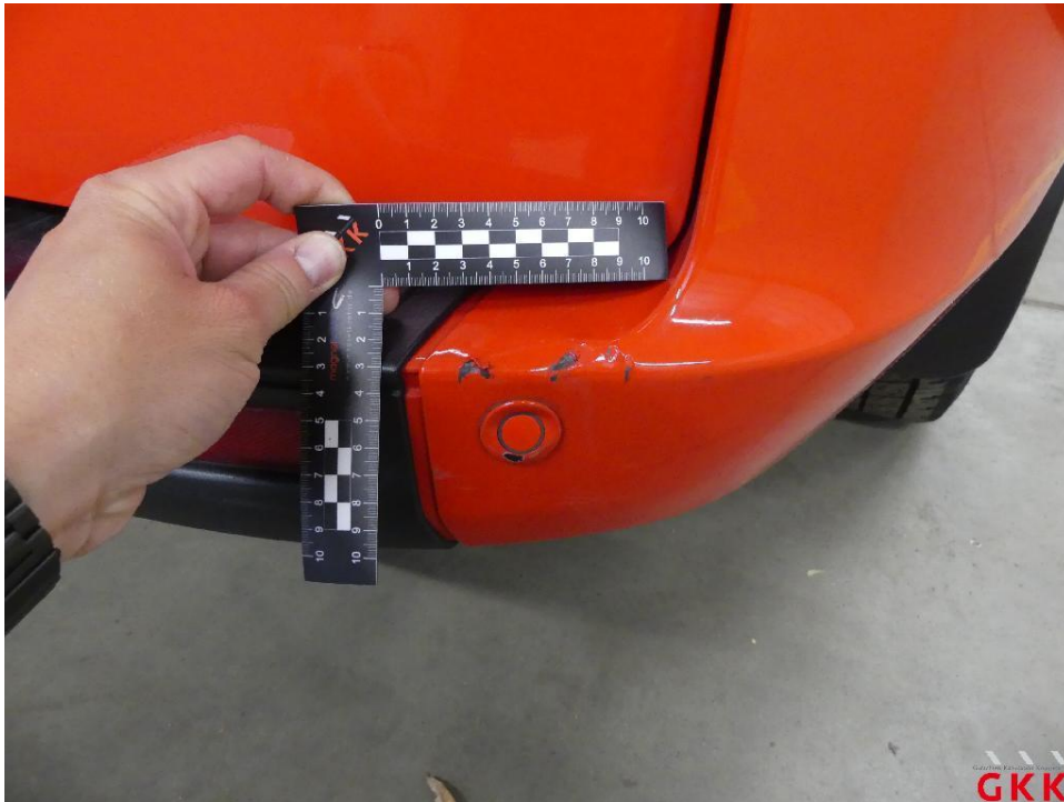
Bild 23 Stoßfänger hinten, Ecke rechts -lackiert-, beschädigt, ersetzen
