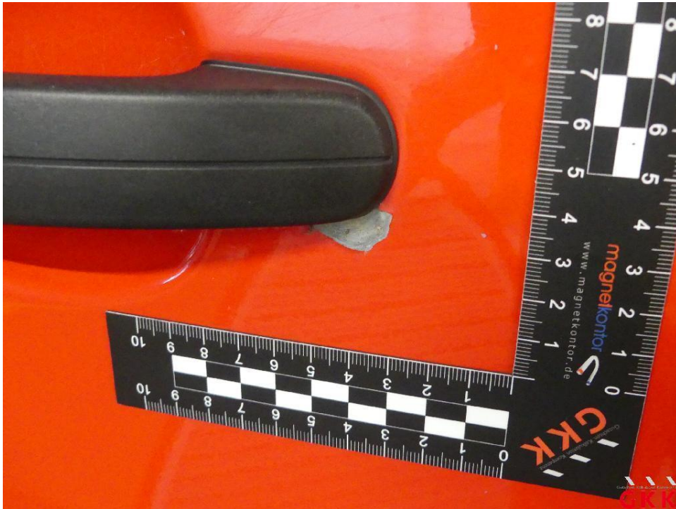
Bild 27 Hecktür rechts, Lackierung abgeplatzt, lackieren
