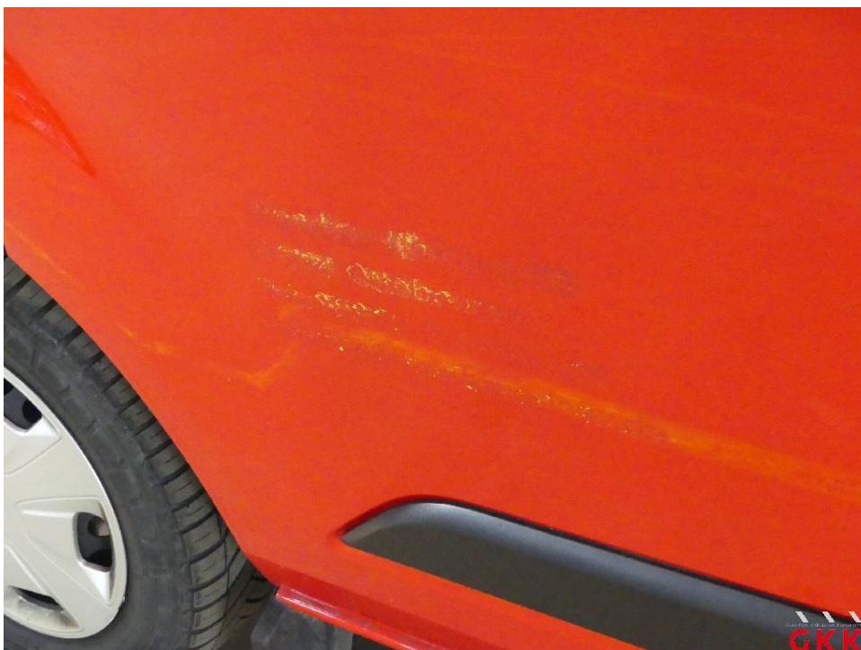
Bild 14 Fahrzeug, außen, Lackierung verwittert / matt, aufbereiten
