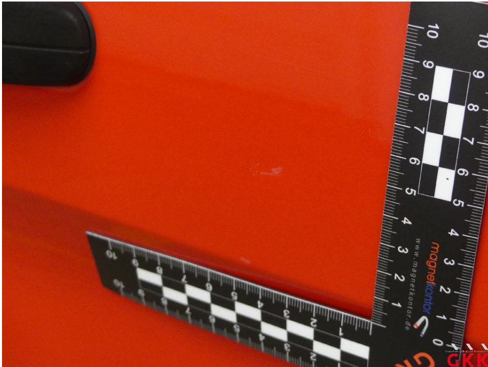
Bild 19 Tür vorne rechts, beschädigt, instand setzen - lackieren
