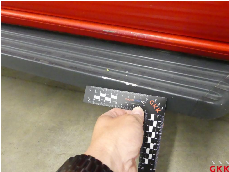
Bild 21 Trittbrett, verkratzt, Smartrepair
