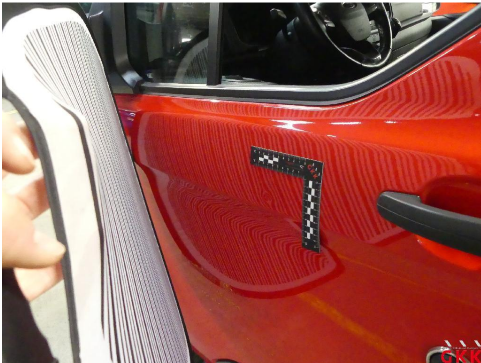
Bild 28 Tür vorne links, beschädigt, instand setzen - lackieren
