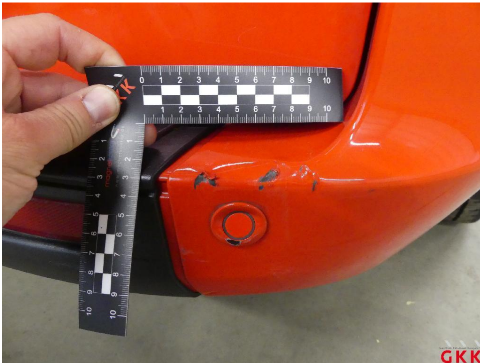
Bild 24 Stoßfänger hinten, Ecke rechts -lackiert-, beschädigt, ersetzen
