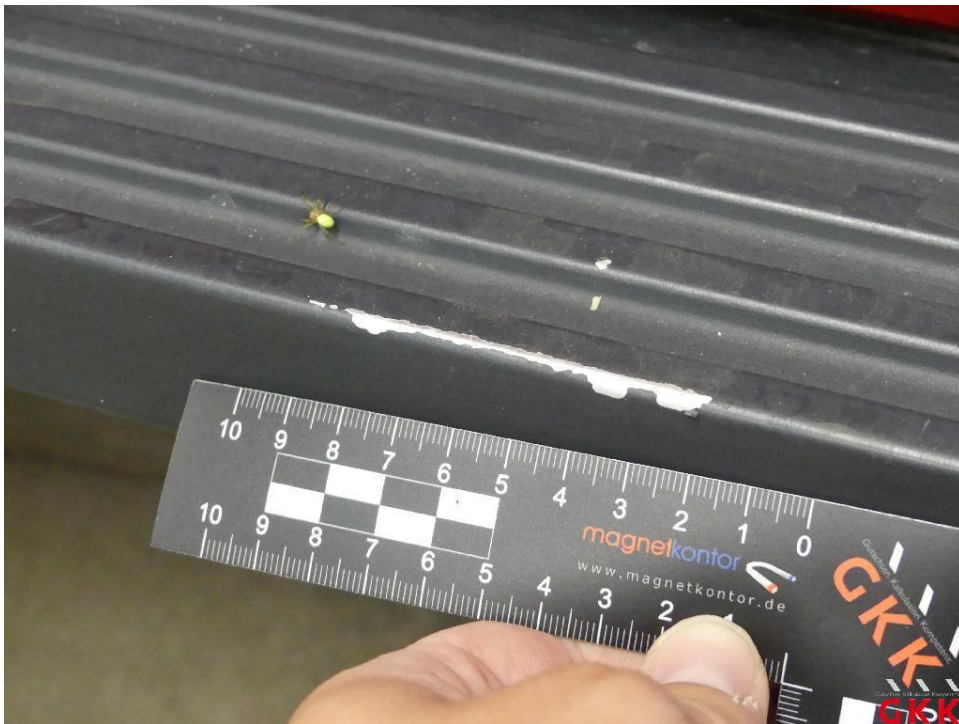
Bild 22 Trittbrett, verkratzt, Smartrepair
