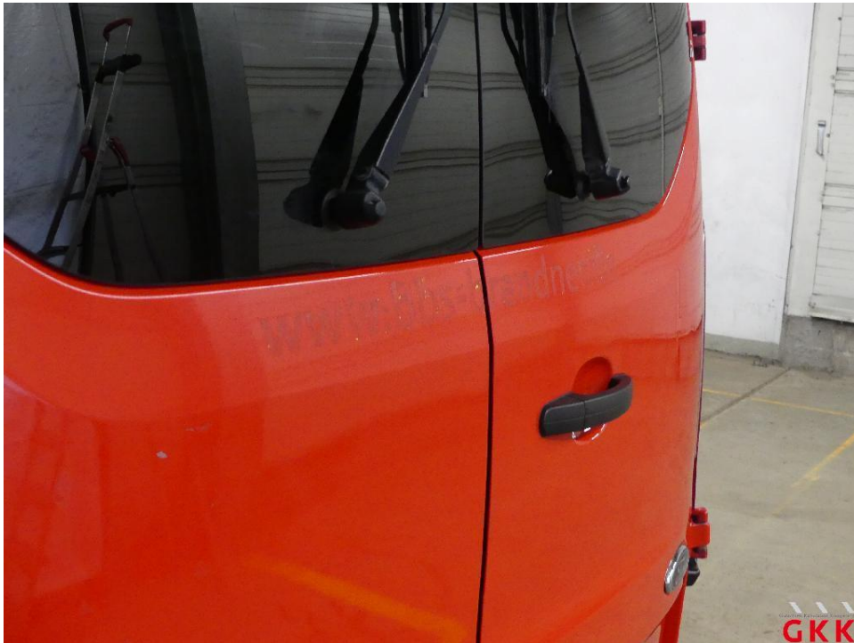
Bild 15 Fahrzeug, außen, Lackierung verwittert / matt, aufbereiten
