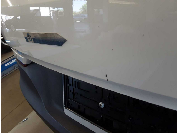
Damage 3: Boot lid / rear door: Boot lid - Scratch(es) - Paint
