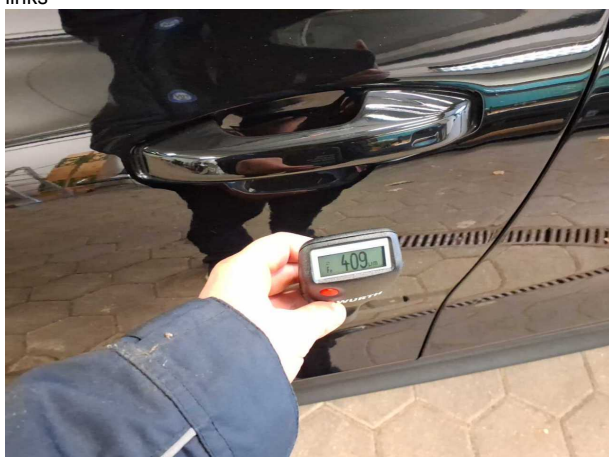
Nacklackierung 1: Seitenwand links, Seitenwand rechts, Tür vorne links
