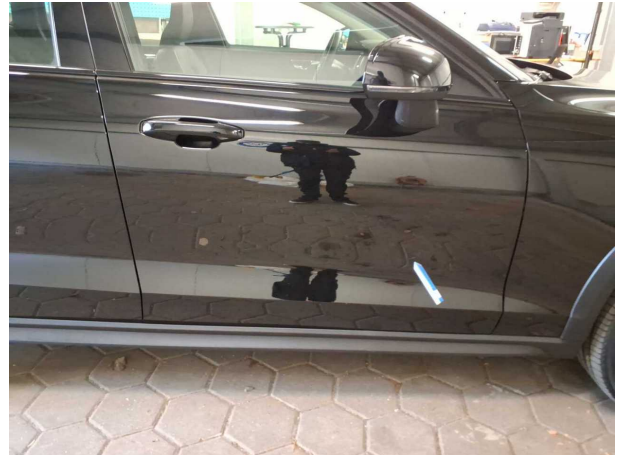
Beschädigung #4: Tür vorn rechts: Tür - Kratzer - lackieren
