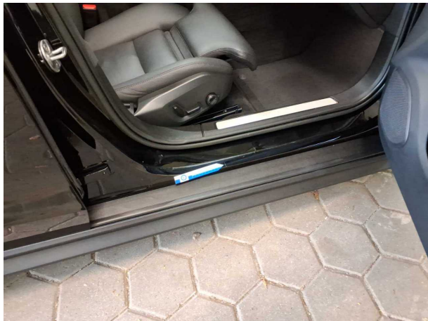
Beschädigung #1: Schweller rechts: Einstieg - Kratzer - Smart Repair
