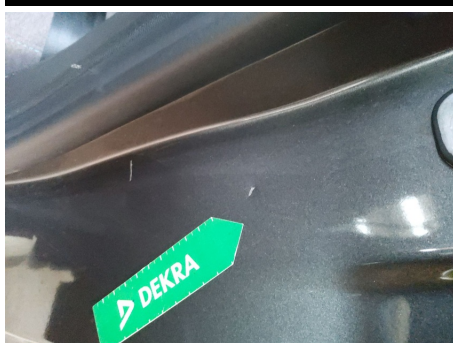
Travesaño de la puerta / Trasero Izquierdo / Abolladura
