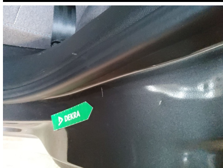
Travesaño de la puerta / Trasero Izquierdo / Abolladura
