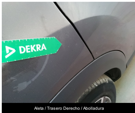
Aleta / Trasero Derecho / Abolladura
