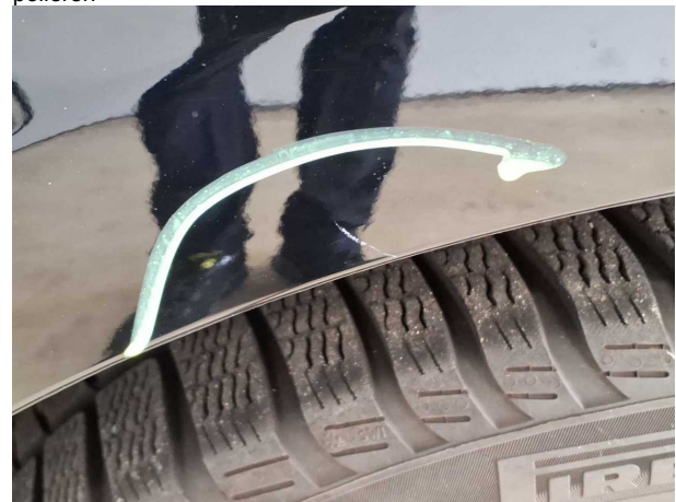
Beschädigung #5: Seitenwand links: Seitenwand - verkratzt / verschürft - auslegen / polieren
