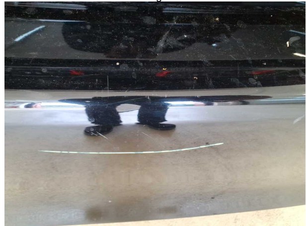
Beschädigung #3: Stossfänger hinten: Stossfänger hinten - Kratzer - auslegen / polieren
