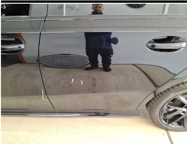
Beschädigung #4: Tür hinten links: Tür - Kratzer - auslegen / polieren
