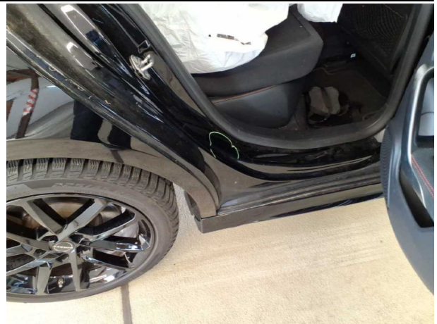
Beschädigung #9: Seitenwand rechts: Einstieg - Delle / Lackschaden - Smart Repair
