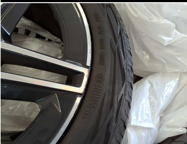
Beschädigung #8: 2.Radsatz: 1 Leichtmetallfelge - verkratzt / verschürft - Wertminderung
