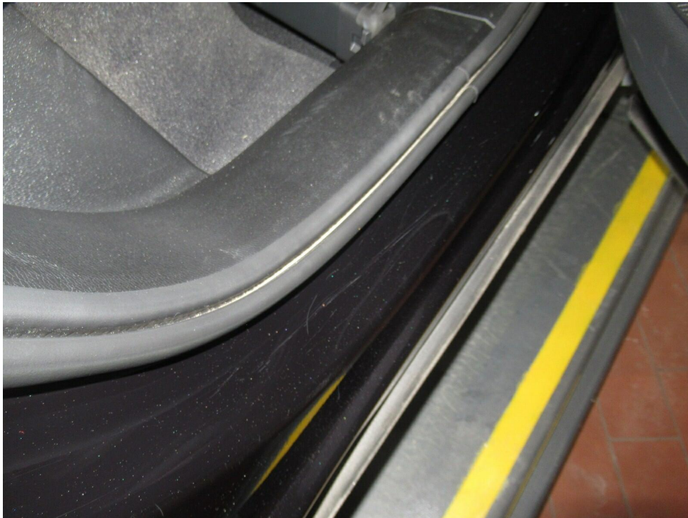
Bild 13 : Einstieg hinten rechts zerkratzt
