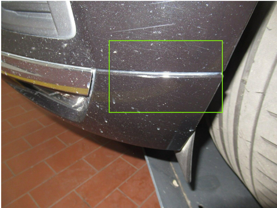
Bild 11 : Stoßfänger vorne verschrammt
