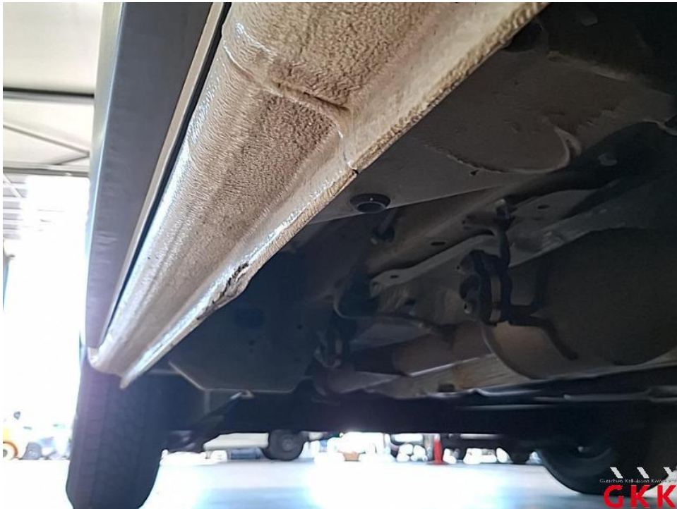
Bild 60. Schweller rechts, beschädigt, instand setzen - lackieren
