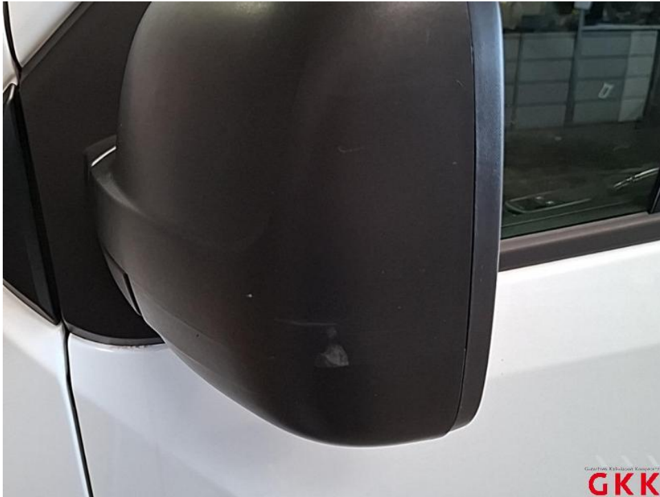
Bild 27. Spiegelgehäuse links, Kappe -unlackiert-, verkratzt, Smartrepair
