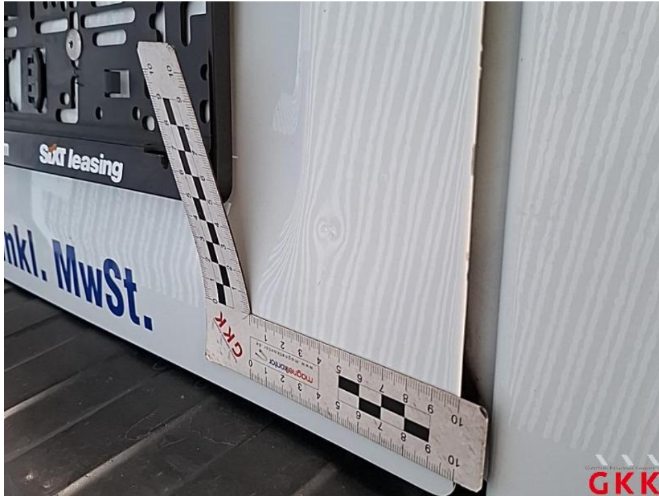
Bild 39. Hecktür links, beschädigt, instand setzen - lackieren
