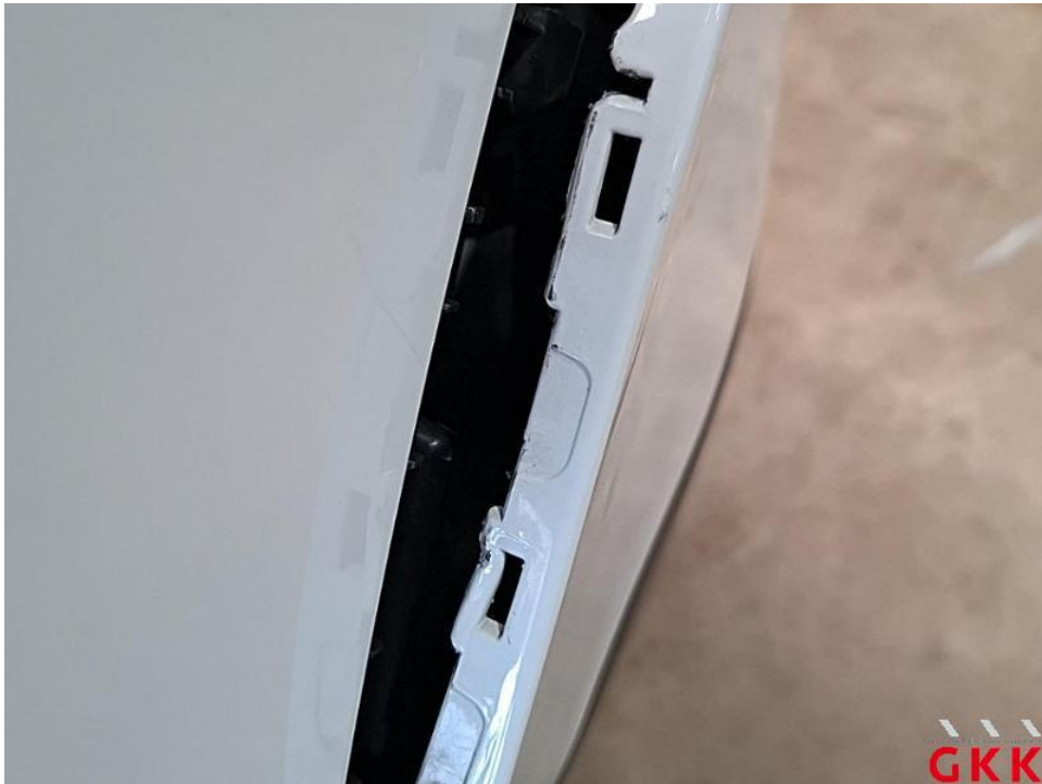
Bild 20. Stoßfänger vorne, Verkleidung -teillackiert-, Reparaturmangel, ersetzen
