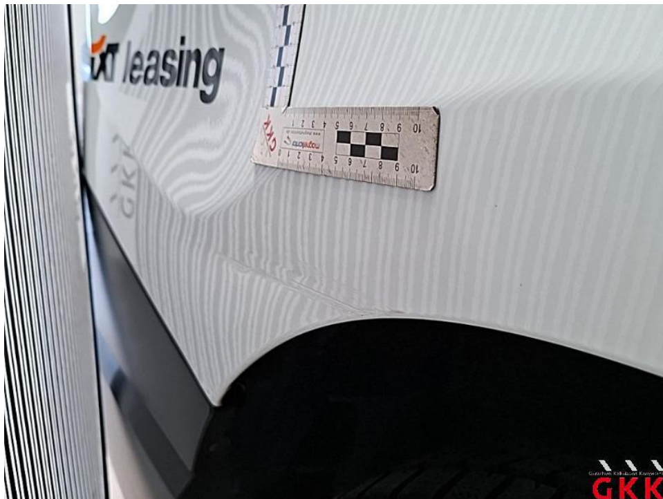
Bild 56. Seitenwand rechts, beschädigt, instand setzen - lackieren
