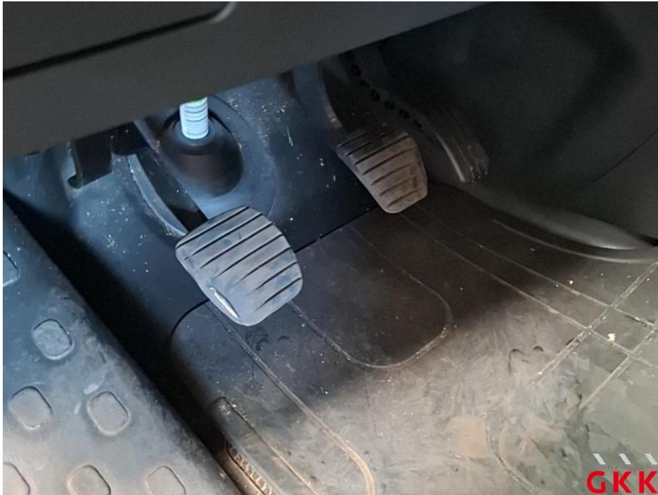
Bild 29. Kupplungspedal, Pedalgummi, beschädigt, ersetzen
