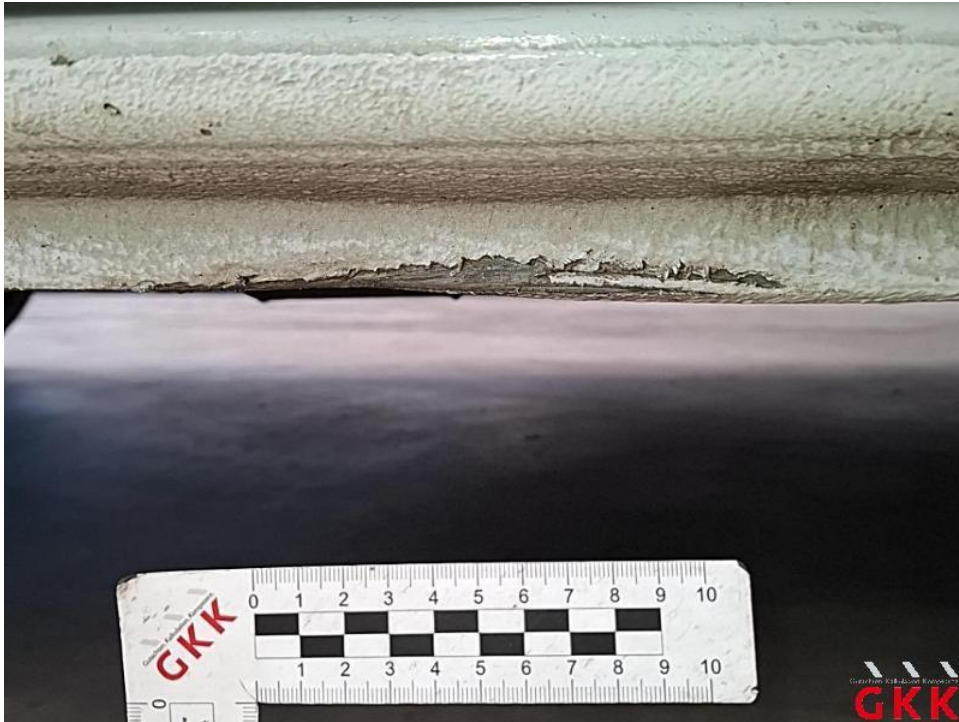
Bild 61. Schweller rechts, beschädigt, instand setzen - lackieren
