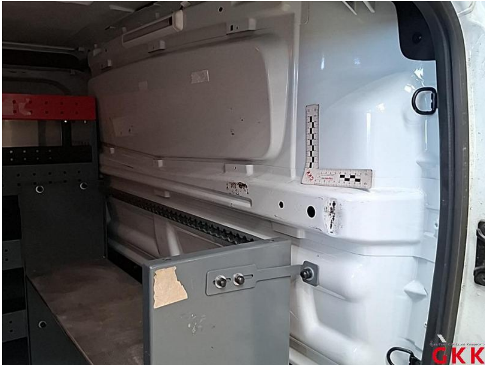
Bild 63. Trennwand, beschädigt, instand setzen - lackieren
