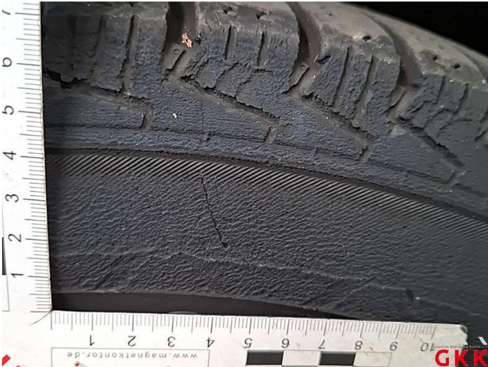
Bild 22. Reifen, vorne rechts, beschädigt und Untermaß, ersetzen
