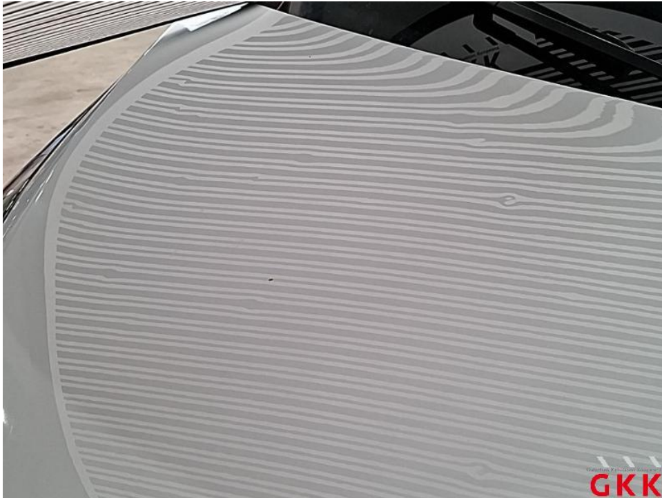
Bild 67. Fahrzeug, Hagelschaden, instand setzen
