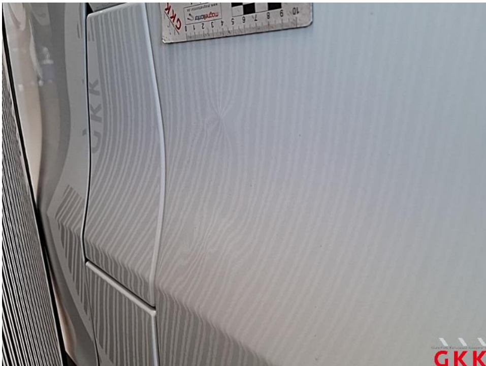
Bild 36. Seitenwand links, vorne, Reparaturmangel, instand setzen - lackieren
