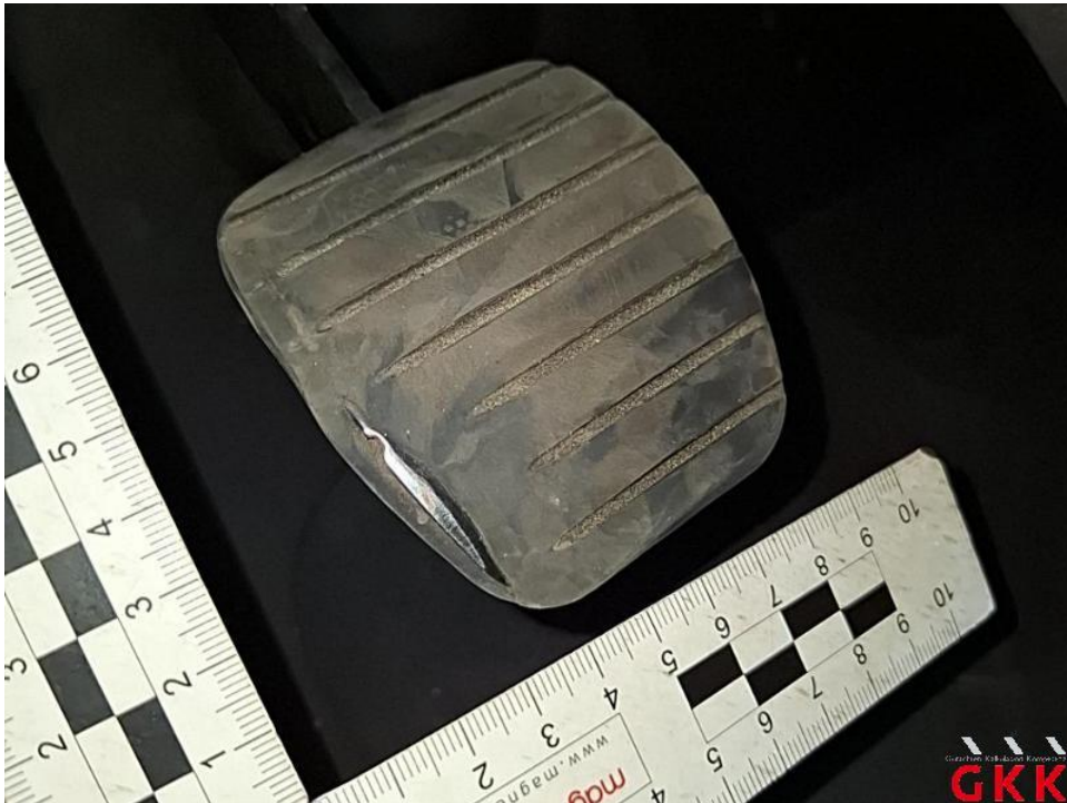
Bild 30. Kupplungspedal, Pedalgummi, beschädigt, ersetzen
