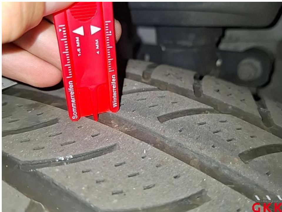
Bild 26. Reifen, vorne links, beschädigt und Untermaß, ersetzen
