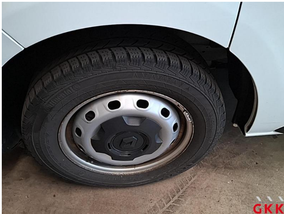
Bild 24. Reifen, vorne links, beschädigt und Untermaß, ersetzen
