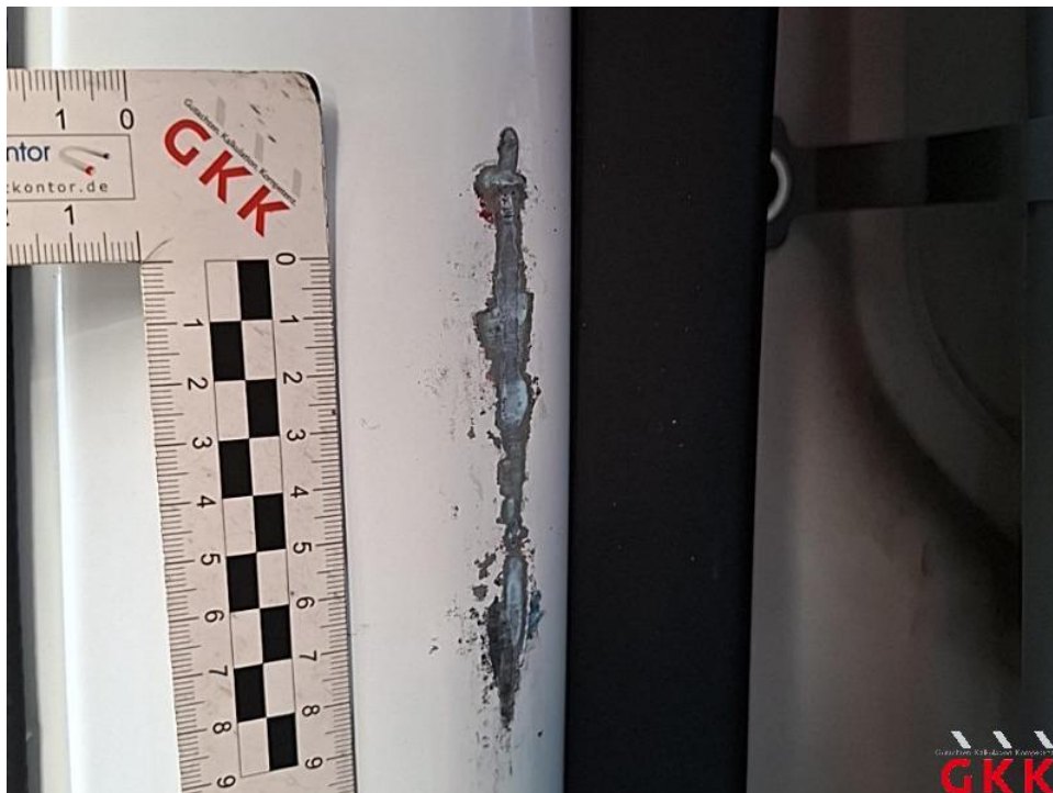
Bild 50. Laderaum, beschädigt, Smartrepair
