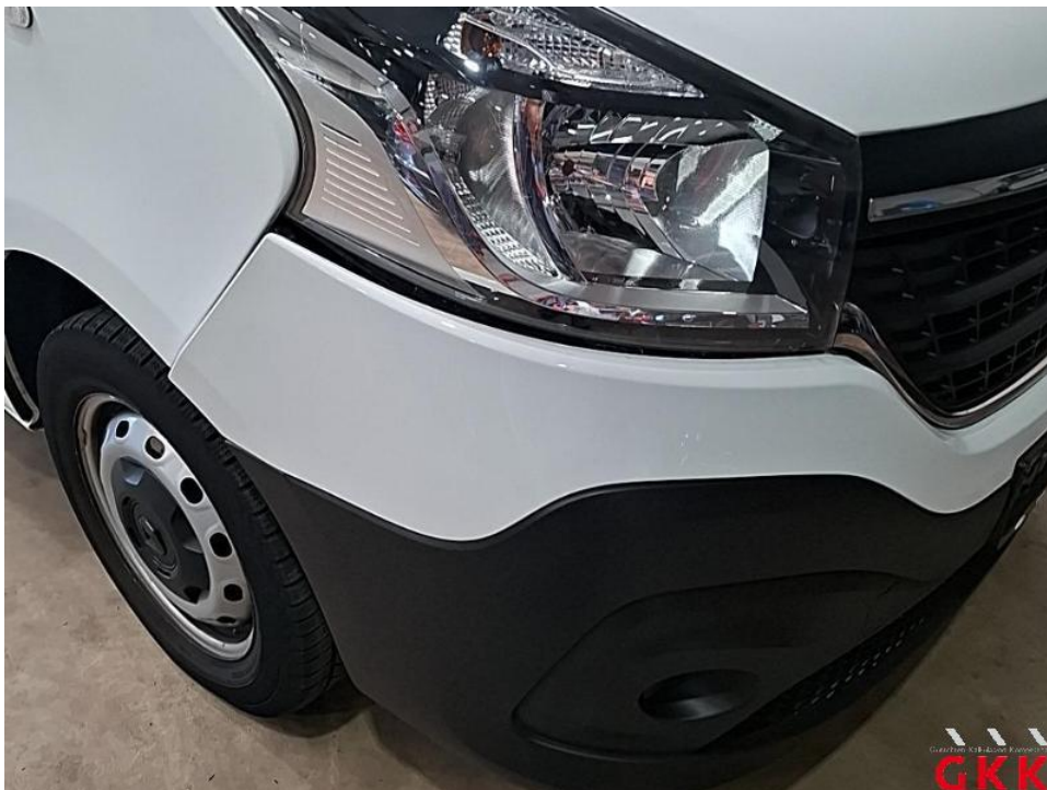
Bild 18. Stoßfänger vorne, Verkleidung -teillackiert-, Reparaturmangel, ersetzen
