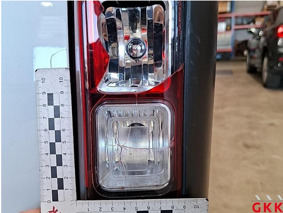
Bild 53. Rückleuchte rechts, außen, beschädigt, ersetzen
