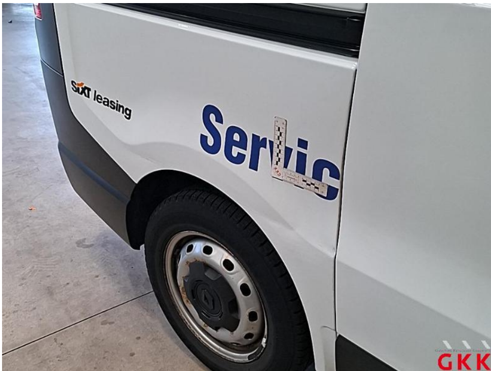
Bild 54. Seitenwand rechts, beschädigt, instand setzen - lackieren
