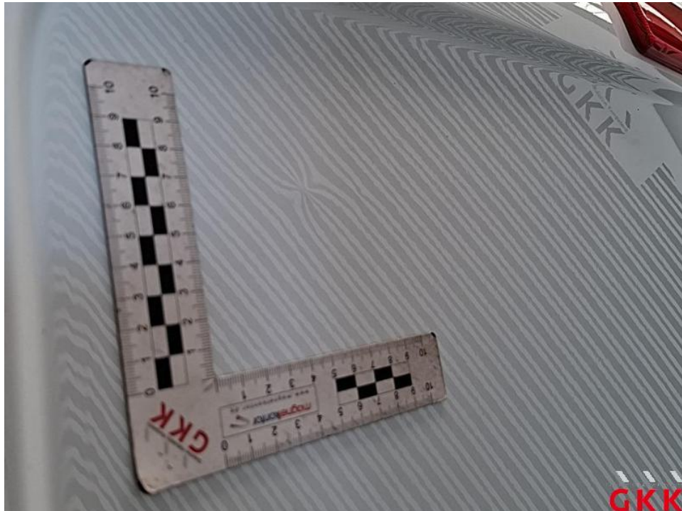
Bild 38. Hecktür links, beschädigt, instand setzen - lackieren
