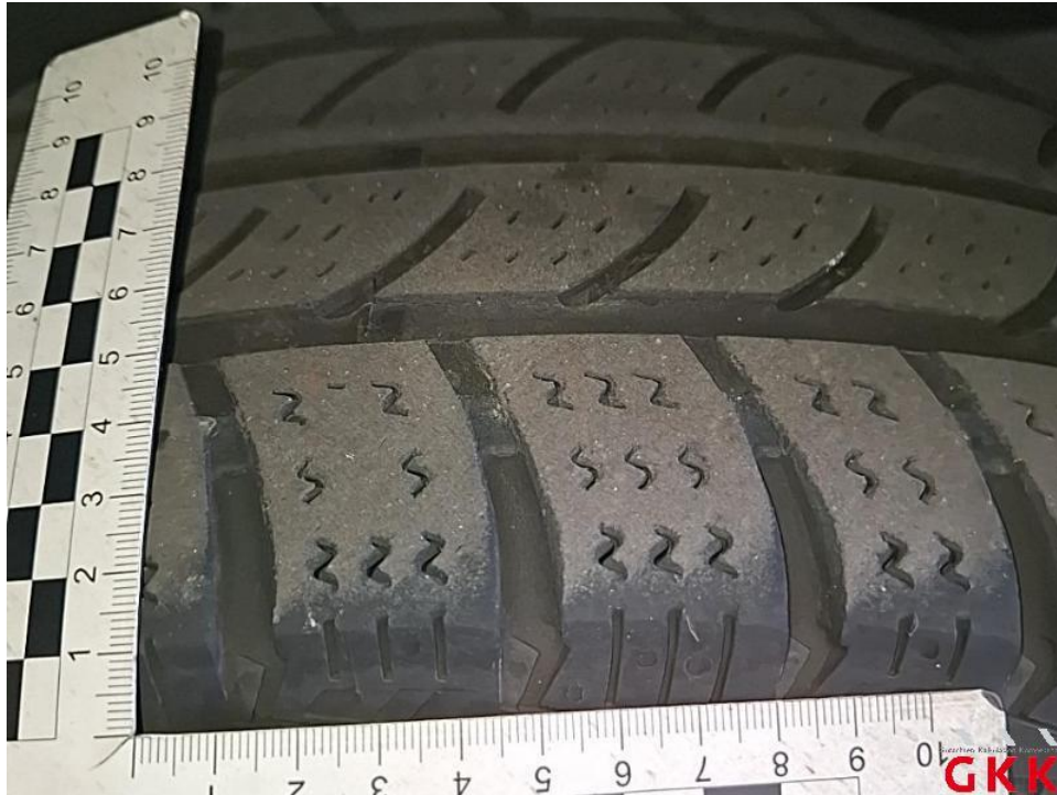
Bild 25. Reifen, vorne links, beschädigt und Untermaß, ersetzen
