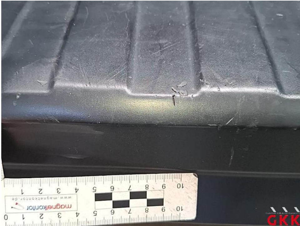
Bild 41. Stoßfänger hinten, Verkleidung -unlackiert-, beschädigt, ersetzen
