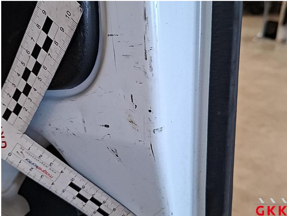
Bild 48. Hecktür rechts, innen, beschädigt, instand setzen - lackieren
