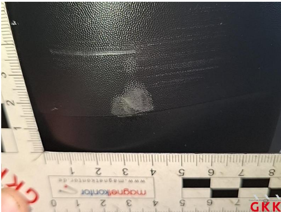
Bild 28. Spiegelgehäuse links, Kappe -unlackiert-, verkratzt, Smartrepair
