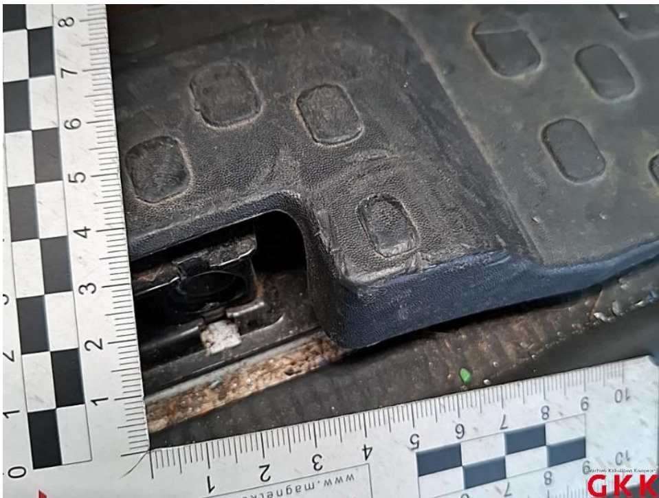
Bild 44. Ladekante, Abdeckung, beschädigt, ersetzen
