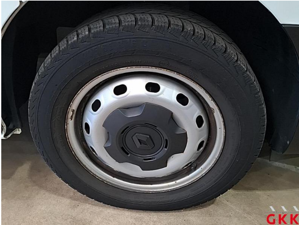
Bild 21. Reifen, vorne rechts, beschädigt und Untermaß, ersetzen
