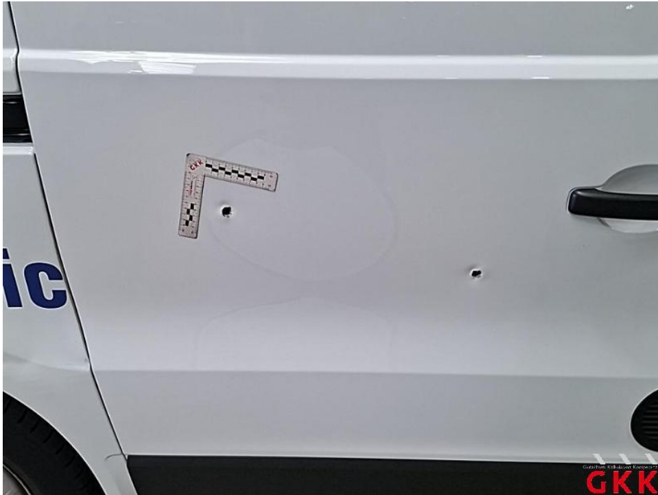
Bild 57. Schiebetür rechts, beschädigt, ersetzen
