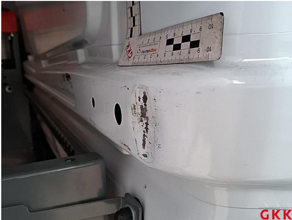
Bild 64. Trennwand, beschädigt, instand setzen - lackieren
