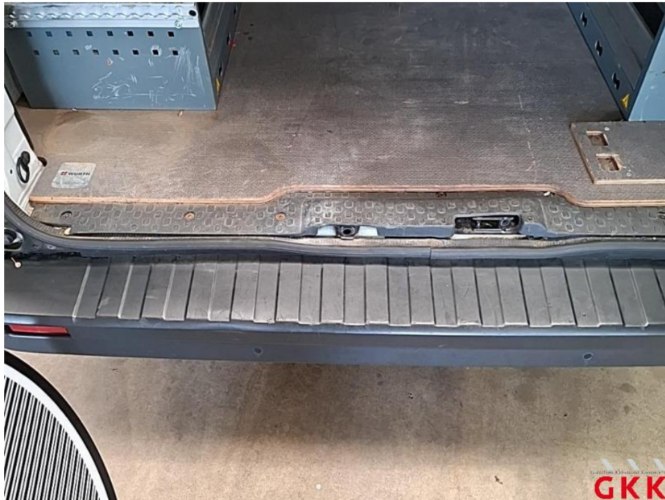
Bild 40. Stoßfänger hinten, Verkleidung -unlackiert-, beschädigt, ersetzen
