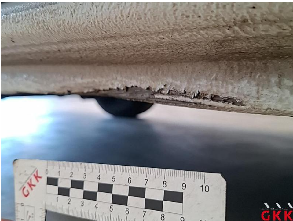
Bild 62. Schweller rechts, beschädigt, instand setzen - lackieren
