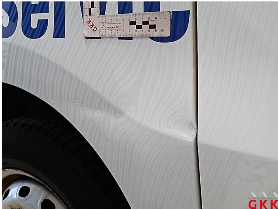
Bild 55. Seitenwand rechts, beschädigt, instand setzen - lackieren
