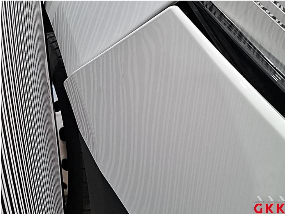
Bild 19. Stoßfänger vorne, Verkleidung -teillackiert-, Reparaturmangel, ersetzen
