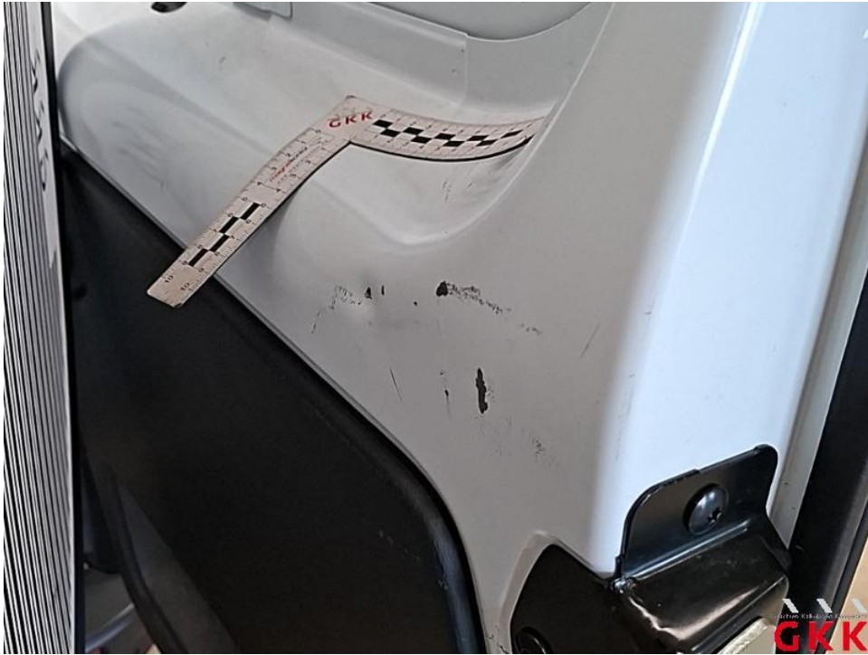
Bild 47. Hecktür rechts, innen, beschädigt, instand setzen - lackieren
