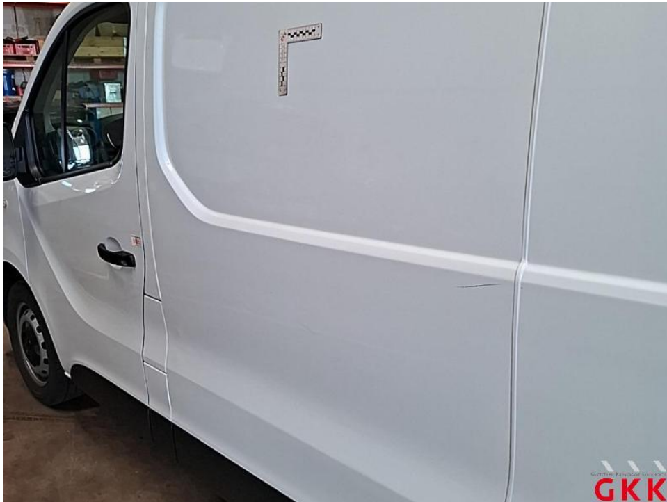
Bild 34. Seitenwand links, vorne, Reparaturmangel, instand setzen - lackieren
