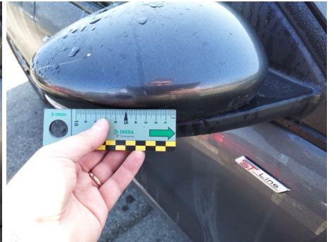
Calotta retrovisore / Destro / Riga
