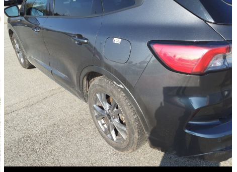
Modanatura parafrangente / Posteriore Sinistro / Ammaccato vernice incisa
