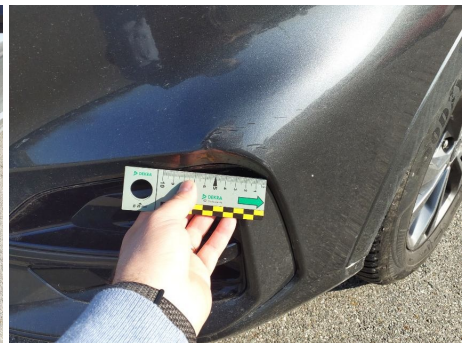
Paraurti / Anteriore / Ammaccato vernice incisa
