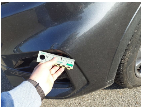
Paraurti / Anteriore / Ammaccato vernice incisa
