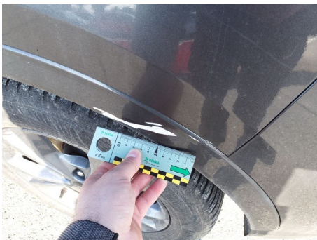
Modanatura parafrangente / Posteriore Sinistro / Ammaccato vernice incisa
