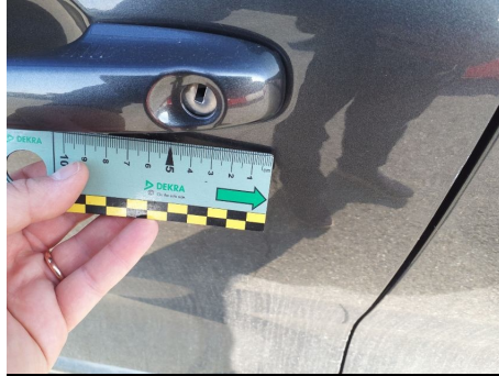
Cilindretto / Sinistro / Non conforme
