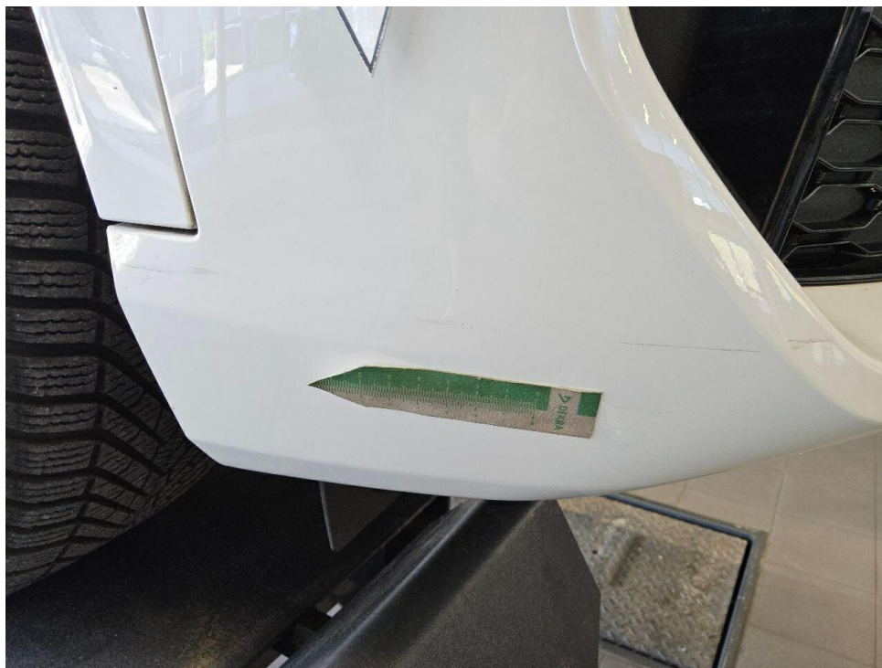
Bild 24 : Stoßfängerverkleidung vorne mehrfach verschrammt
