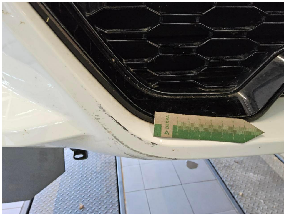
Bild 22 : Stoßfängerverkleidung vorne mehrfach verschrammt
