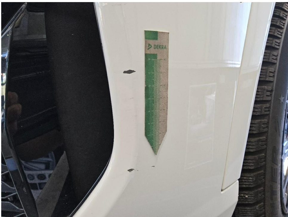
Bild 20 : Stoßfängerverkleidung vorne mehrfach verschrammt
