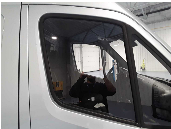
Beschädigung 49: Verglasung: Türscheibe vorn rechts - Kratzer - Wertminderung
