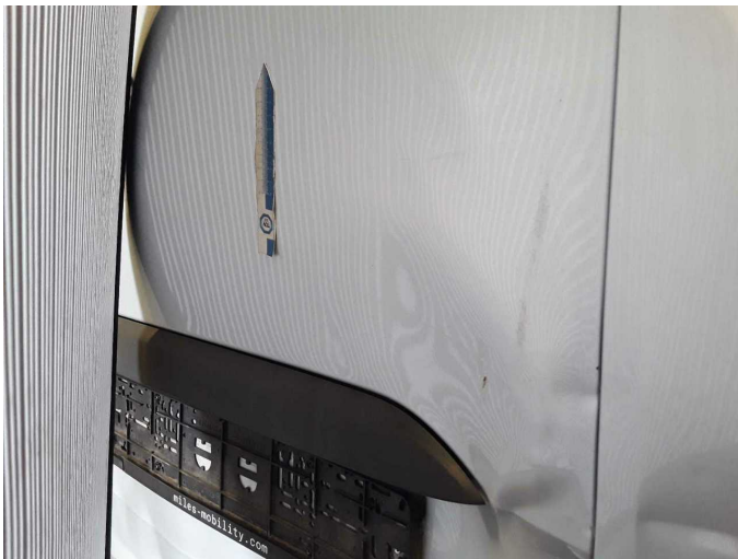
Beschädigung 25: Heckklappe/-tür: Hecktür links - verformt - erneuern
