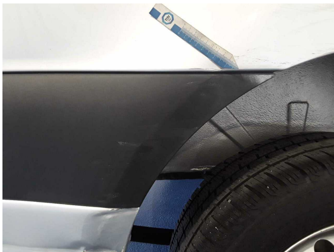
Beschädigung 32: Seitenwand rechts: Schutzleiste - beschädigt - erneuern
