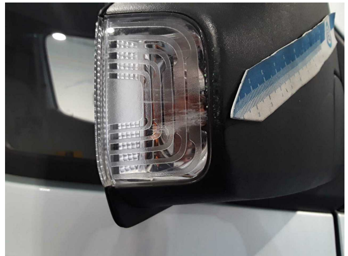
Beschädigung 39: Blinkleuchte: Spiegel rechts - beschädigt - erneuern
