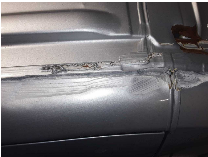
Beschädigung 48: Fahrzeugdach: Dachholm rechts - beschädigt - erneuern
