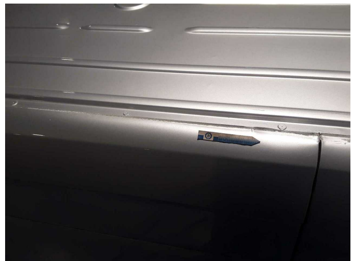
Beschädigung 45: Fahrzeugdach: Dachholm links - beschädigt - erneuern
