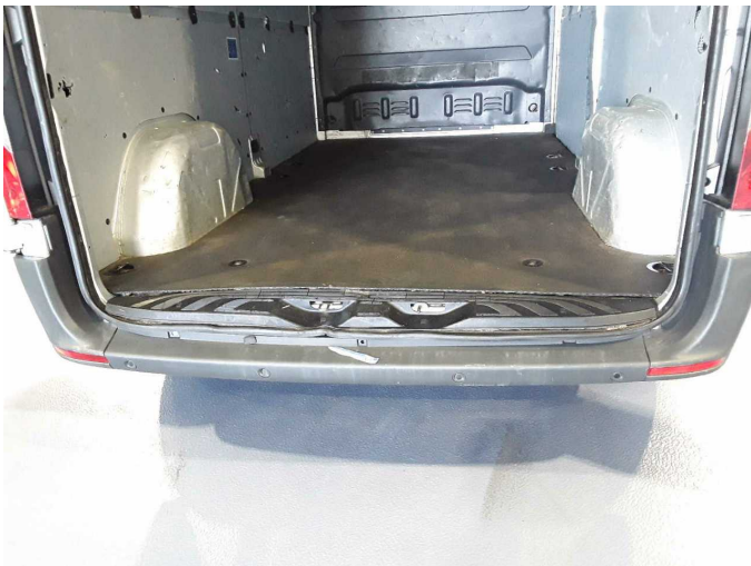
Beschädigung 13: Karosserie: Dichtung Heckdeckel /-tür - beschädigt - erneuern
