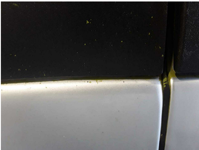
Beschädigung 16: Karosserie: Schutzleiste B-Säule links - beschädigt - erneuern
