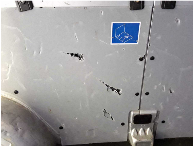
Beschädigung 2: Verkleidungen/Abdeckungen: Laderaumverkleidung links - beschädigt - erneuern
