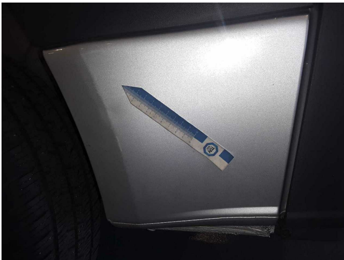
Gebrauchsspur 1: Seitenwand links: Radlauf - Delle / Lackschaden - kein Abzug
