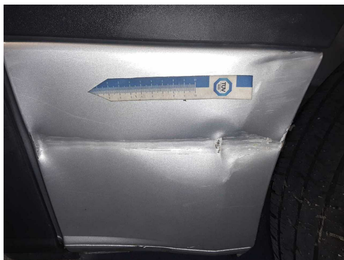
Beschädigung 31: Seitenwand rechts: Radlauf - beschädigt - erneuern
