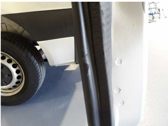
Beschädigung 9: Heckklappe/-tür: Dichtung - beschädigt - erneuern
