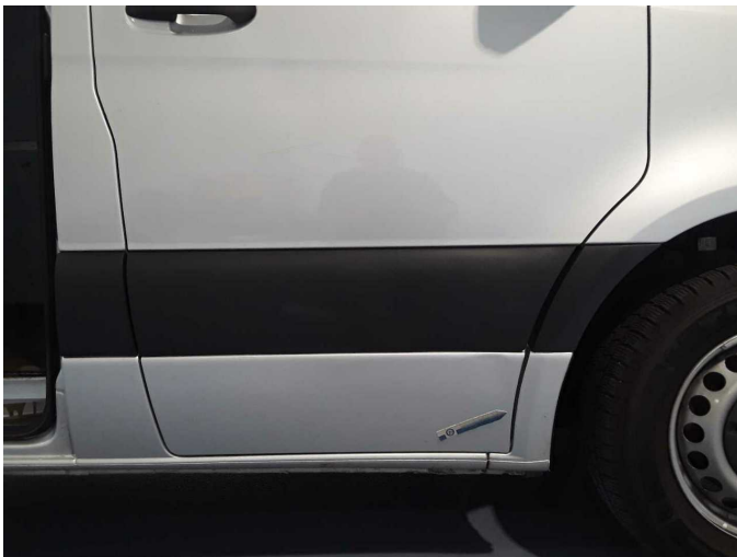
Beschädigung 38: Tür vorn rechts: Tür - Delle / Lackschaden - instandsetzen/lackieren (S3)
