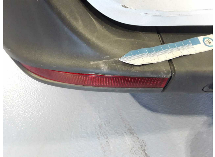
Beschädigung 27: Stossfänger hinten: Schutzleiste links - beschädigt - erneuern
