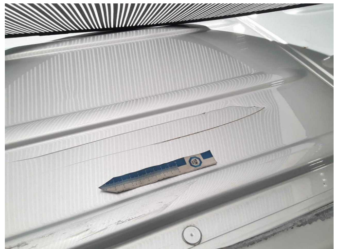
Beschädigung 46: Fahrzeugdach: Dach - Korrosion - instandsetzen/ lackieren (S3)
