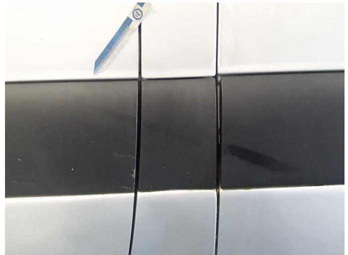
Beschädigung 16: Karosserie: Schutzleiste B-Säule links - beschädigt - erneuern
