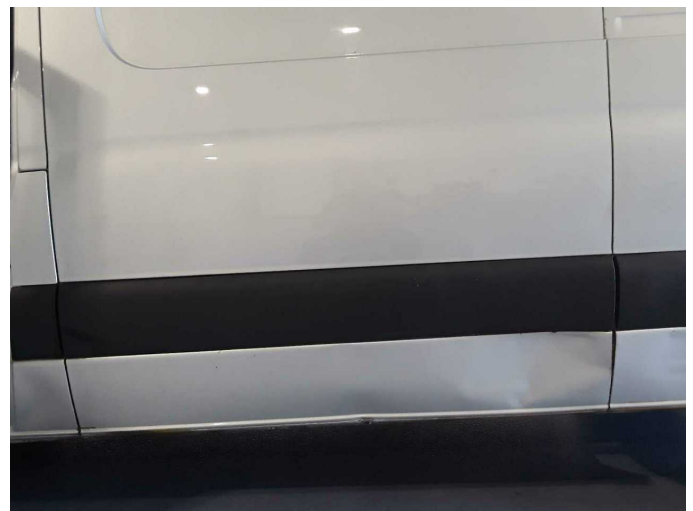
Beschädigung 17: Seitenwand links: Schutzleiste - verformt - erneuern
