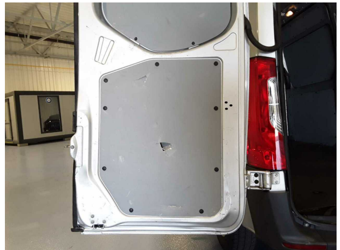
Beschädigung 8: Heckklappe/-tür: Verkl. Hecktür Sperrholz unten - beschädigt - erneuern
