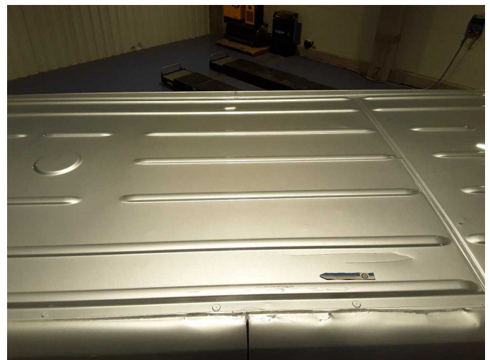
Beschädigung 46: Fahrzeugdach: Dach - Korrosion - instandsetzen/ lackieren (S3)
