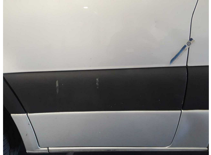
Beschädigung 15: Tür vorn links: Zierleiste unten - beschädigt - erneuern
