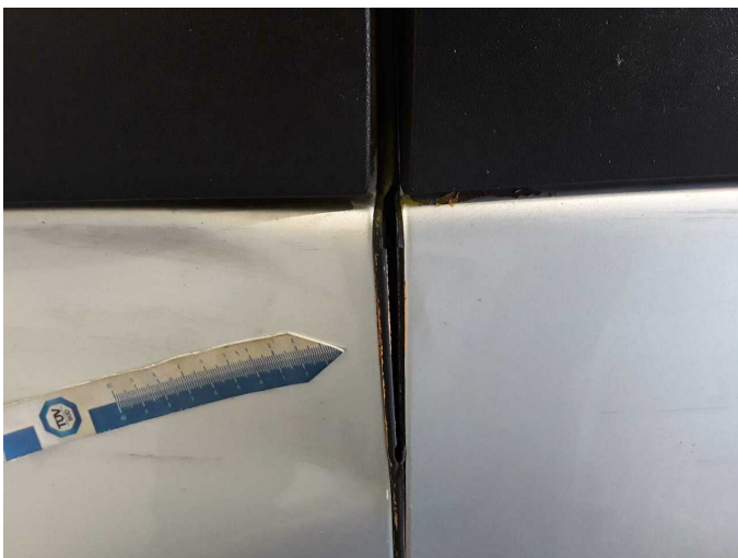
Beschädigung 19: Schweller links: Schweller - verformt - erneuern
