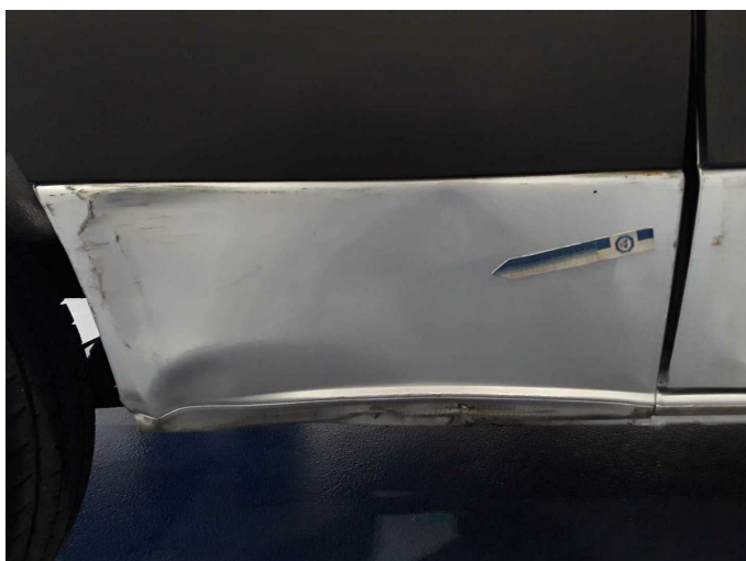
Beschädigung 33: Schweller rechts: Schweller - verformt - erneuern
