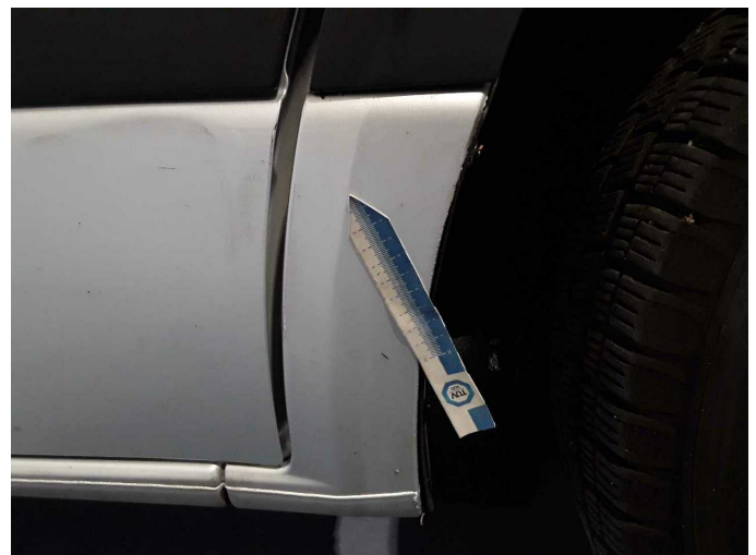
Beschädigung 40: Schweller rechts: Verkleidung - verkratzt / verschürft - lackieren
