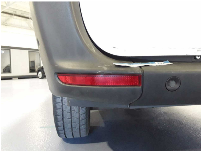
Beschädigung 27: Stossfänger hinten: Schutzleiste links - beschädigt - erneuern
