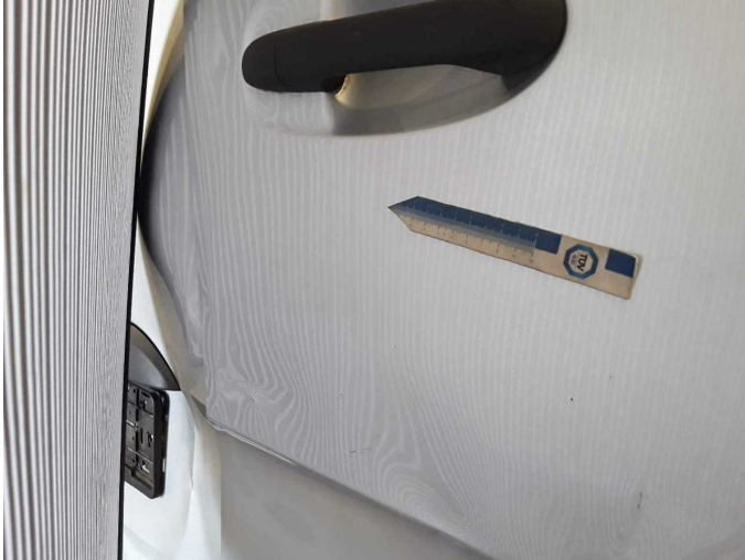
Beschädigung 26: Heckklappe/-tür: Hecktür rechts - verformt - erneuern
