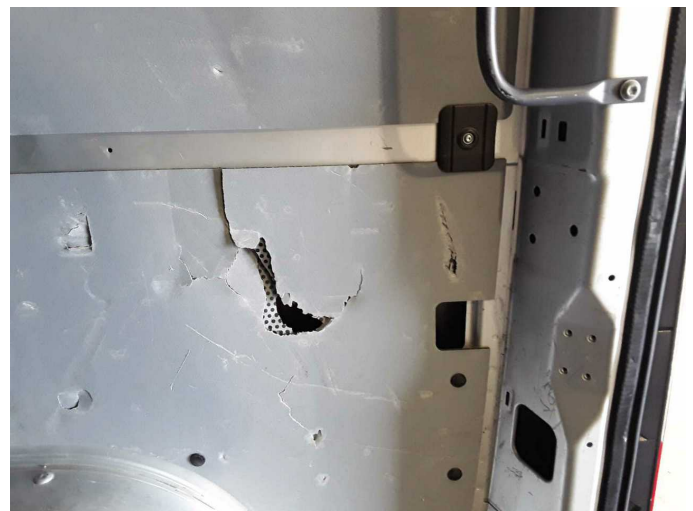
Beschädigung 3: Verkleidungen/Abdeckungen: Laderaumverkleidung rechts - beschädigt - erneuern
