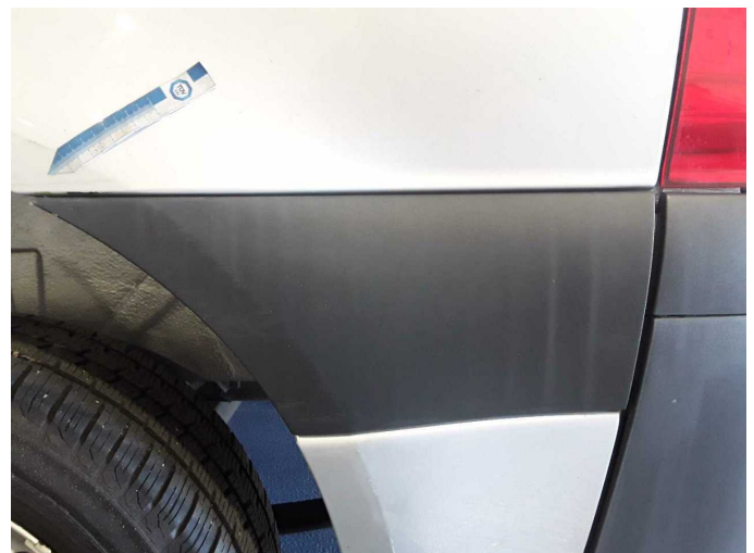
Beschädigung 23: Seitenwand links: Schutzleiste - beschädigt - erneuern
