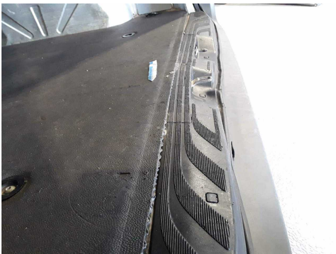
Beschädigung 12: Interieur: Laderaumboden (Schiene) - fehlt - erneuern
