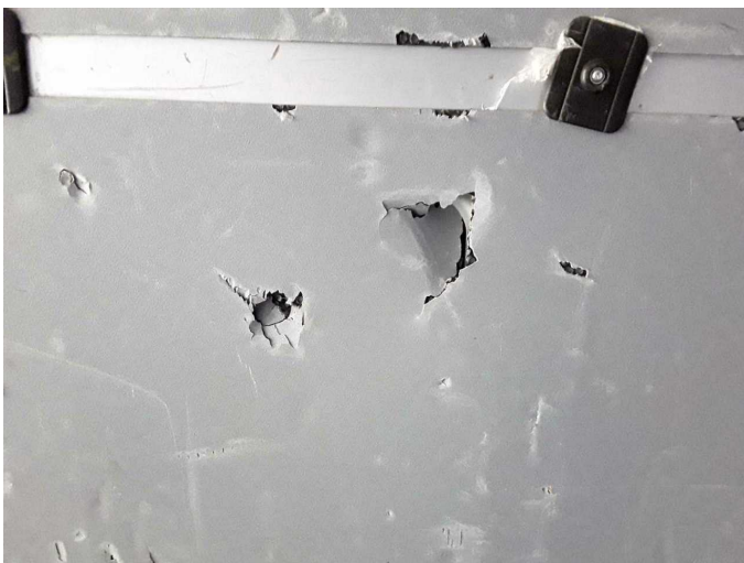
Beschädigung 2: Verkleidungen/Abdeckungen: Laderaumverkleidung links - beschädigt - erneuern
