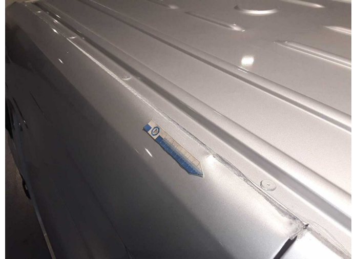
Beschädigung 45: Fahrzeugdach: Dachholm links - beschädigt - erneuern
