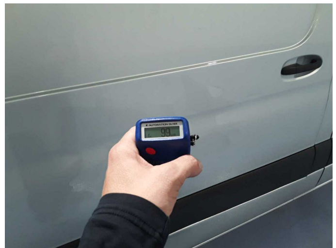
Tür hinten rechts: 99 μm
