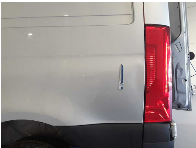
Beschädigung 20: Seitenwand links: Seitenwand - Delle / Lackschaden - instandsetzen/lackieren (S3)
