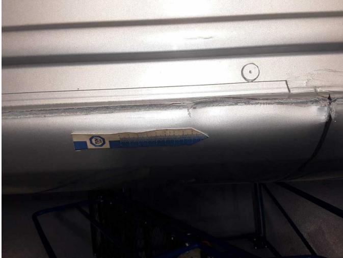
Beschädigung 45: Fahrzeugdach: Dachholm links - beschädigt - erneuern
