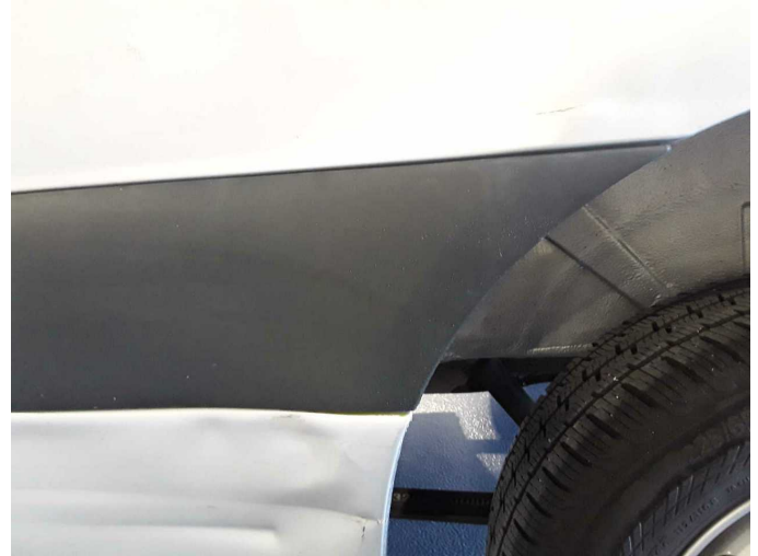
Beschädigung 24: Seitenwand links: Schutzleiste - beschädigt - erneuern
