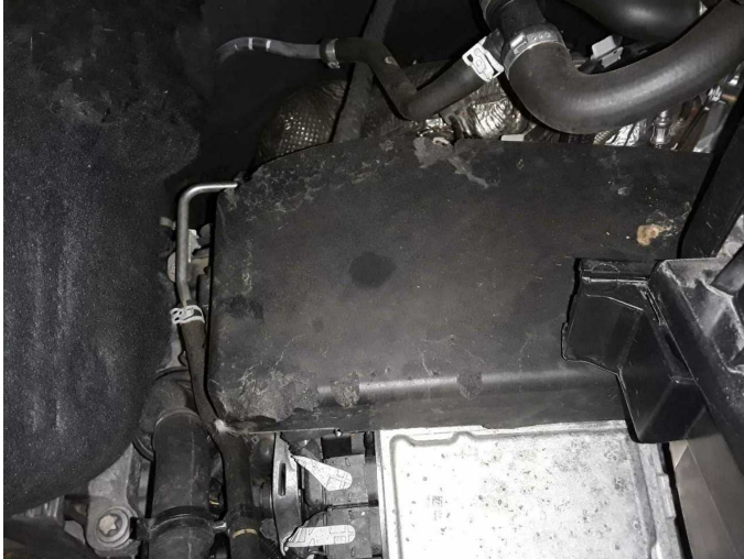
Beschädigung 43: Motor: Motorabdeckung - beschädigt - erneuern
