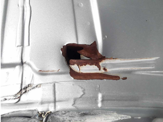
Beschädigung 47: Fahrzeugdach: Dach (Schadenserweiterung möglich kein Temporärer schutz) - Löcher - erneuern
