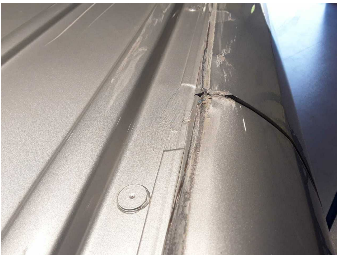
Beschädigung 45: Fahrzeugdach: Dachholm links - beschädigt - erneuern
