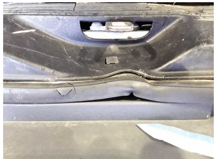
Beschädigung 13: Karosserie: Dichtung Heckdeckel /-tür - beschädigt - erneuern
