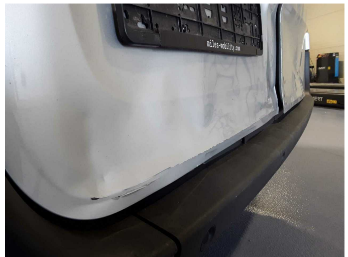
Beschädigung 25: Heckklappe/-tür: Hecktür links - verformt - erneuern
