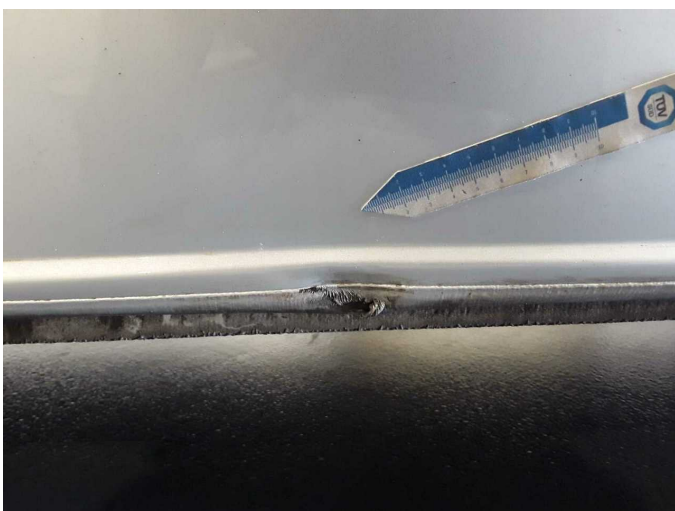
Beschädigung 19: Schweller links: Schweller - verformt - erneuern
