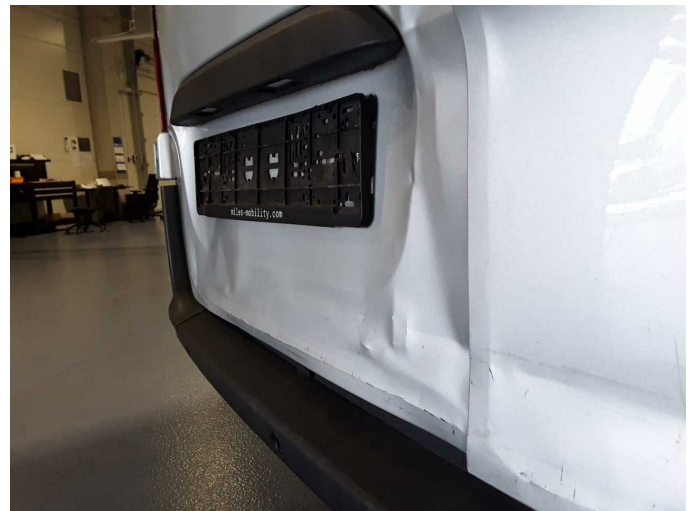
Beschädigung 25: Heckklappe/-tür: Hecktür links - verformt - erneuern
