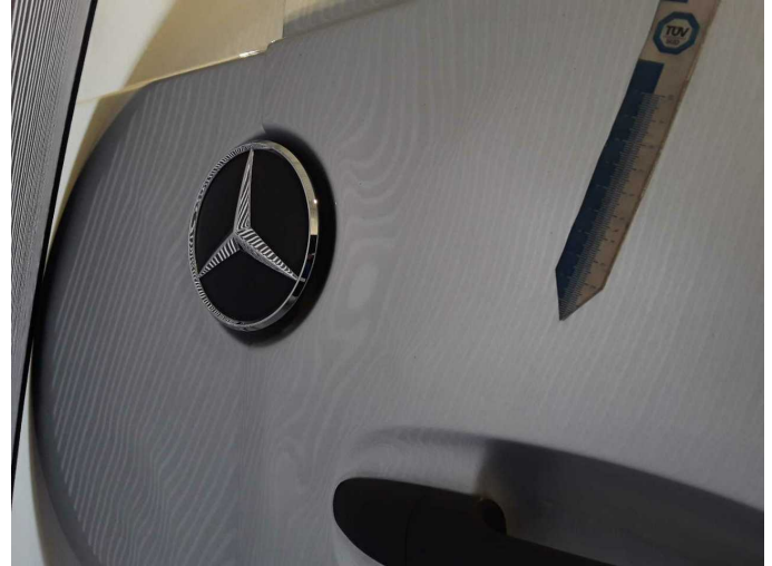
Beschädigung 26: Heckklappe/-tür: Hecktür rechts - verformt - erneuern
