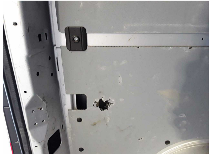
Beschädigung 2: Verkleidungen/Abdeckungen: Laderaumverkleidung links - beschädigt - erneuern
