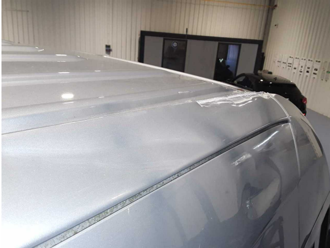
Beschädigung 48: Fahrzeugdach: Dachholm rechts - beschädigt - erneuern
