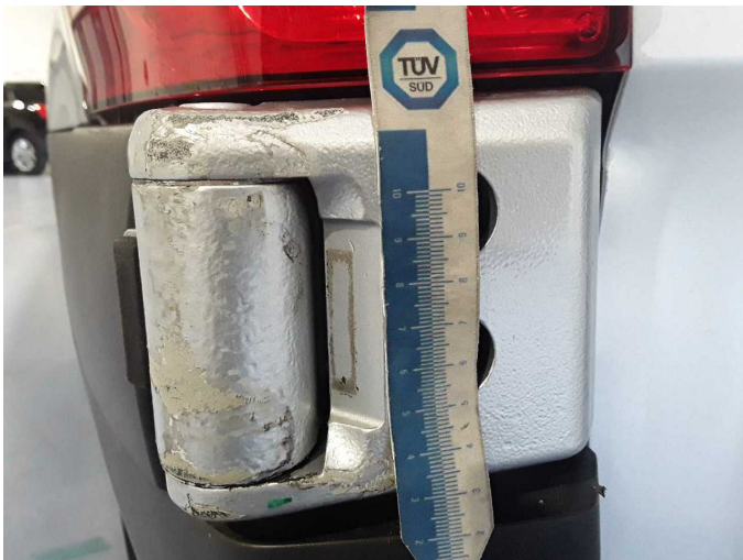
Beschädigung 22: Heckklappe/-tür: Scharnier - verkratzt / verschürft - lackieren
