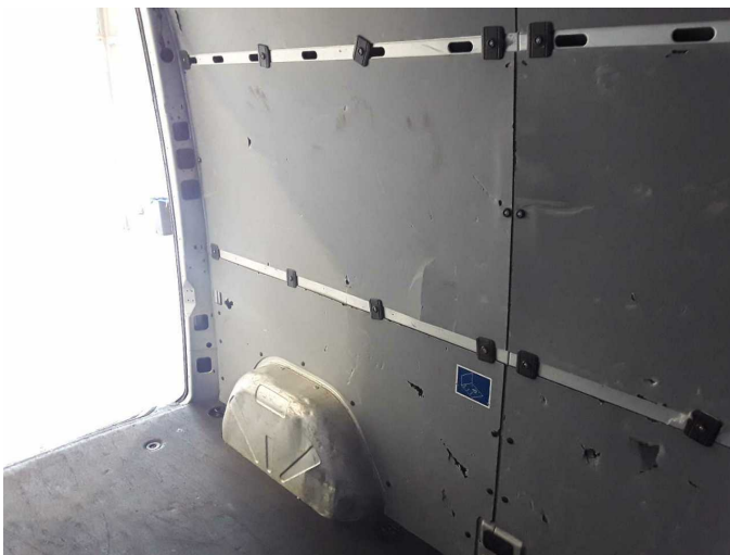
Beschädigung 2: Verkleidungen/Abdeckungen: Laderaumverkleidung links - beschädigt - erneuern
