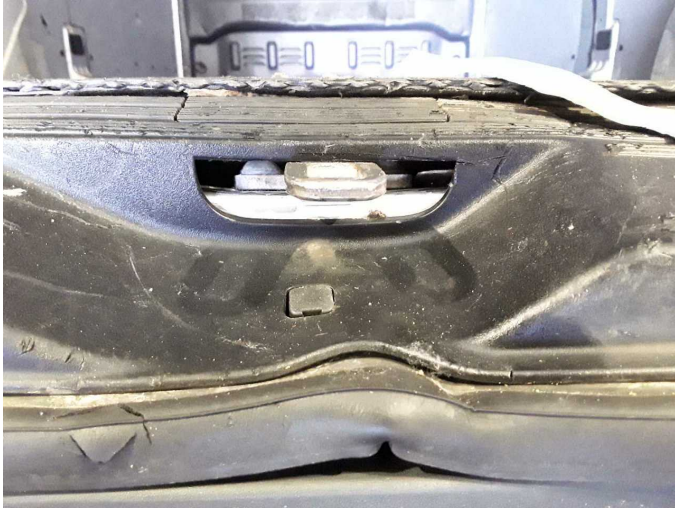
Beschädigung 10: Verkleidungen/Abdeckungen: Kofferraumverkleidung - beschädigt - erneuern
