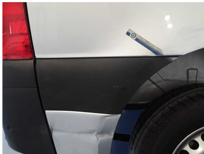
Beschädigung 32: Seitenwand rechts: Schutzleiste - beschädigt - erneuern
