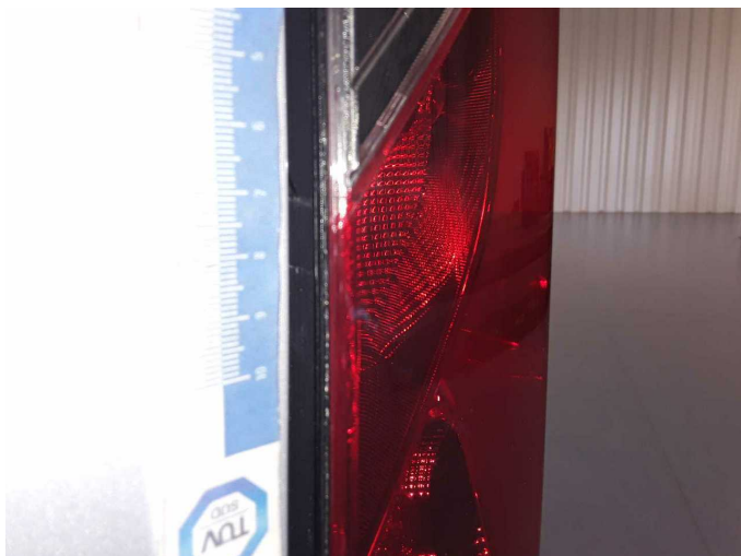
Beschädigung 30: Heckleuchte: Heckleuchte rechts (Beschädigt) - lose - erneuern
