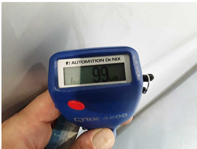
Tür hinten rechts: 99 μm
