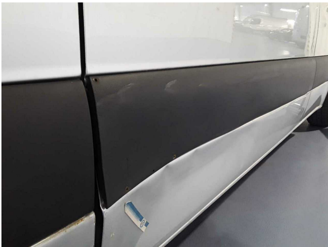
Beschädigung 36: Schiebetür rechts: Schutzleiste - beschädigt - erneuern
