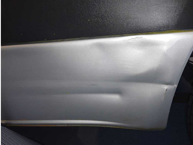
Beschädigung 19: Schweller links: Schweller - verformt - erneuern
