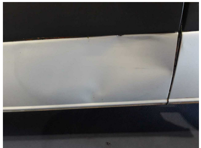
Beschädigung 19: Schweller links: Schweller - verformt - erneuern
