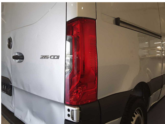
Beschädigung 30: Heckleuchte: Heckleuchte rechts (Beschädigt) - lose - erneuern
