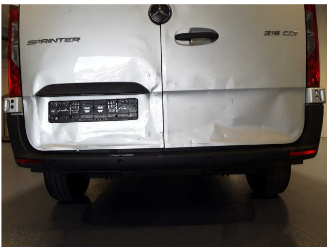
Beschädigung 28: Stossfänger hinten: Stossfänger hinten (unlackiert) - lose - erneuern
