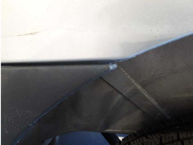
Beschädigung 24: Seitenwand links: Schutzleiste - beschädigt - erneuern
