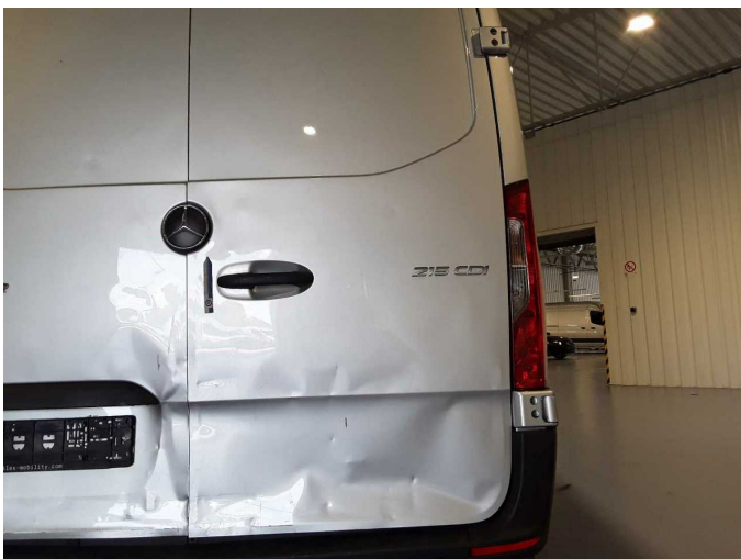
Beschädigung 26: Heckklappe/-tür: Hecktür rechts - verformt - erneuern
