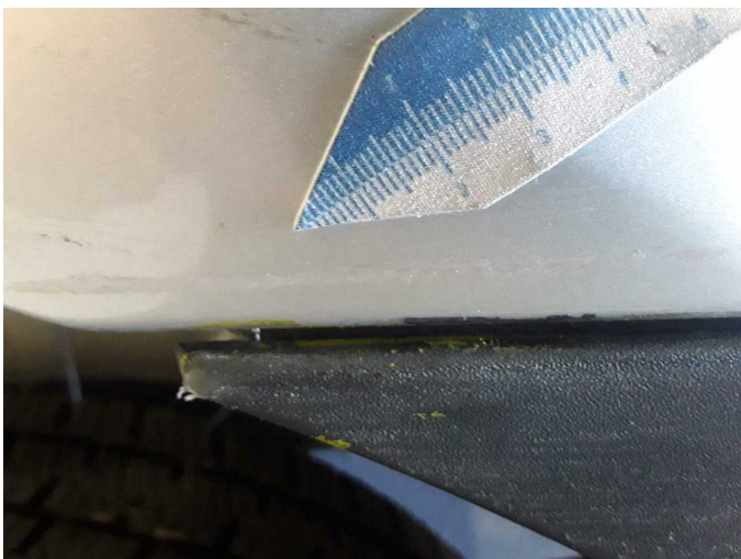
Beschädigung 23: Seitenwand links: Schutzleiste - beschädigt - erneuern
