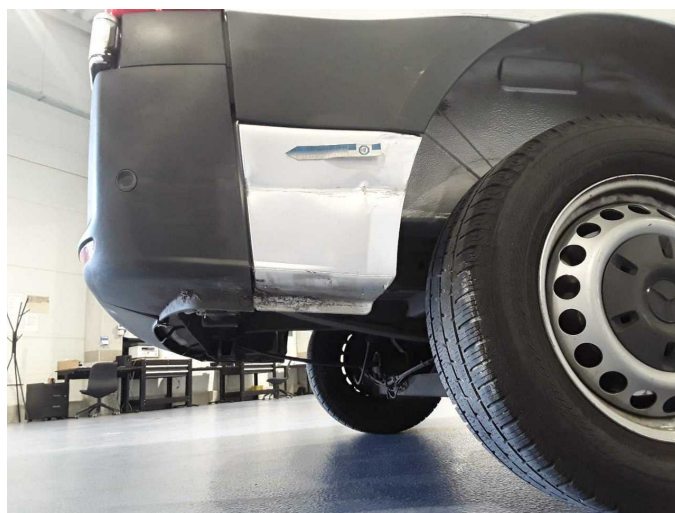
Beschädigung 31: Seitenwand rechts: Radlauf - beschädigt - erneuern
