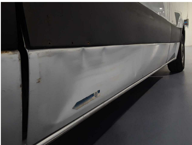
Beschädigung 35: Schiebetür rechts: Schiebetür - verformt - erneuern
