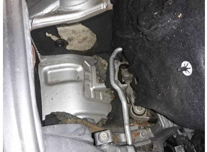
Beschädigung 44: Motor: Motorverkleidung unten - beschädigt - erneuern
