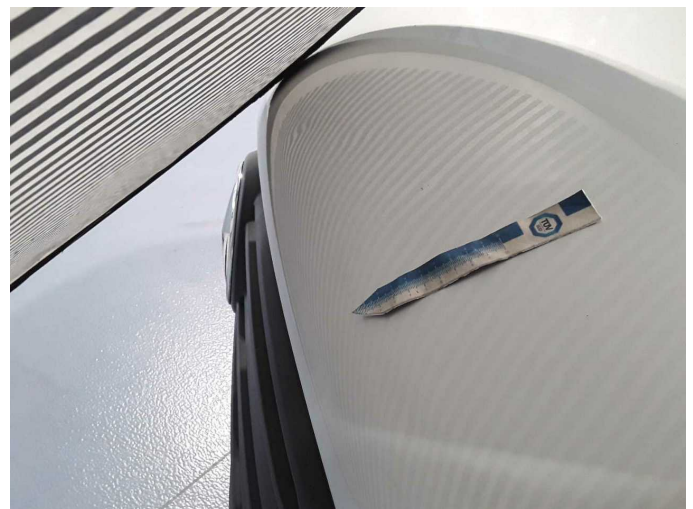
Beschädigung 50: Motorhaube: Motorhaube - Delle(n) - sanft instandsetzen
