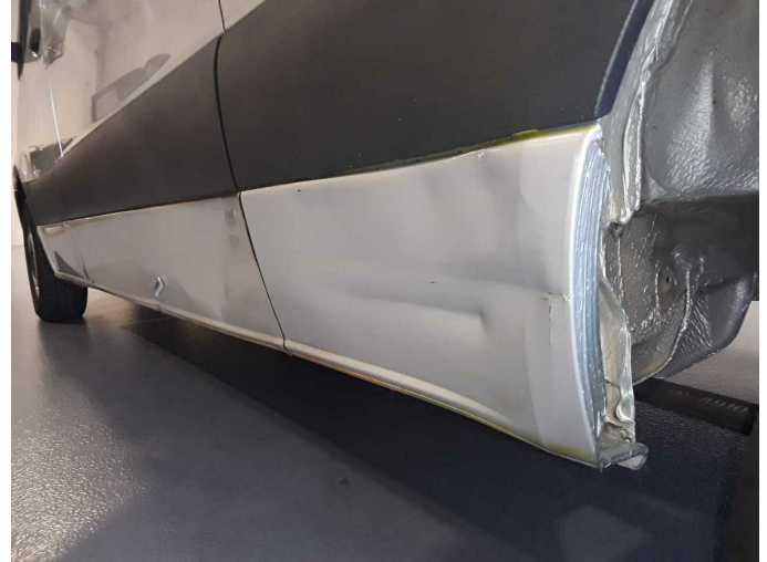
Beschädigung 19: Schweller links: Schweller - verformt - erneuern
