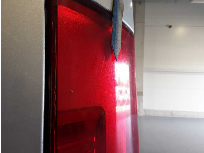
Beschädigung 21: Heckleuchte: Heckleuchte links - beschädigt - erneuern
