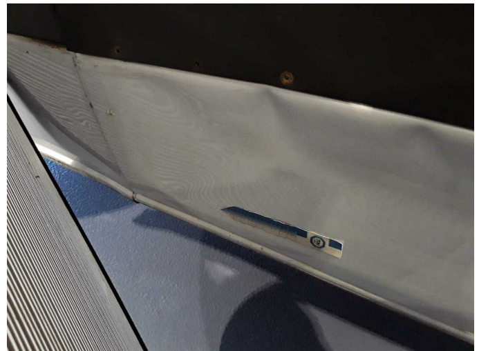
Beschädigung 35: Schiebetür rechts: Schiebetür - verformt - erneuern
