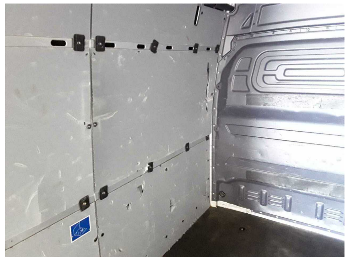
Beschädigung 2: Verkleidungen/Abdeckungen: Laderaumverkleidung links - beschädigt - erneuern
