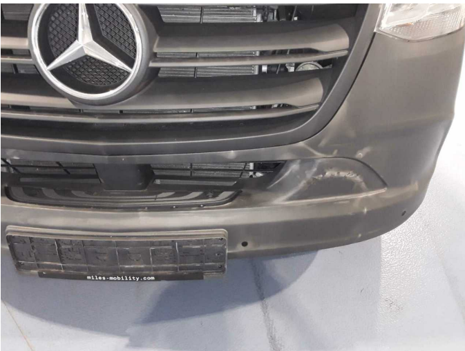
Beschädigung 41: Stossfänger vorn: Stossfänger vorn (unlackiert) - beschädigt - erneuern
