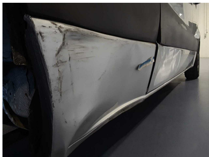
Beschädigung 33: Schweller rechts: Schweller - verformt - erneuern
