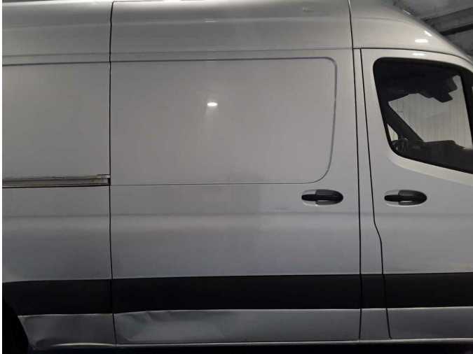
Beschädigung 35: Schiebetür rechts: Schiebetür - verformt - erneuern
