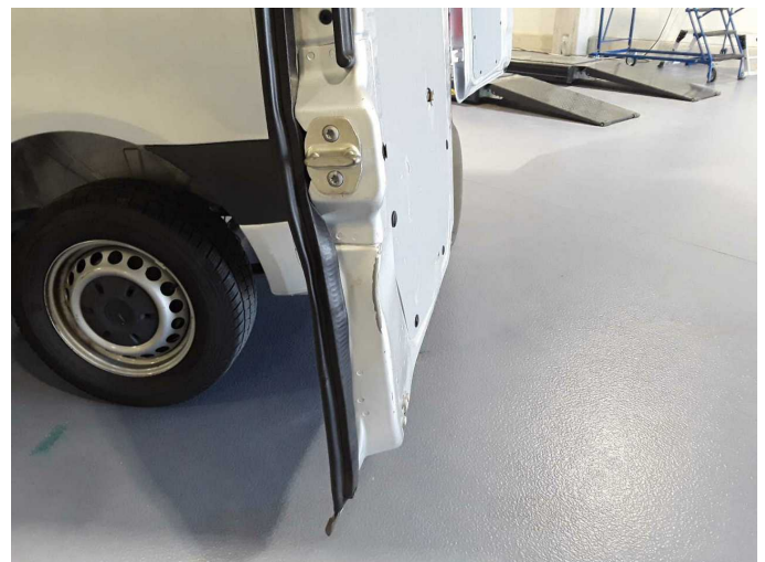
Beschädigung 9: Heckklappe/-tür: Dichtung - beschädigt - erneuern
