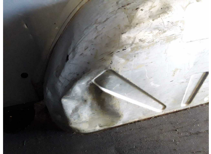
Beschädigung 4: Karosserie: Radhaus hinten rechts - Delle / Lackschaden - instandsetzen/lackieren (S3)
