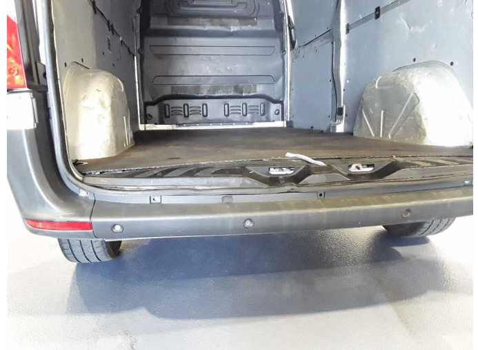
Beschädigung 10: Verkleidungen/Abdeckungen: Kofferraumverkleidung - beschädigt - erneuern
