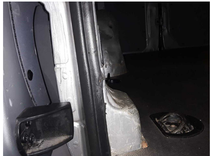
Beschädigung 37: Schiebetür rechts: Türdichtung - beschädigt - erneuern
