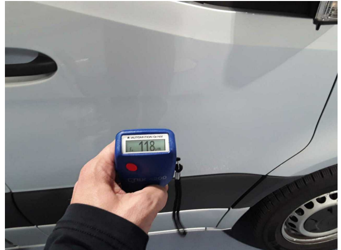
Tür vorne rechts: 128 \mu\text{m}
