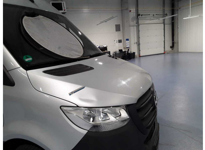
Beschädigung 50: Motorhaube: Motorhaube - Delle(n) - sanft instandsetzen
