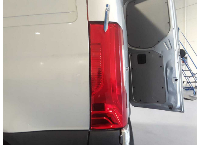
Beschädigung 21: Heckleuchte: Heckleuchte links - beschädigt - erneuern
