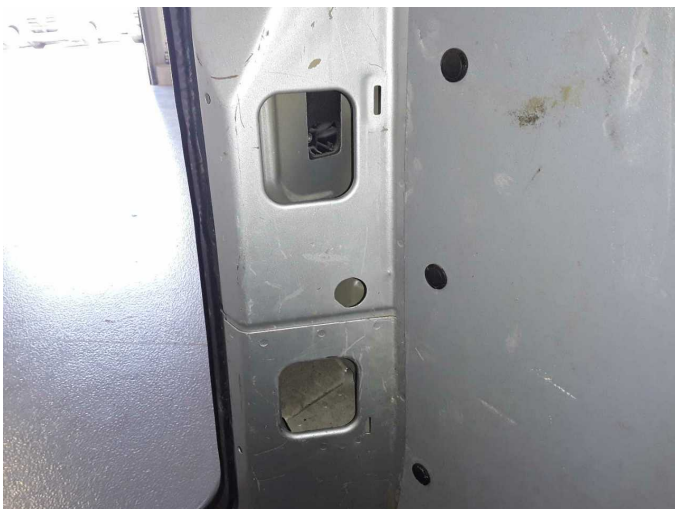
Beschädigung 6: Verkleidungen/Abdeckungen: D-Säule links Verkleidung innen - fehlt - erneuern
