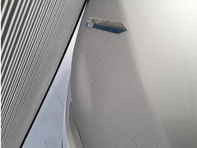
Beschädigung 50: Motorhaube: Motorhaube - Delle(n) - sanft instandsetzen
