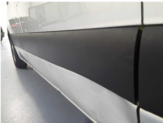
Beschädigung 17: Seitenwand links: Schutzleiste - verformt - erneuern
