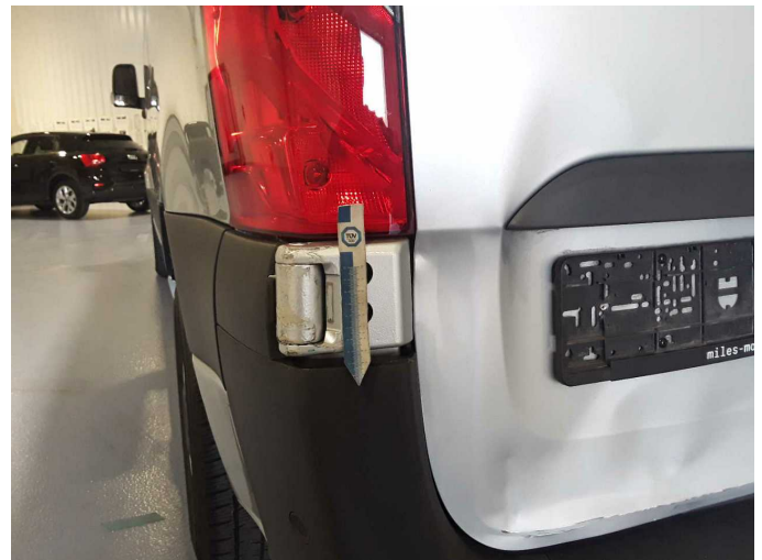
Beschädigung 22: Heckklappe/-tür: Scharnier - verkratzt / verschürft - lackieren
