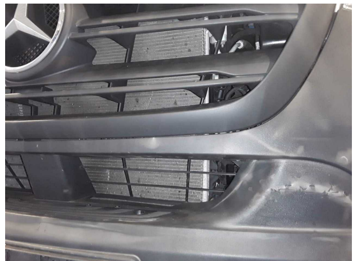
Beschädigung 42: Frontmaske: Grill (Clips) - gebrochen / gerissen - instandsetzen
