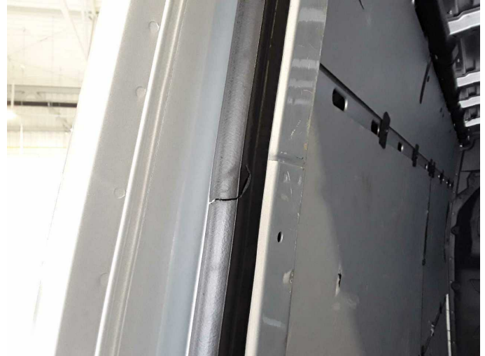
Beschädigung 13: Karosserie: Dichtung Heckdeckel /-tür - beschädigt - erneuern
