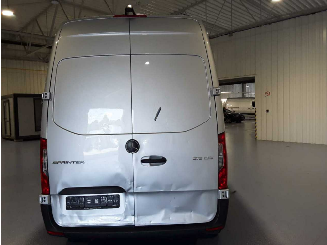
Beschädigung 26: Heckklappe/-tür: Hecktür rechts - verformt - erneuern
