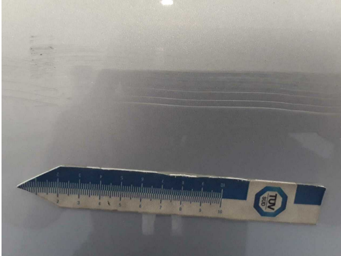
Beschädigung 34: Seitenwand rechts: Seitenwand - Delle / Lackschaden - instandsetzen/lackieren (S3)
