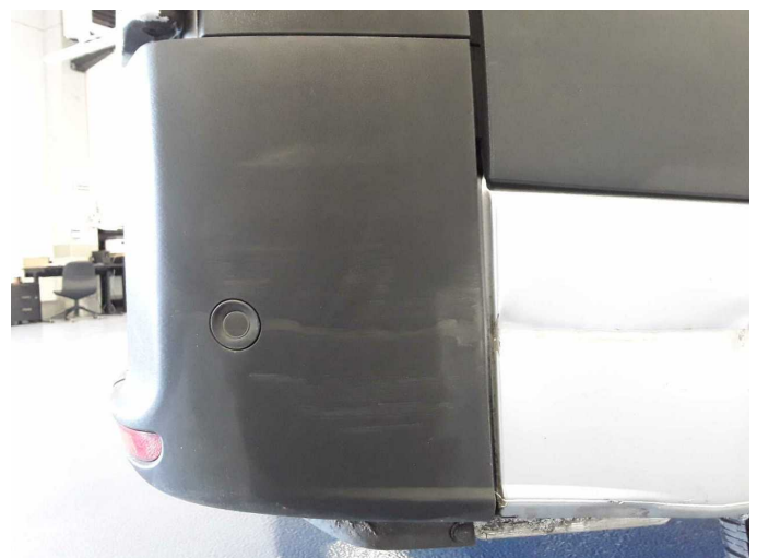
Beschädigung 29: Stossfänger hinten: Schutzleiste rechts - beschädigt - erneuern
